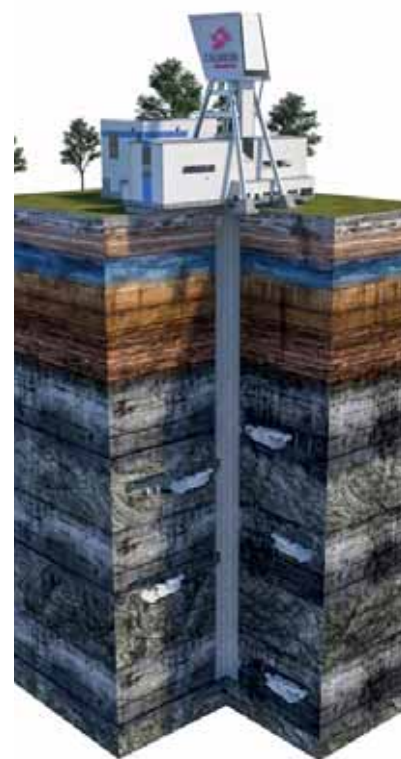
Głębokość szybu to 870 m, a średnica to 7,5 m
