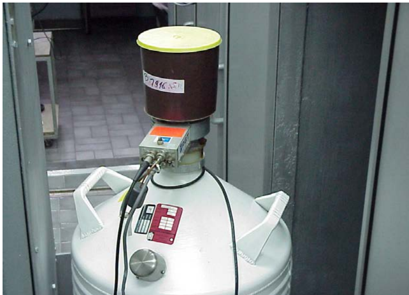
Fot. 2. Detektor półprzewodnikowy z próbką na stanowisku pomiarowym
