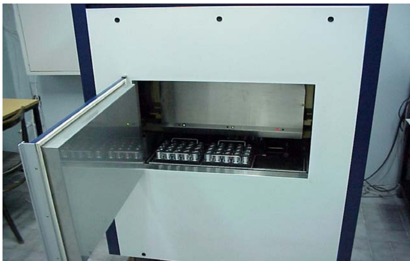
Fot. 1. Pomiar próbki radowych z wykorzystaniem niskotłowego licznika ciekłoscyntylacyjnego Quantulus
