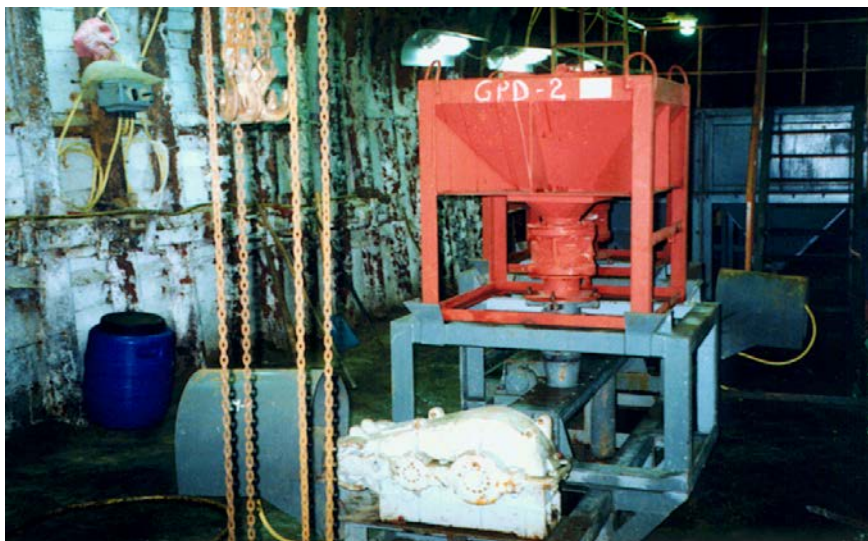
Fot. 4. Dozownik sorbentu RA2 w czasie pracy w kopalni „Piast”
