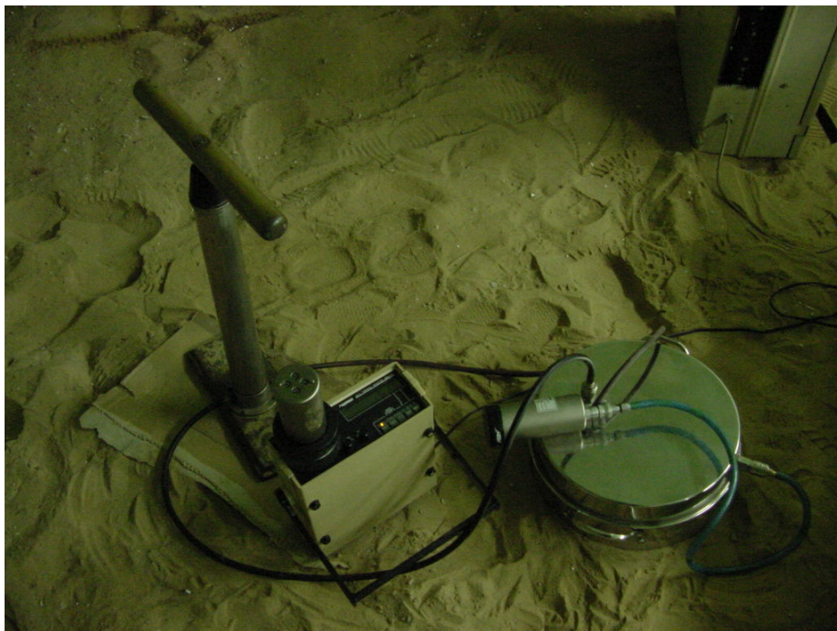
Fot. 5. Przyrząd do pomiaru radonu PYLON (z komorą Lucasa) oraz pomiar ekshalacji radonu z gleby wewnątrz komory radonowej
