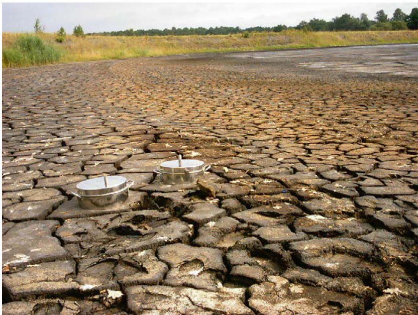
Fot. 6. Dno opróżnionego osadnika kopalnianego – badania ekshalacji radonu
