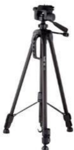
Przykład taniego statywu TreQ Tri-14 ze zintegrowaną głowicą, oraz wewnętrznymi rozpórkami. Statyw taki zazwyczaj ma duże luzy osiowe, nie ma też możliwości niezależnej regulacji kąta wychylenia nóg, ani ich rozłożenia do pozycji bliskiej poziomej, całość zaś nie zapewnia właściwej stabilizacji dla zdjęć na długich czasach otwarcia migawki.
