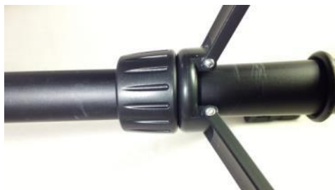
Przykład taniego statywu TreQ Tri-14 ze zintegrowaną głowicą, oraz wewnętrznymi rozpórkami. Statyw taki zazwyczaj ma duże luzy osiowe, nie ma też możliwości niezależnej regulacji kąta wychylenia nóg, ani ich rozłożenia do pozycji bliskiej poziomej, całość zaś nie zapewnia właściwej stabilizacji dla zdjęć na długich czasach otwarcia migawki.
