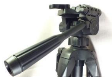
Przykład taniego statywu TreQ Tri-14 ze zintegrowaną głowicą, oraz wewnętrznymi rozpórkami. Statyw taki zazwyczaj ma duże luzy osiowe, nie ma też możliwości niezależnej regulacji kąta wychylenia nóg, ani ich rozłożenia do pozycji bliskiej poziomej, całość zaś nie zapewnia właściwej stabilizacji dla zdjęć na długich czasach otwarcia migawki.
