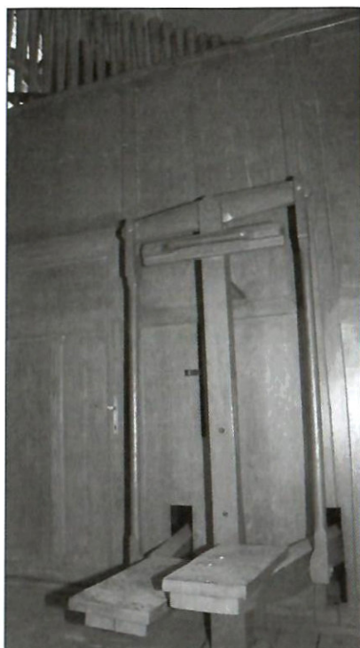
Gdyby zabrakło prądu, organy mogą zostać uruchomione mechanicznie przy użyciu napędu nożnego, tylko skąd wziąć doświadczonego kalikanta?, 2010.
