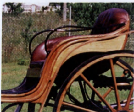
rys 1a ławki – siedzenia wkomponowane w karoserię pojazdu
