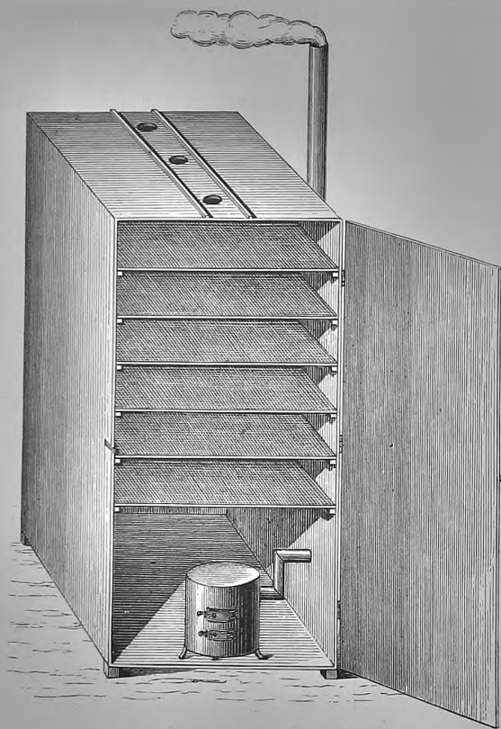
Apparat zum Trocknen gebeizter Blumen.
