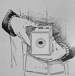
Wie der »Kodak« bei der Aufnahme gehandhabt wird.
