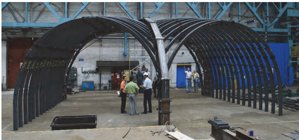
Fot. 6.1. Konstrukcja obudowy odgałęzienia przekopu kierunkowego pod pokładem 510, poziom 774 m z przekopem odstawczym 774/585 w trakcie próbnego montażu u producenta
