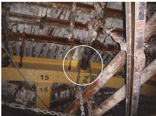
Fot. 4.7. Połączenie elementu rozporowego z portalem
