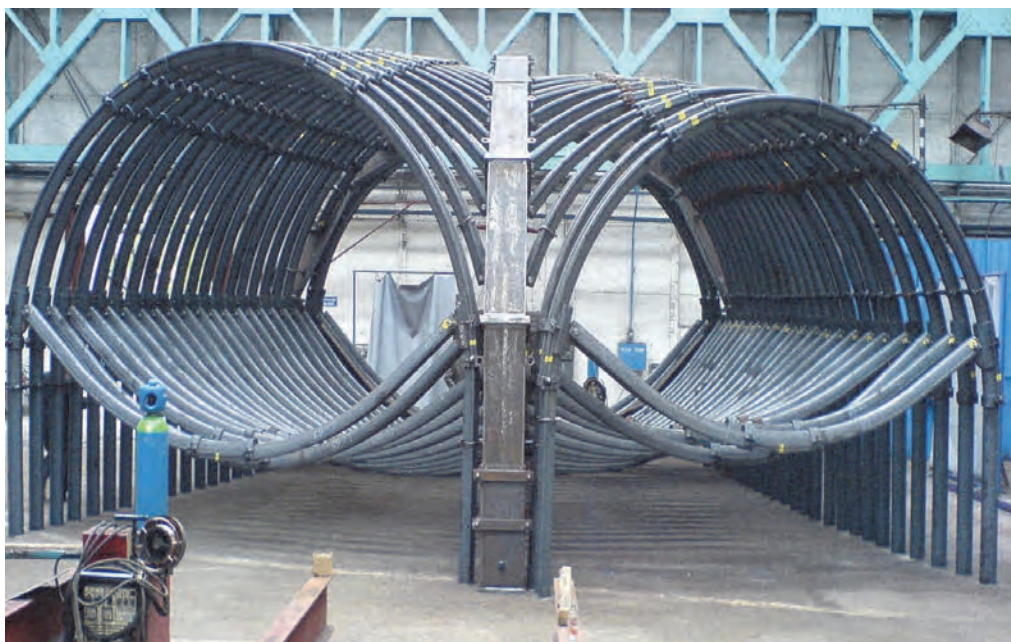
Fot. 6.10. Obudowa odgałęzienia R52 w trakcie próbnego montażu; dla przeprowadzenia próbnego montażu spągnice są podniesione w stosunku do planowanego usytuowania w wyrobisku
