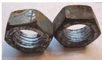
Fot. 5.7. Uszkodzone nakrętki – widoczny ścięty gwint
