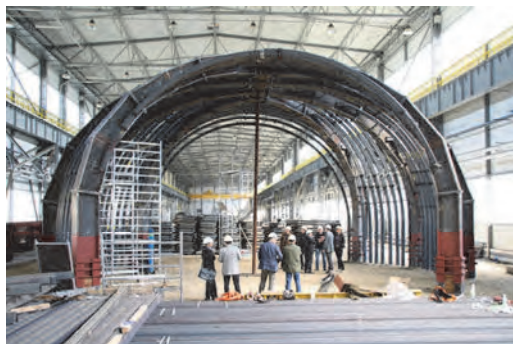
Fot. 6.14. Konstrukcja zmontowana próbnie u producenta
