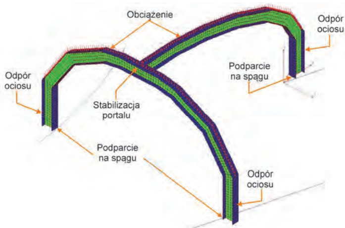
Rys. 5.14. Sposób podparcia i obciążenia modelu obudowy odgałęzienia
