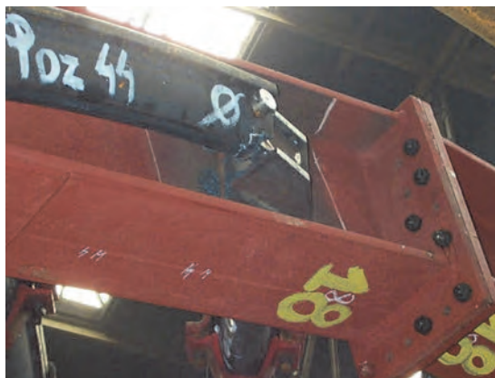
Fot. 4.3. Specjalne ucho do mocowania odrzwi do belki pod ostrym kątem
