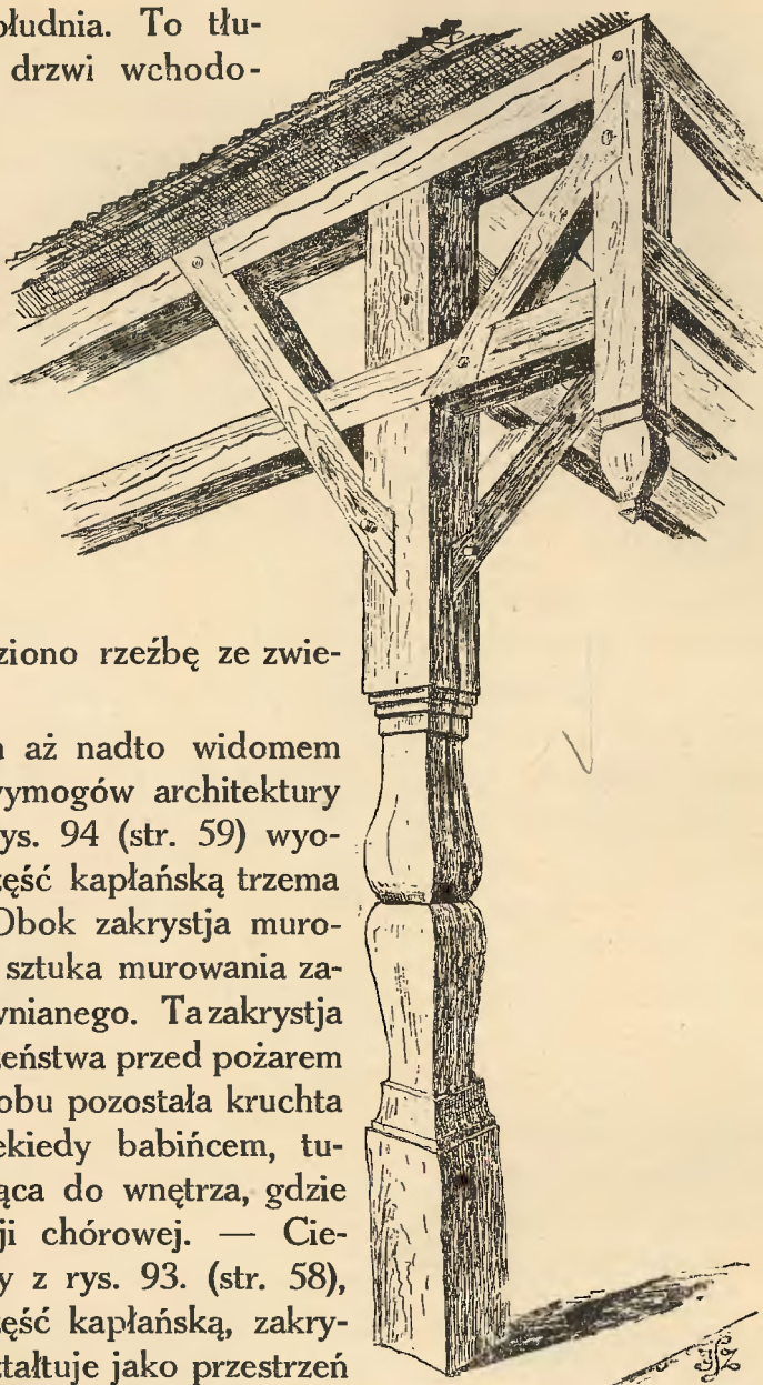
Rys. 100. Słup narożny z podcienia głębokiego w Zakliczynie nad Dunajcem. — Słupek wiszący należy do okapu nadwieszonego.
