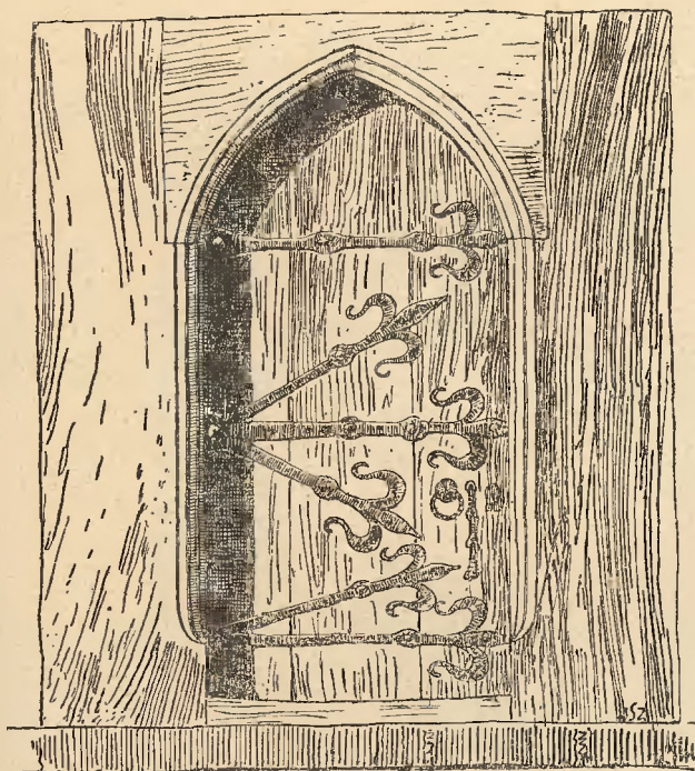
Rys. 116. Węgry drzewiane ze skrzydłem drzewianym, okutem na zawiasy polskie. (Z kruchty kościoła drewnianego w Biesiadkach koło Dębicy).
