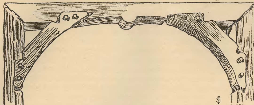
Rys. 201. Nadproże bramy „n a k o z y” związane z węgarami pionowymi. Rozsoszki po dwa kołki mają. (Rys. Józef Smoliński).
