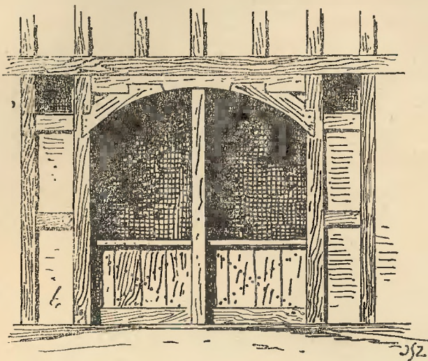
Rys. 138. Brama „dwudzielna“ ze słupem, do odejmowania, w osi głównej. Słup ten śrzedzina, zwie się także pawrotem.
