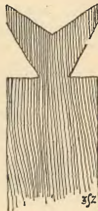
Rys. 146. Gąt prosto linijnie wycięty na zasadzie „dwudziału“ (bramka kościelna w Skomielnej).
