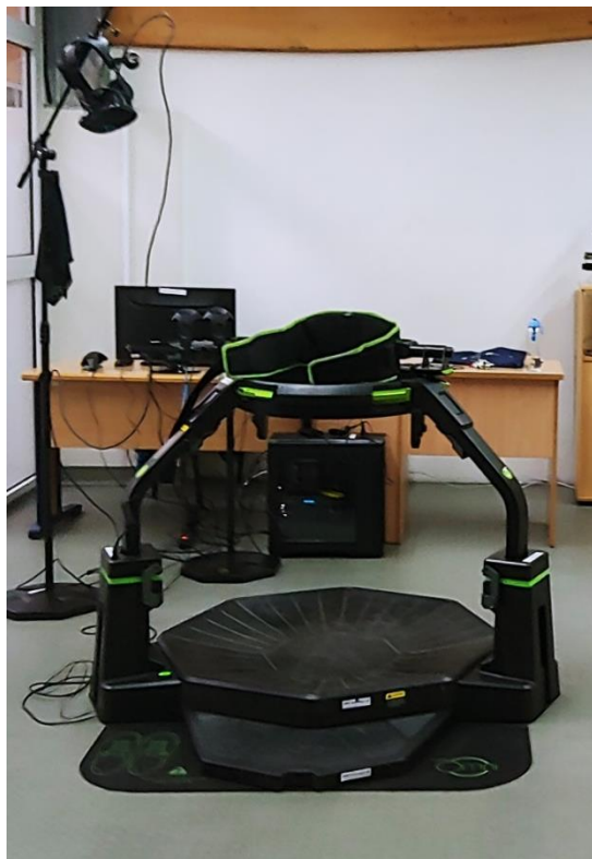
Ryc. 1. Wielokierunkowa bieżnia Omni do poruszania się w zanurzeniowej wirtualnej rzeczywistości
