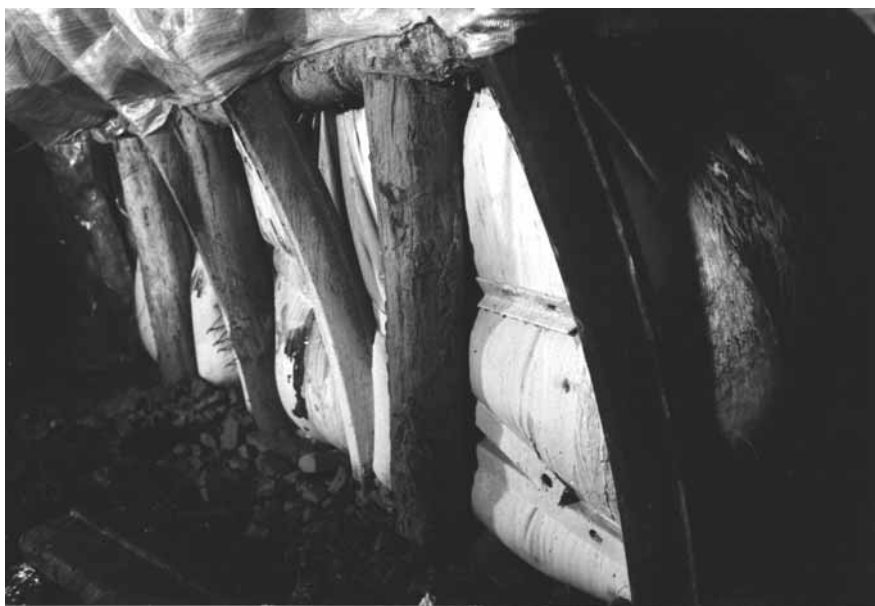
Rys. 2.23. Pas ochronny ze spoiwa Tekblend w kopalni „Katowice-Kleofas”
