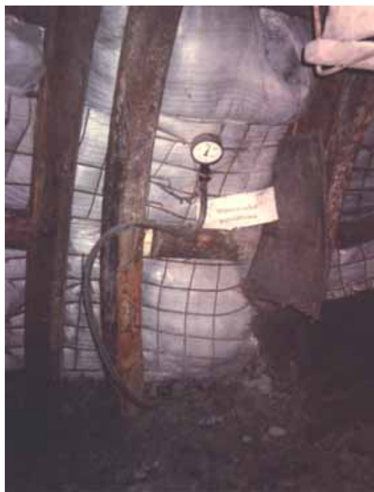
Rys. 3.3 Stanowisko pomiarowe w pasie ochronnym ze spoiwa UTEX-15 w kopalni „Rydułtowy”
