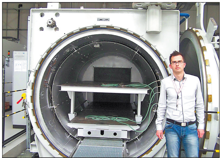
Bartłomiej Płonka przed otwartym autoklawem, w którym za kilka miesięcy utwardzane będą próbné panele kompozytowe do budowy statków kosmicznych.
