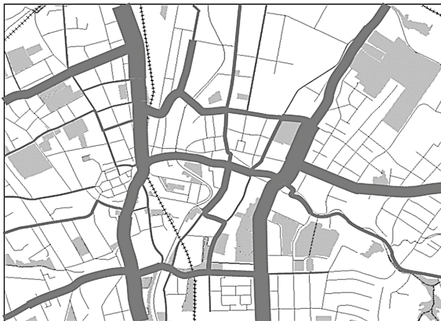
Rysunek 30. Rozkład potoków ruchu w sieci drogowej w centrum Bielska-Białej – efekt użycia modelu symulacyjnego Źródło: Opracowanie własne.
