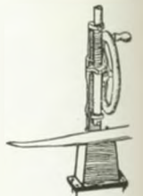
Dengelmaschine zum Hämern des Sensenblattes
