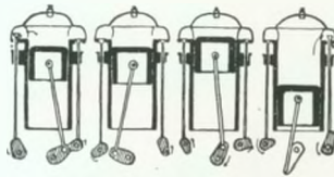
Viertakt-Verbrennungsmotor Anzug-, Kompressions-, Explosions- und Auspuffstellung
