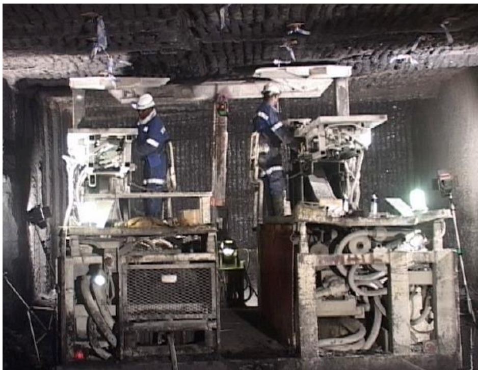
Fot. 3.5. Kotwienie w przodku w kopalni węgla kamiennego w RPA [119]
