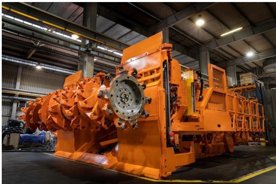
Fot. 4.2. Kombajn JOY 12CM30 w zakładzie Joy Global w Tychach – głowica urabiająca
