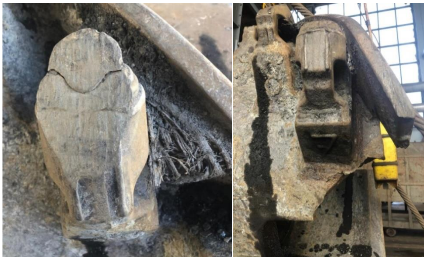
Fot. 8.1. Widok uszkodzonych wrębników organu urabiającego kombajnu 12CM30
