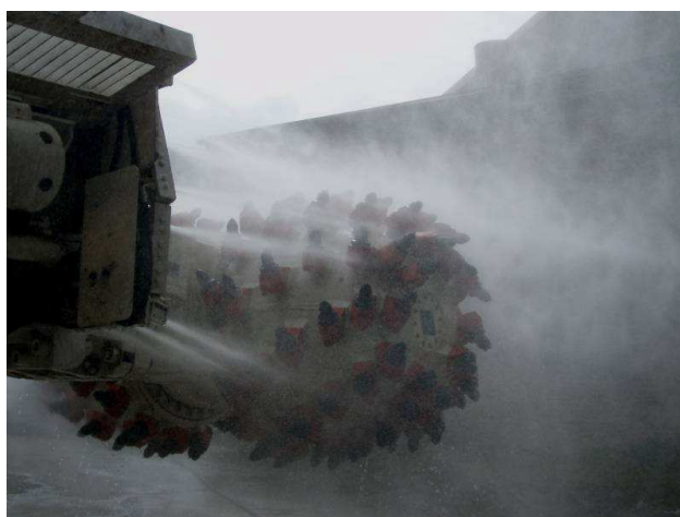
Rys.6. Widok na działającą kurtynę powietrzno-wodną, zabudowaną na kombajnie chodnikowym typu R-200
