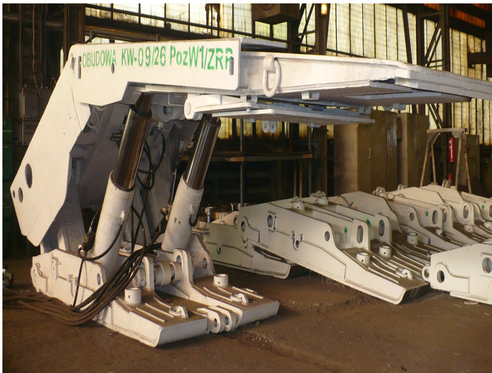
Rys.4. Zmechanizowana obudowa ścianowa KW-09/26 POz W1/ZRP [6]
