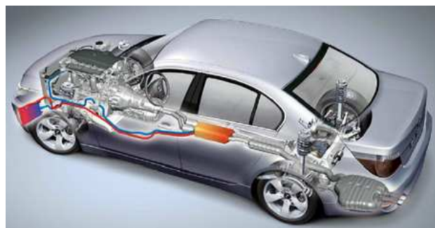
Rys.9. Wizualizacja budowy generatora termoelektrycznego konstrukcji BMW [15]
