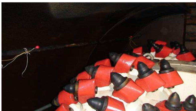
Rys.9. Główna zapalczą o energii 10 kJ, przed zainicjowaniem zapłonu [8]
