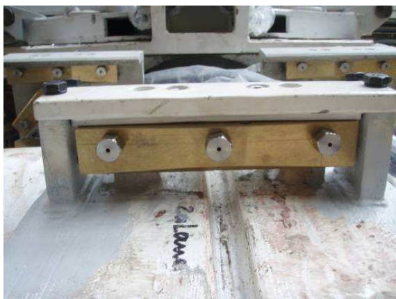
Rys.4. Centralna bateria zraszająca [6]
