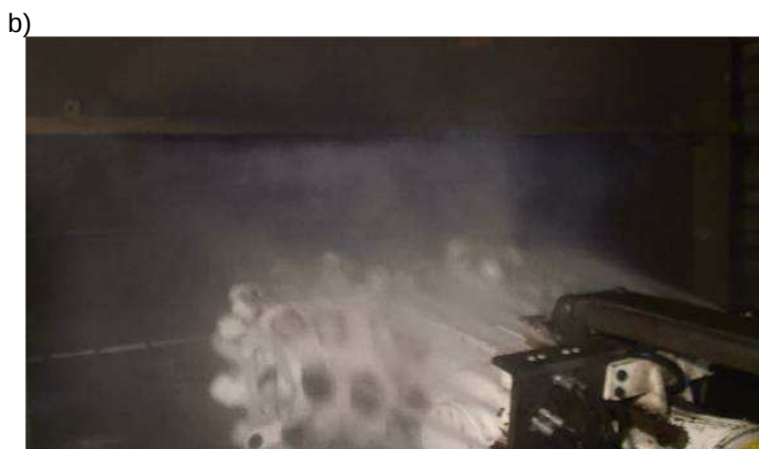
Rys.8. Gaszenie zapalonych płomieni gazu za pomocą powietrzno-wodnej kurtyny zraszającej: a) kombajn R-200, b) kombajn R-130 [7, 8]
