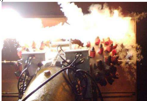
Rys.10. Brak inicjacji zapłonu gazu w wyniku zadziałania kurtyny powietrzno-wodnej: a) kombajn R-200, b) kombajn R-130 [7, 8]
