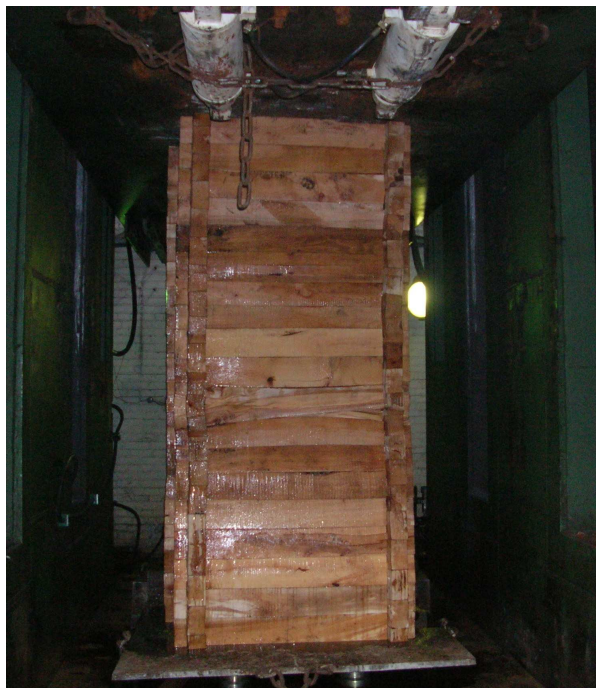
Rys.12. Widok obudowy kasztowej w stanowisku badawczym [fot. KOMAG]
