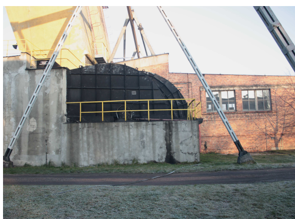
Rys.11. Obudowa dźwiękochłonna-izolacyjna zaprojektowana przez KOMAG w ramach zadania wyłumienia wentylatora wyciągowego [5] (model geometryczny obudowy, układ wentylatora przed zabudową obudowy i po jej zabudowie)
