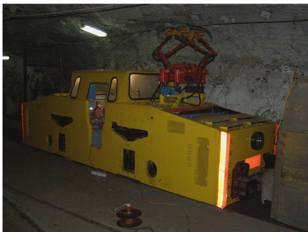
Rys.1. Lokomotywa Ld-31EM podczas prób ruchowych w KGHM Polska Miedź S.A (fot. KOMAG)
