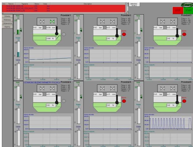
Rys.6. Ekran wizualizacji elektronicznego systemu sterowania osadzarką opracowany przez KOMAG [18]
