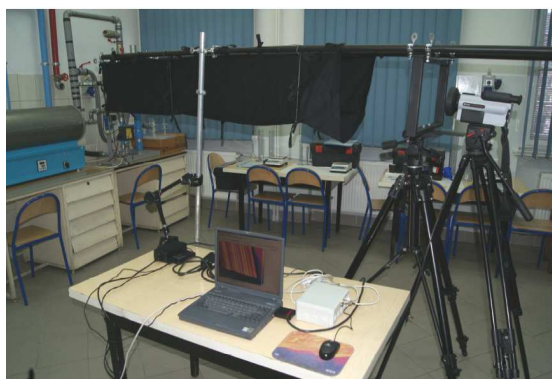
Rys.9. Ogólny widok wyposażenia stanowiska Instytutu Techniki Ciepłej Politechniki Śląskiej dostosowany do pomiarów temperatury bieżni hamulcowych na obiektach rzeczywistych
