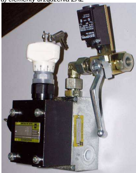
Rys.4. Hydrauliczne agregaty zasilająco-sterujące z dobudowanymi urządzeniami ZAZ i DDS
