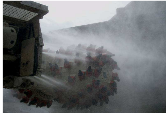
Rys.2. Kombajn chodnikowy R-200 wyposażony w kurtynę zraszania powietrzno-wodnego [3]
