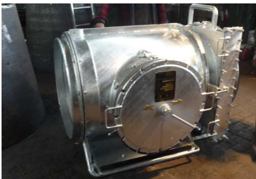
Rys.7. Komora napowietrzająca (fot. SelmaG sp. z o.o.)
