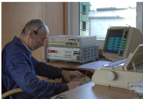
Rys.6. Wielopunktowy system pomiarowy do pomiarów i rejestracji wydłużeń względnych, przemieszczeń i ciśnień [fot. KOMAG]
