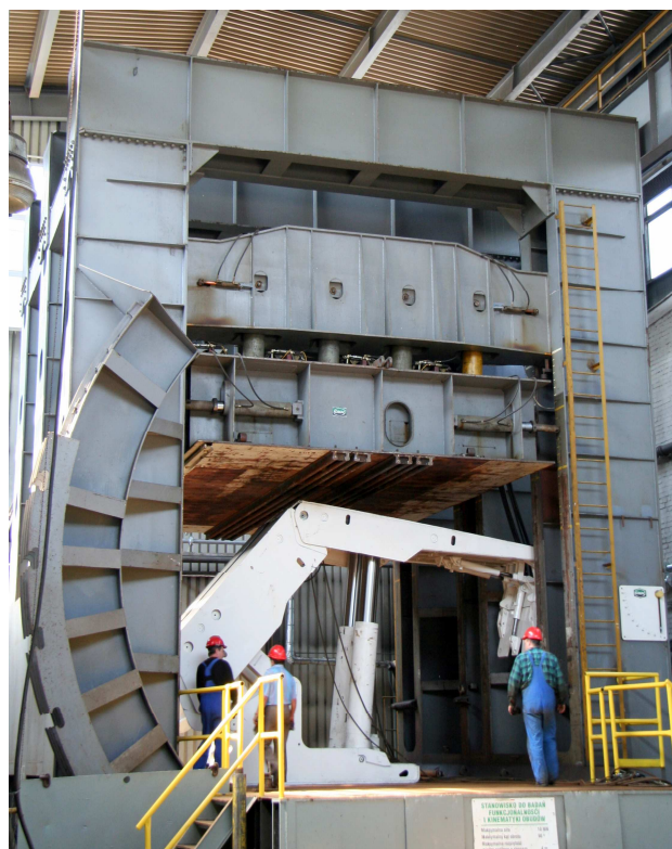
Rys.2. Stanowisko do badań funkcjonalności i kinematyki sekcji obudowy zmechanizowanej
