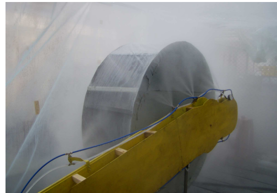
Rys.5. Próby stanowiskowe instalacji zraszającej powietrzno-wodnej na modelu ramienia kombajnu ścianowego [4]
