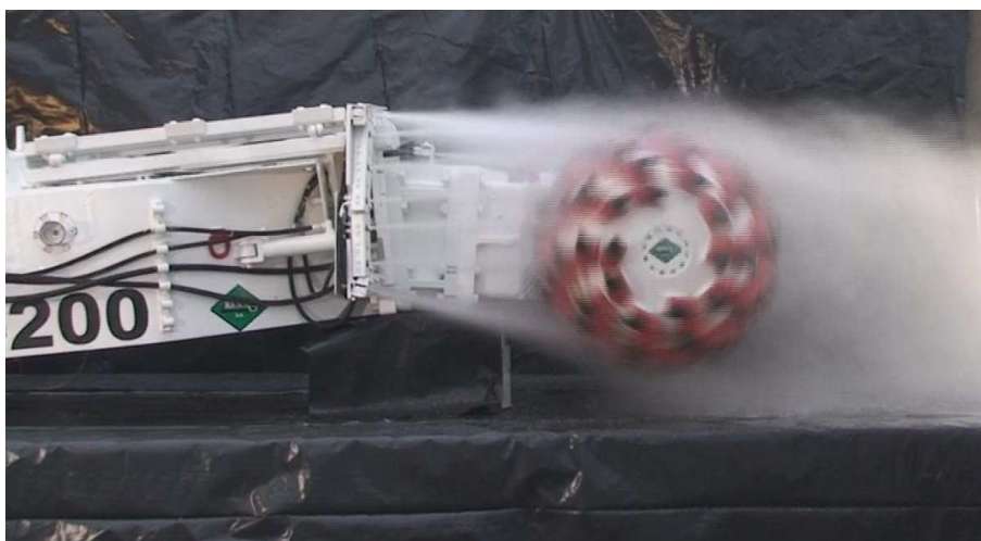
Rys.7. Instalacja zraszania powietrzno-wodnego zainstalowana na kombajnie chodnikowym R-200 produkcji REMAG S.A.
