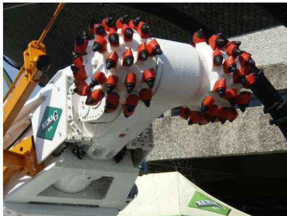
Rys.11. Kurtyna powietrzno-wodna kombajnu R-130, zaprezentowana na Międzynarodowych Targach Górnictwa, Przemysłu Energetycznego i Hutniczego KATOWICE 2009 [8]
