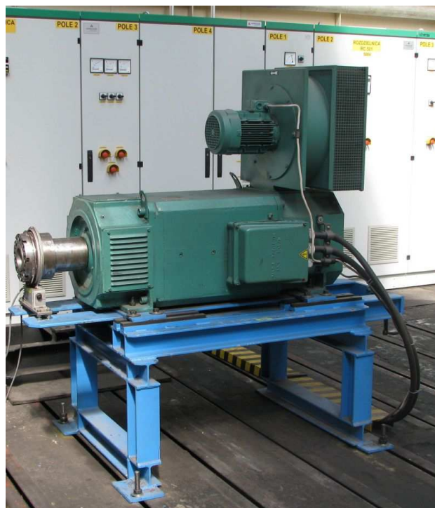
Rys.2. Stanowisko do badań napędów elektrycznych [źródło: fot. KOMAG]
