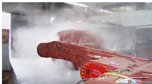
Rys.4. System zewnętrznego zraszania powietrzno-wodnego kombajnu ścianowego KSW-460 NE
