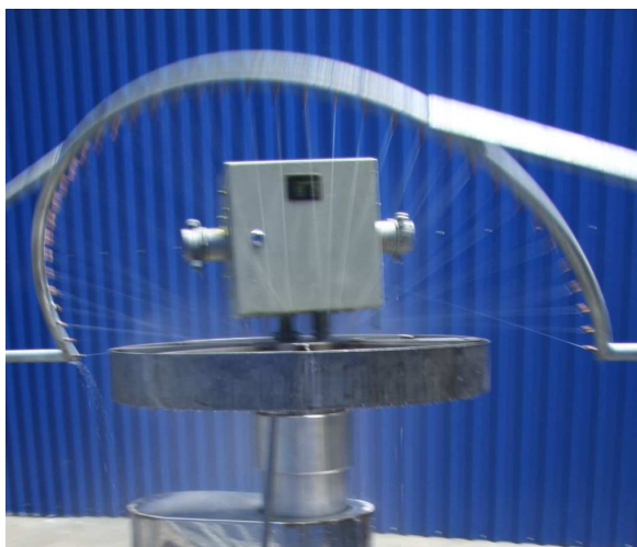
Rys.3. Stanowisko do badań wodnych stopnia ochrony obudowy IP [źródło: fot. KOMAG]
