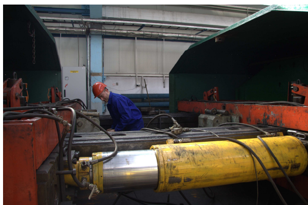
Rys.4. Stanowisko do badań wytrzymałościowych elementów maszyn i urządzeń górniczych [fot. KOMAG]
