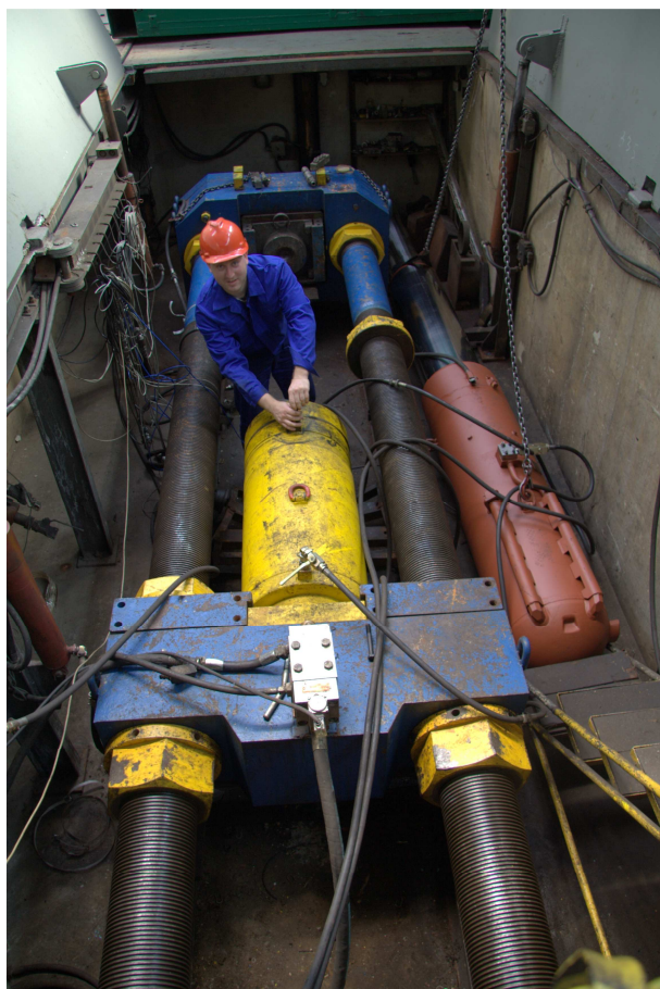
Rys.6. Wielopunktowy system pomiarowy do pomiarów i rejestracji wydłużeń względnych, przemieszczeń i ciśnień [fot. KOMAG]
