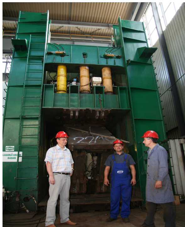
Rys.2. Stanowisko do badań wytrzymałości sekcji obudowy zmechanizowanej [fot. KOMAG]
