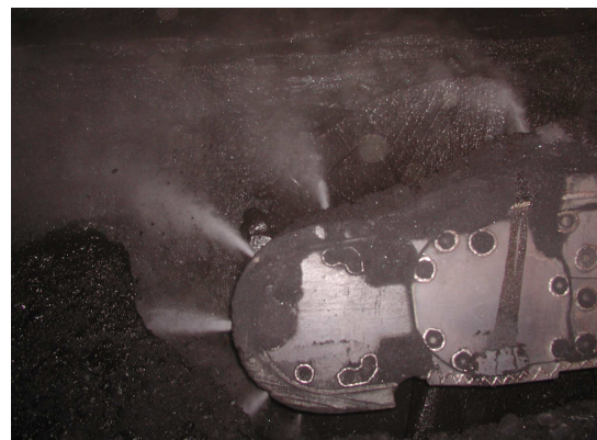
Rys.5. Próby stanowiskowe instalacji zraszającej powietrzno-wodnej na modelu ramienia kombajnu ścianowego [4]
