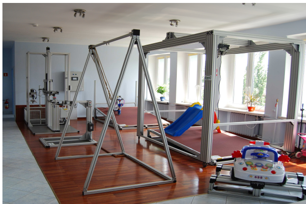
Rys.5. Zautomatyzowane stanowiska do badań właściwości fizyczno-mechanicznych zabawek [25]
