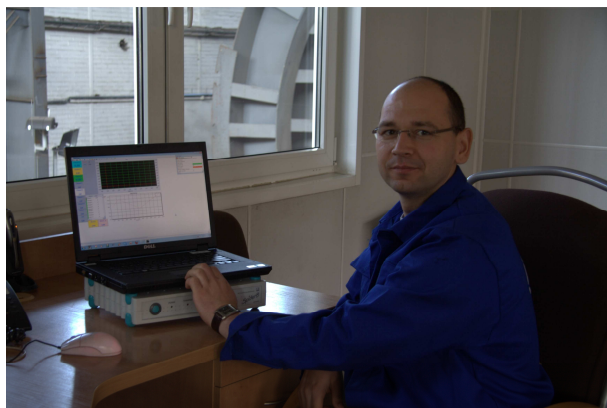
Rys.1. Zestaw aparatury do pomiaru i rejestracji przebiegów statycznych i szybkozmiennych [fot. KOMAG]
