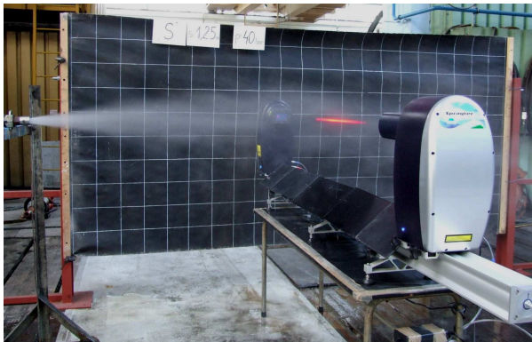
Rys.4. Stanowisko do badań rozkładu frakcyjnego kropli pochodzących z dysz [4]
