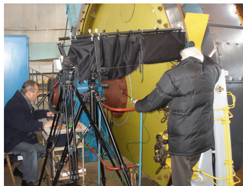
Rys.9. Ogólny widok wyposażenia stanowiska Instytutu Techniki Ciepłej Politechniki Śląskiej dostosowany do pomiarów temperatury bieżni hamulcowych na obiektach rzeczywistych
