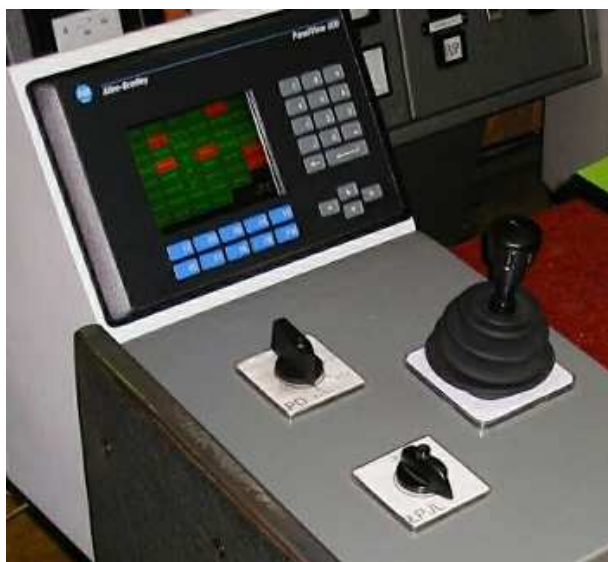
c) panel operatorski zespołu ZSHP zainstalowany na stanowisku maszynisty
