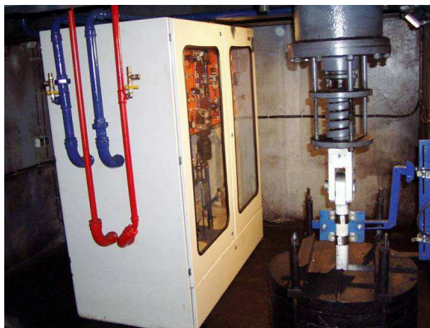
c) panel operatorski zespołu ZSHP zainstalowany na stanowisku maszynisty
