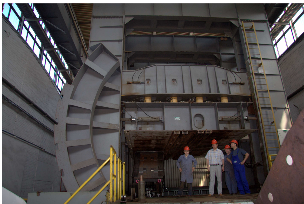
Rys.3. Stanowisko do badań funkcjonalności sekcji obudowy zmechanizowanej [fot. KOMAG]
