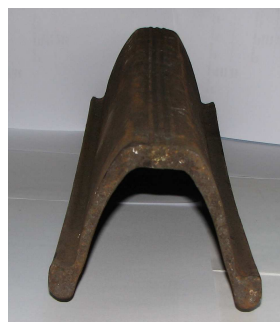
Rys.1. Kształtownik V29 – przekrój poprzeczny oraz fragment odrzwi łukowej ŁP obudowy chodnikowej [3]
