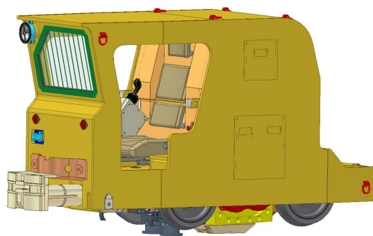
Rys.10. Parametryczny model geometryczny kabiny kolejki spągowej CLS -120 [1]
