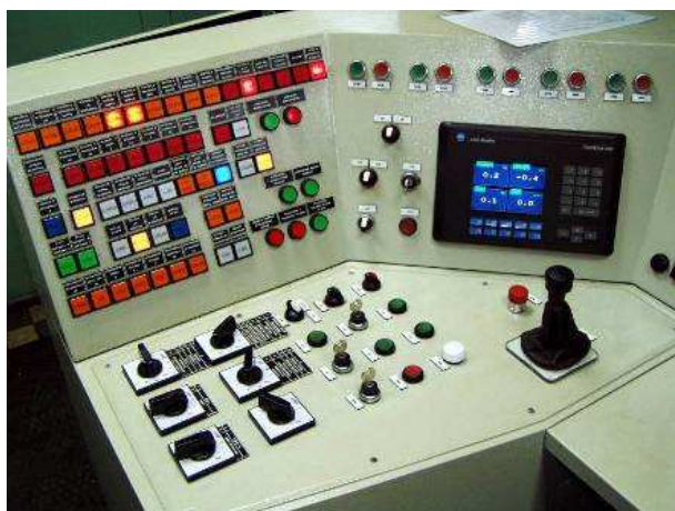
Rys.1. Elektropneumatyczny zespół sterowania hamulców typu ZSHP – elementy składowe
