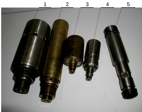
Rys.10. Widok zaworów upustowych [10]
