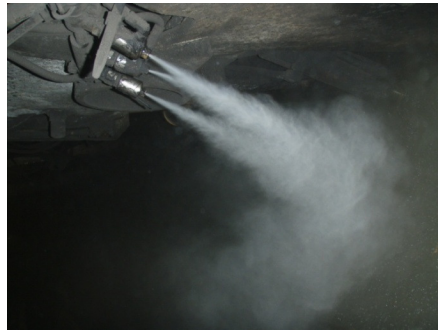
Rys. 5. Bateria zraszająca powietrzno-wodnego systemu zraszania typu KOMAG-N zamontowana pod stropnicą sekcji obudowy zmechanizowanej [10]
