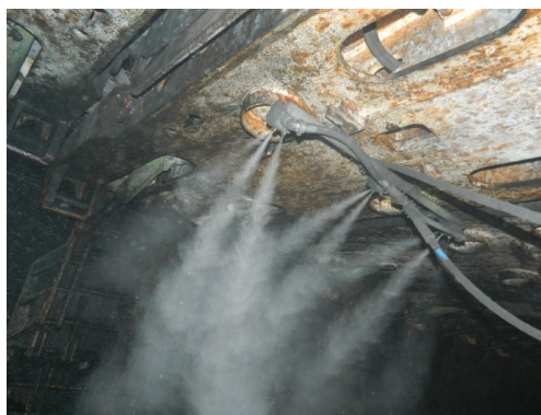
Rys. 4. Bateria zraszająca powietrzno-wodnego systemu zraszania typu KOMAG zamontowana pod stropnicą sekcji obudowy zmechanizowanej [10]
