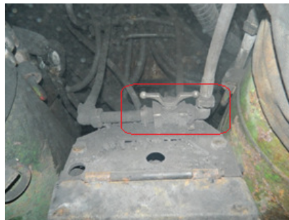
Rys. 7. Zawór odcinający, sterujący przepływem wody i sprężonego powietrza [10]
