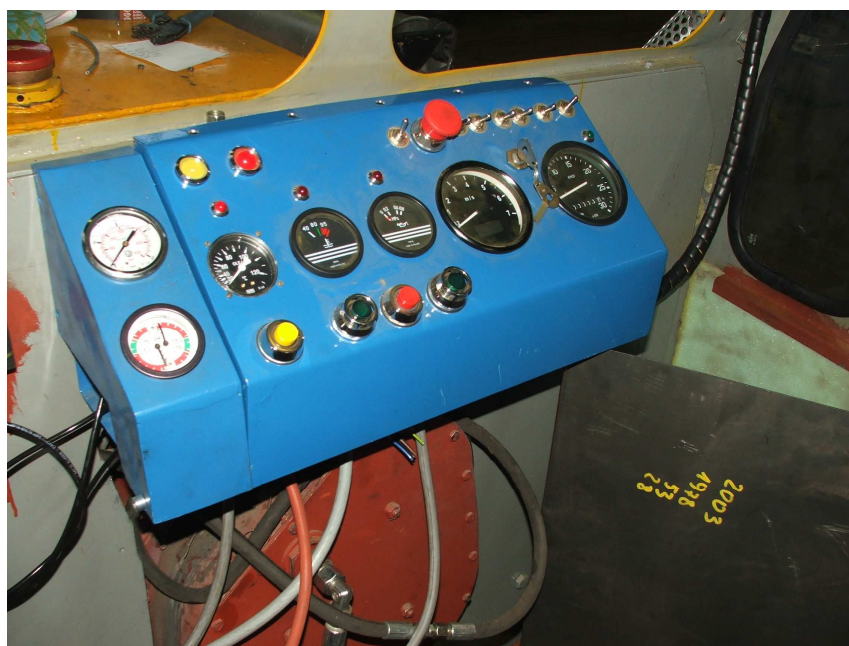
Rys. 9. Pulpit sterowniczy lokomotywy WLP-50EM [7]
