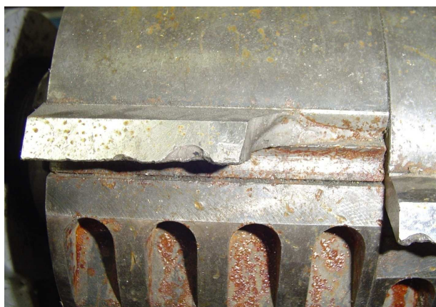
Rys.5. Bębny kruszarki: A – nowe, B – zużyte [9]
