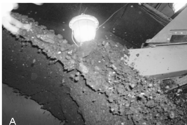
Rys.3. Przykłady uderzenia strugi w element pobierający:
