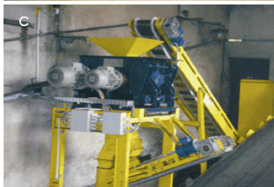
Rys.1. Przykłady rozwiązań próbobiorników: A – próbobiornik szufladowy [3], B – próbobiornik pobierający w poprzek taśmy z ruchem obrotowym naczynia [4], C – próbobiornik pobierający próbki z przesyphu [5]
