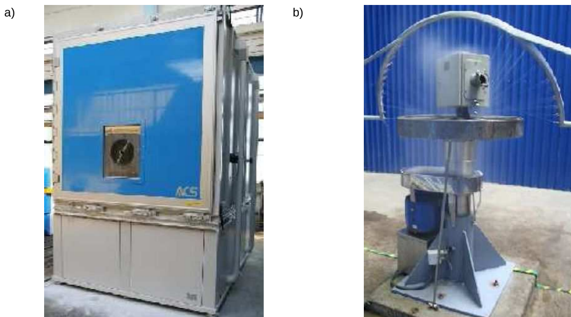
Rys.2. Stanowiska badawcze do badań na zgodność z normami zharmonizowanymi z dyrektywą 94/9/WE ATEX: a) komora klimatyczna, b) stanowisko do badań stopnia ochrony przed wnikaniem wody [źródło: fot. KOMAG]
