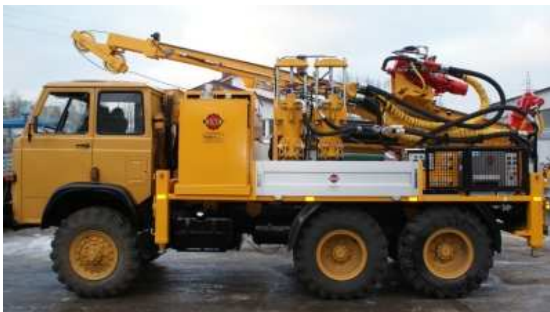
Rys.2. Wiertnica H30S na podwoziu samochodowym Star 266 [6]
