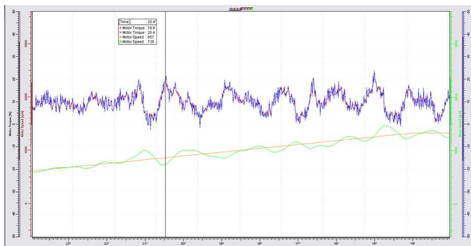
Rys.3. Przebiegi momentów obciążeń oraz prędkości wirników dla sterowania wektorowego w układzie „master-follower”. Źródło: opracowanie własne
