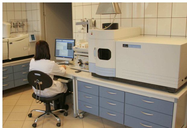
Rys.1. Stanowisko do analizy składu chemicznego, metodą atomowej spektrometrii emisyjnej ze wzbudzeniem plazmowym ICP-AES [źródło: opracowanie własne]
