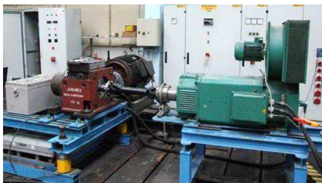
Rys.7. Model napędu z silnikiem z magnesami trwałymi prądu przemiennego na stanowisku badawczym [7]
