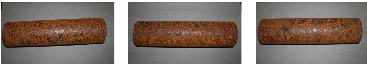
Rys.4. Elementy rurociągu bez zabezpieczonej powierzchni zewnętrznej – próbki 7÷9, stan po badaniach [9]
