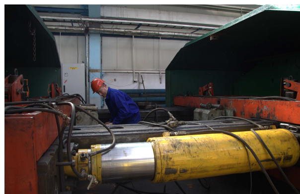
Rys.4. Stanowisko do badań wytrzymałościowych elementów maszyn i urządzeń górniczych [fot. KOMAG]
