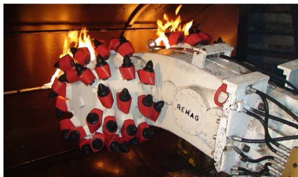
Rys.3. Badania kurtyny powietrzno-wodnej kombajnu chodnikowego na stanowisku badawczym w Kopalni Doświadczalnej „Barbara” Głównego Instytutu Górnictwa [7]
