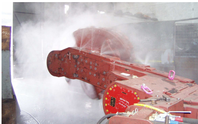
Rys.1. Kurtyna powietrzno-wodna na kombajnie ścianowym KSW-460NE [7]
