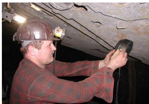
Rys.8. Odczyt kodu RFID z sekcji obudowy zmechanizowanej (a) i fragment skojarzonej z kodem listy kontrolnej (b) [opracowanie własne]
