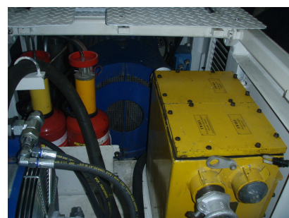
Rys.4. Elektrohydrauliczny napęd podwozia: a) widok ogólny, b) zespół pomp, c) wyłącznik ognioszczelny
