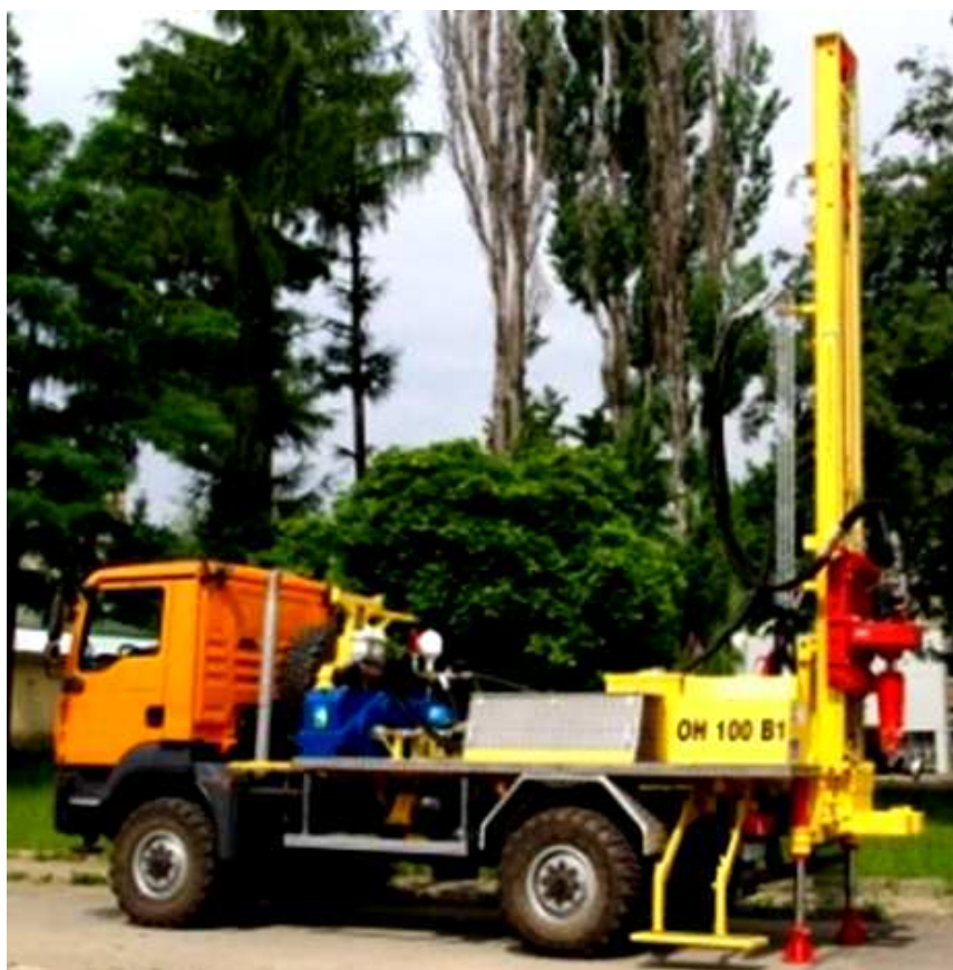
Rys.1. Wiertnica OH100 na podwoziu samochodowym MAN TGM 13.240 [4]
