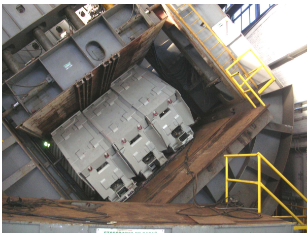
Rys.3. Stanowisko do badań funkcjonalności sekcji obudowy zmechanizowanej [fot. KOMAG]
