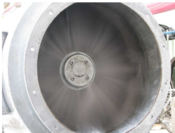
Rys.3. Kurtyna wodna wytwarzana przez dyszę wodną w urządzeniu odpylającym [KOMAG]
