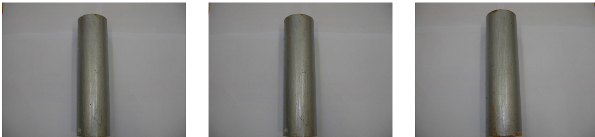
Rys.3. Elementy rurociągu pomalowane farbą – próbki 4÷6, stan po badaniach [9]
