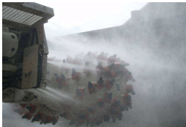
Rys.2. Kurtyna powietrzno-wodna na kombajnie chodnikowym R-200 [7]
