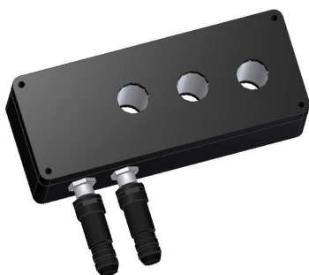
Rys.7. Model przestrzenny modułu pomiarowego prądu 3x400 A [opracowanie własne ITG KOMAG]
