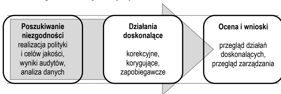
Rysunek 42. Schemat postępowania z niezgodnościami w systemie zarządzania jakością
