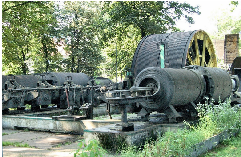
40. Maszyna parowa podwójnego rozprężania z szybu „Staszic” kopalni „Siemianowice”, w której widać wyraźnie różnice średnic cylindrów. Podobnej konstrukcji była maszyna w kopalni „Anna”, tylko zamiast bębna linowego miała tarczę Koepe. Maszyna jest eksponatem w skansenie „Królowa Luiza” w Zabrze.
