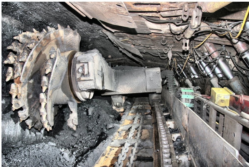
134. Kombajn ścianowy KSW-800 używany w latach 2010-12.
