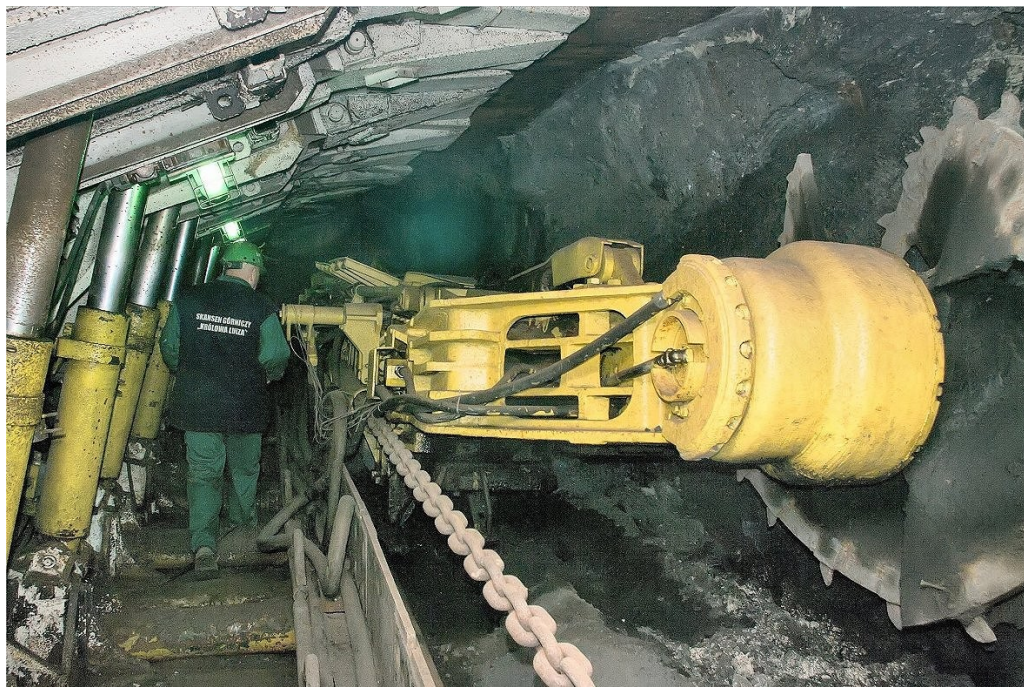
115. Kombajn ścianowy KWB-3RDU (Skansen Górniczy Królowa Luiza).
