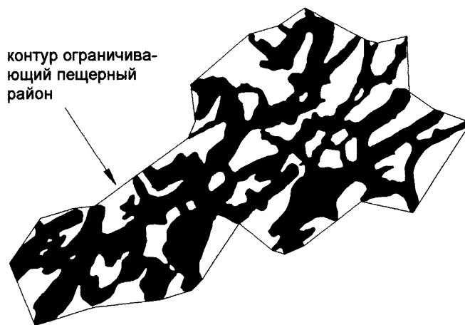
Рис. 3. Способ оконтуривания пещерного района для расчета площади его поля и объема блока
