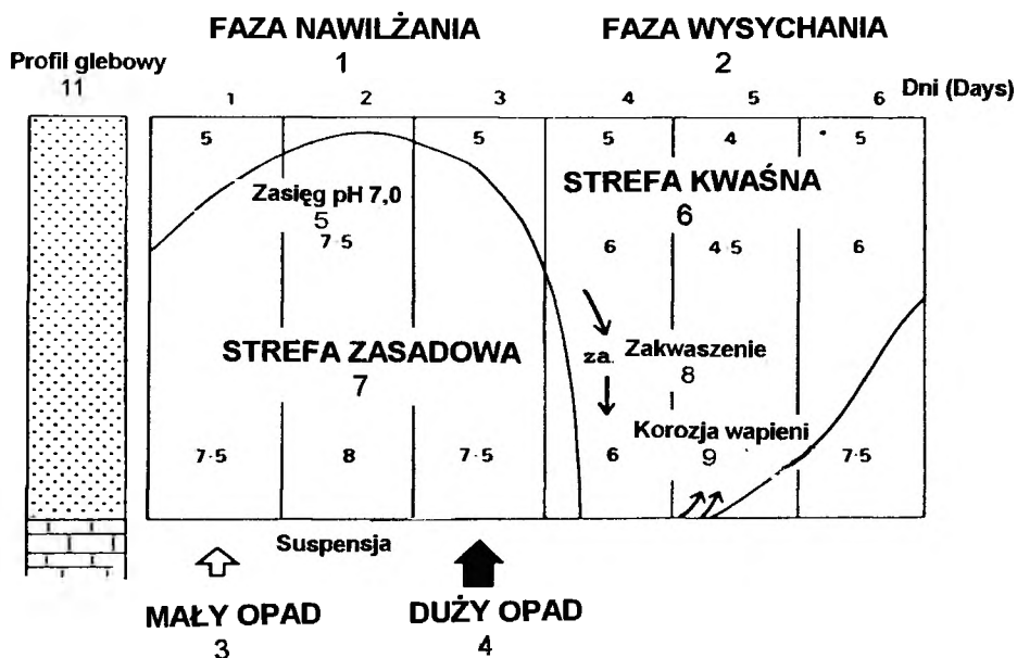
Ryc. 57. Model zakwaszania środowiska glebowego oraz kontaktu skała—gleba po intensywnych opadach deszczu (oraz w czasie roztopów) (wg S. T. Trudgilla, 1985)
