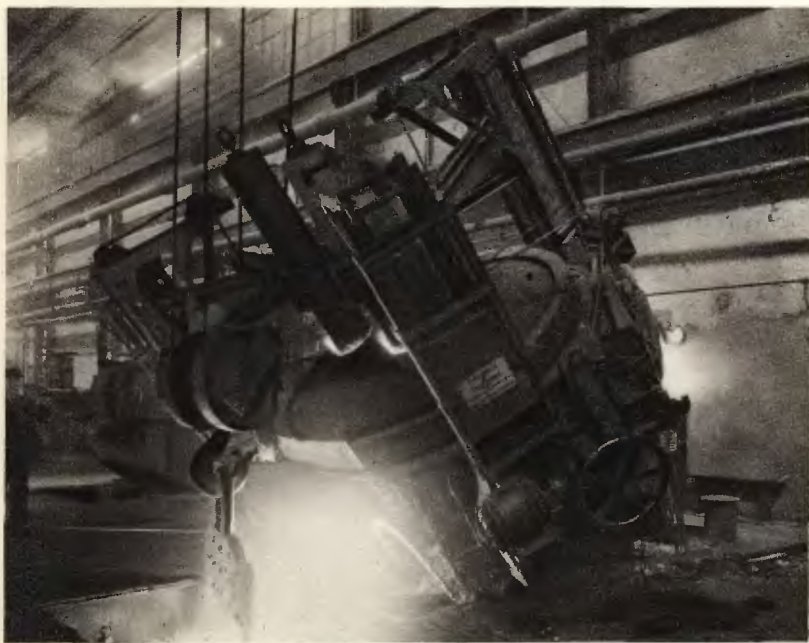
Spust stali z pieca elektrycznego.
