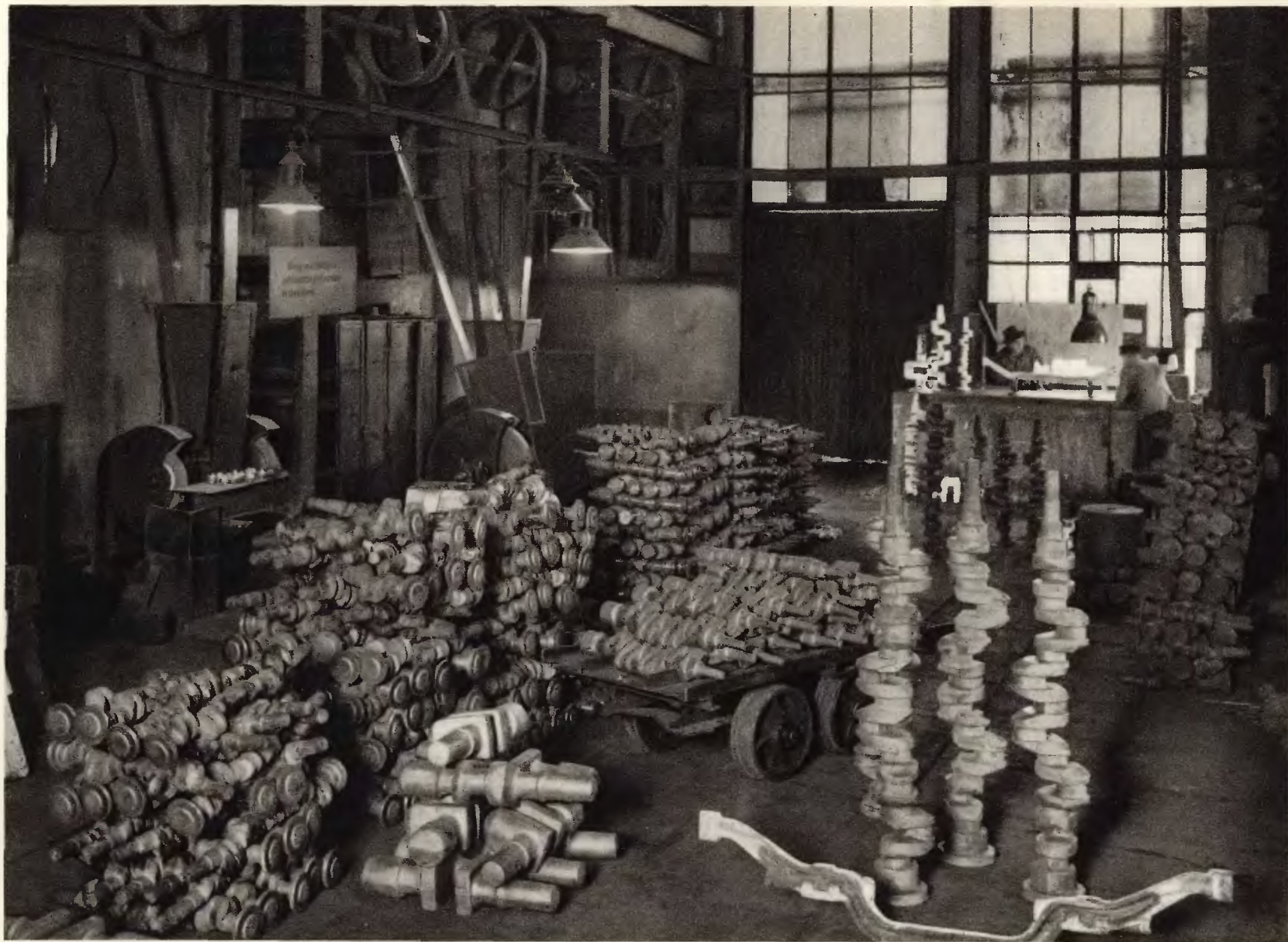
Samochodowe wały wykorbione (część z wielkiej dostawy zagranicznej pod- czas ostatecznej kon- troli przed wysył- ką). Wykonała »Sta- lownia Batory«.
