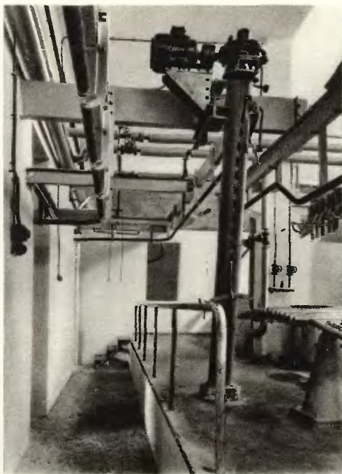
Elevator śrubowy z częścią toru kolejki do opalania i z prysznicem do zmywania tusz, umocowanym ponad torem.
