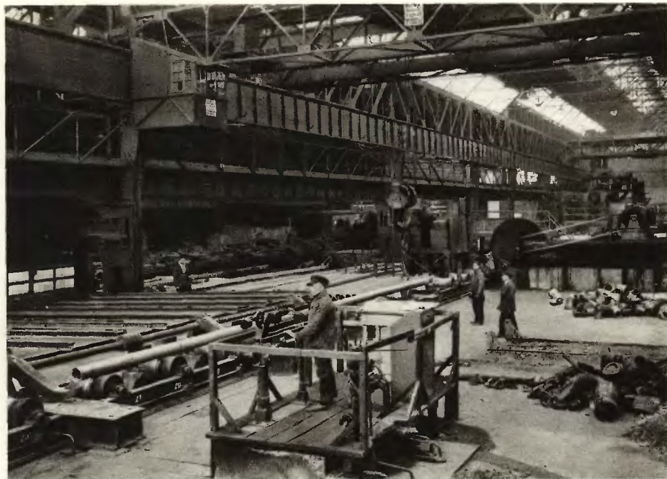
Rurownia w hucie »Batory« — na pierwszym planie automatyczna waga, dalej piła do cięcia rur.
