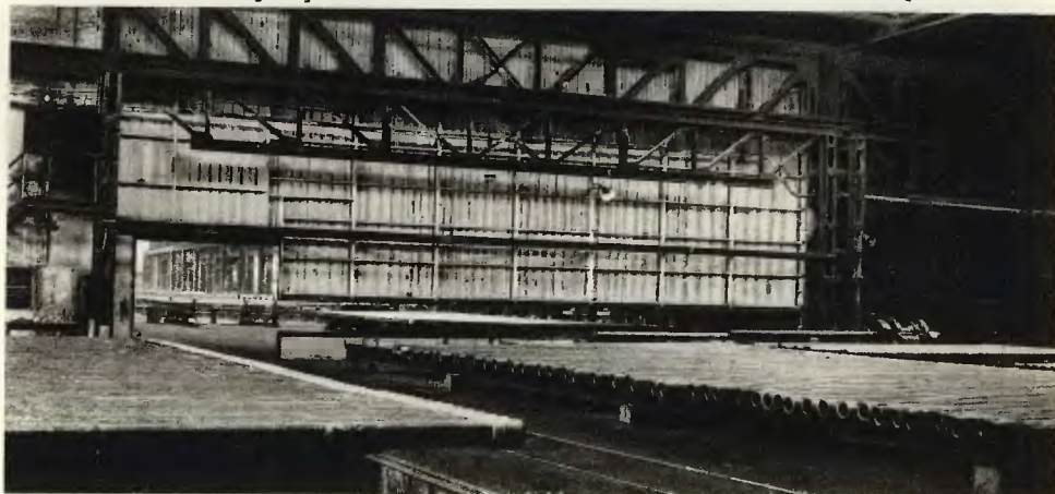
Rurownia w hucie »Batory« — studzienne rury wiertnicze przygotowane do odbioru technicznego.
