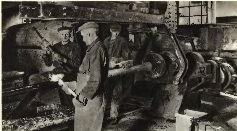
Rurownia w hucie »Batory«. Smołowanie oraz izolowanie rur stalowych.
