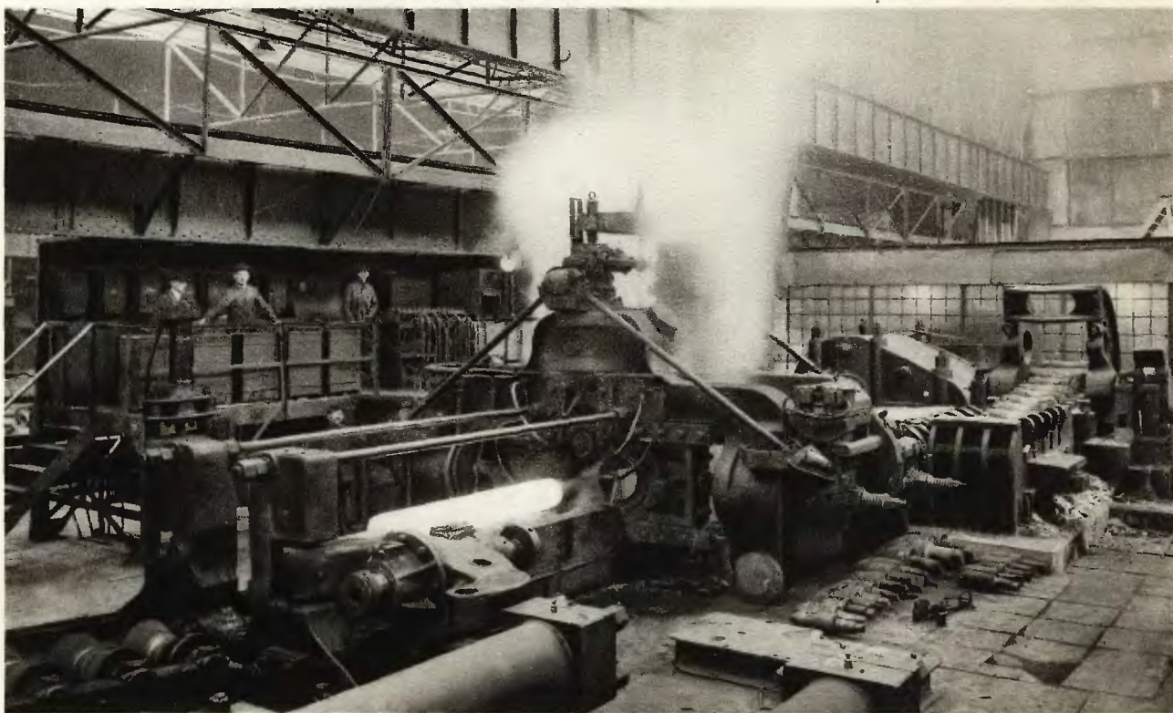
Rurownia huty »Batory« — dziurowanie wlewka na walcарce skośnej.
