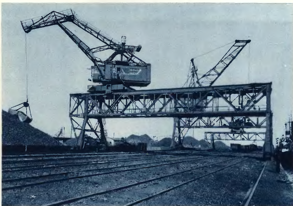
Ryc. 5. Mostowy żuraw chwytny »Progress III«. Nabrzeże Śląskie.
