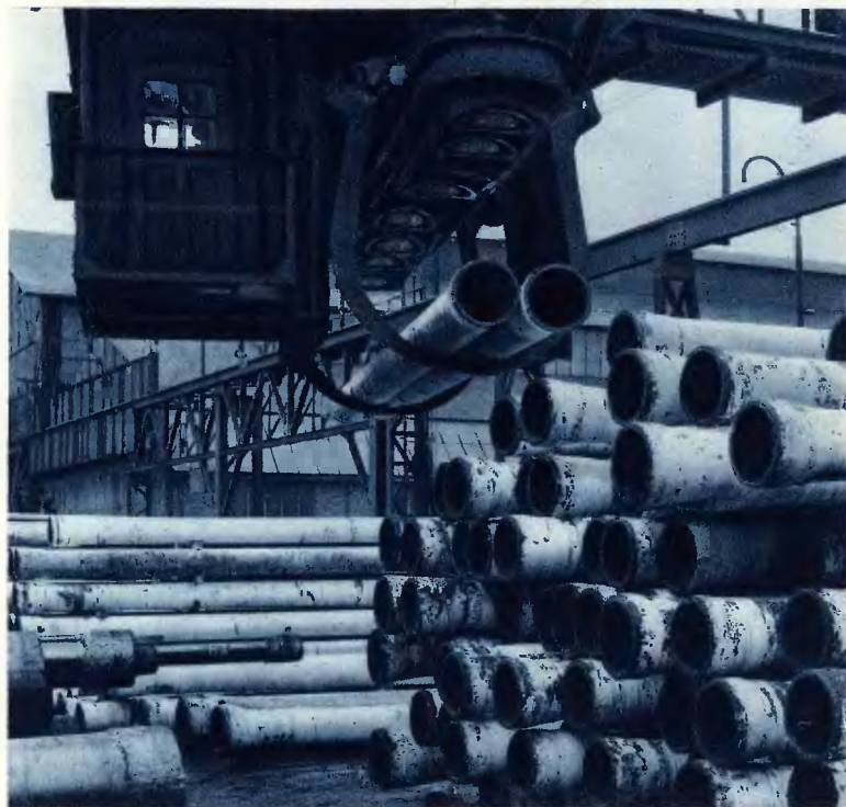
Sortowanie rur stalowych w hucie »Batory« przed wysyłką do Argentyny.
