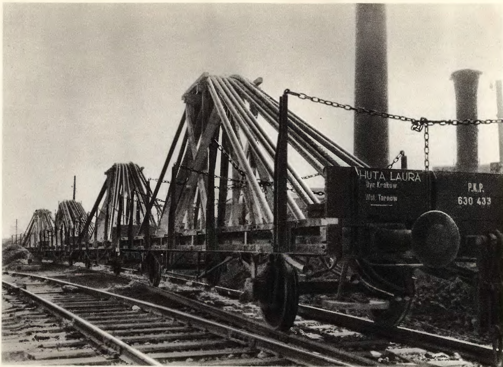
Seria rur giętych kotłowych (dla ko- tłów wodno-ru- rowych) wykonana przez hutę »Laura« w Siemianowicach na zamówienie Za- kładów Ostrowiec- kich.
