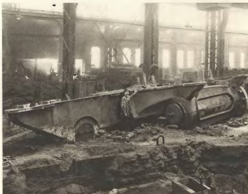
Ryc. 42. Gotowy odlew ramy z ryciny 39 w stanie surowym.
