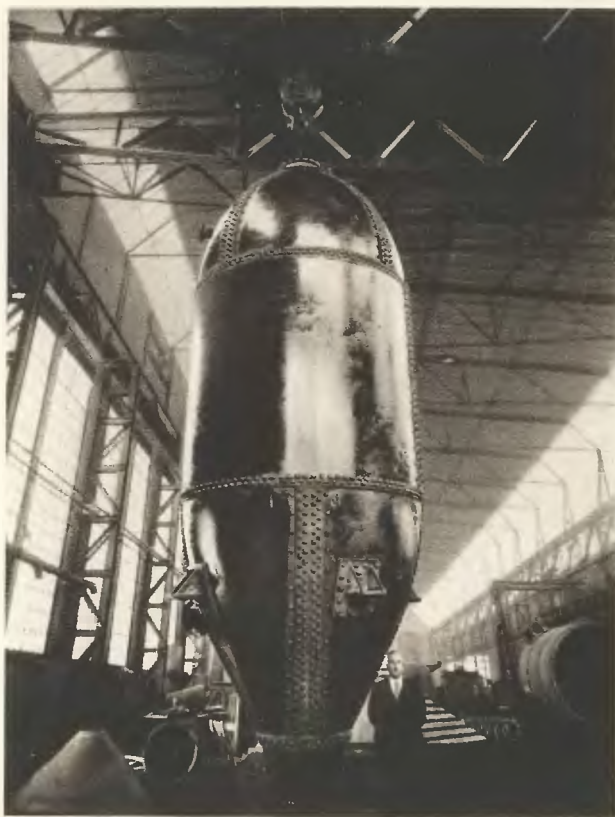
Ryc. 63. Warnik celulozy o pojemności 40 m 3 na ciśnienie robocze 10 atn.
