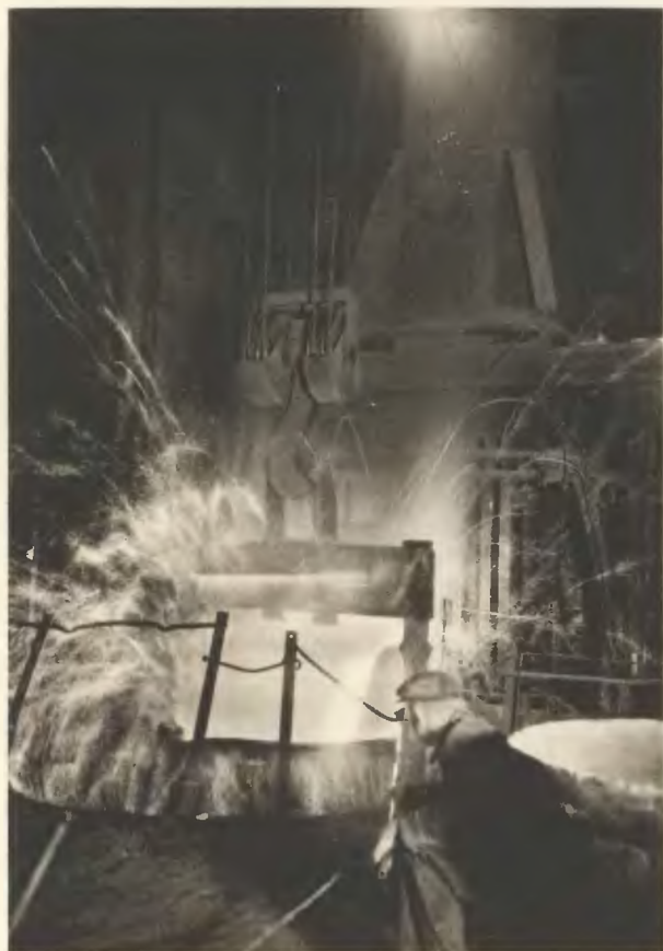
Ryc. 48. Spust 30-tonowego pieca płomiennego w odlewni Zakładów Budowy Maszyn »Huta Zgoda«
