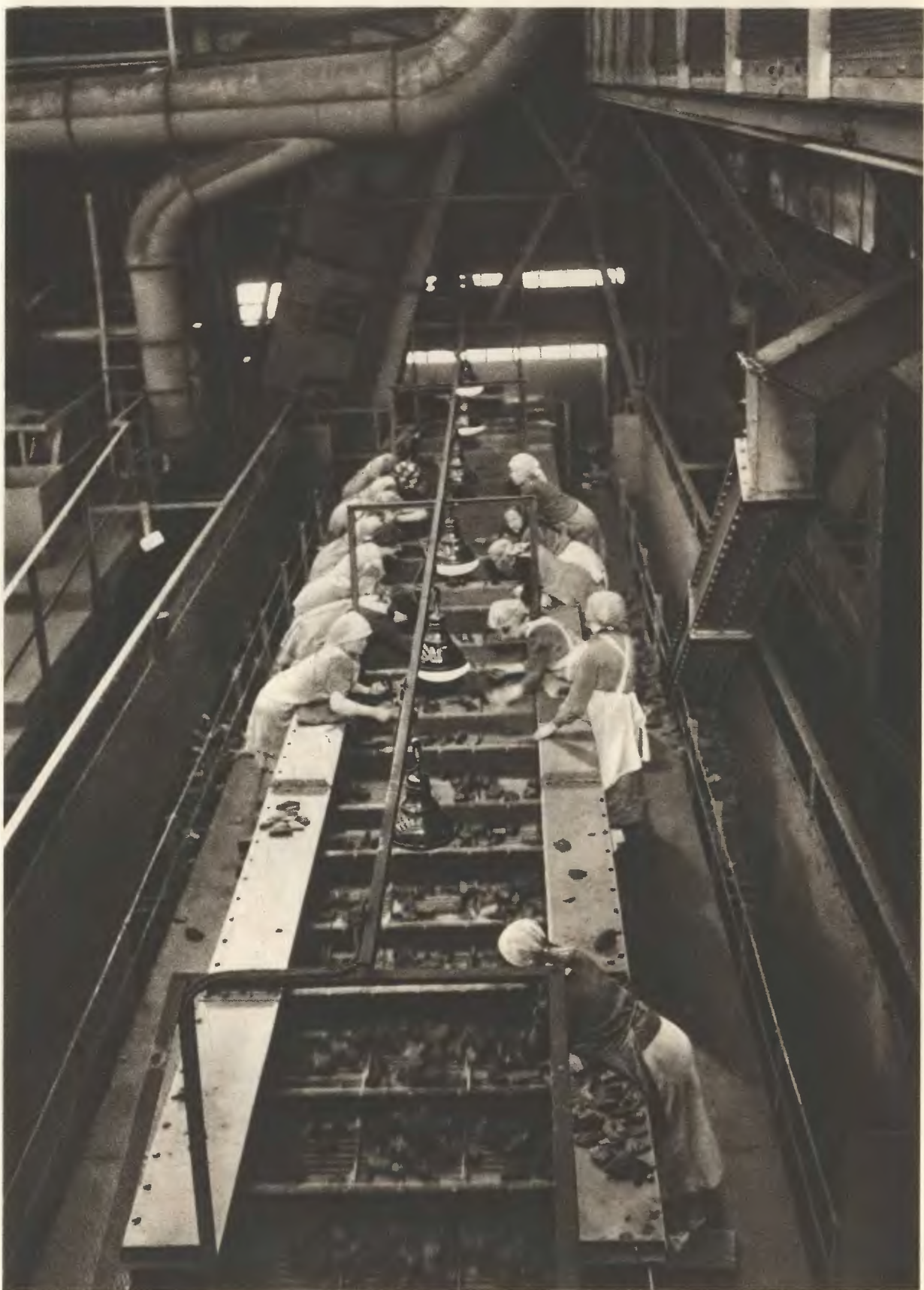
Sortownia węgla na Kopalni »Brzeszcze« — taśma przebiegająca dla kostki, wykonana przez Zakłady Budowy Maszyn »Huta Zgoda«.
