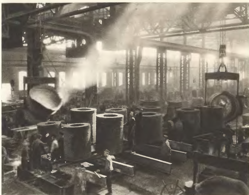
Ryc. 41. Wykonanie odlewu ramy maszyny parowej z ryciny 39.
