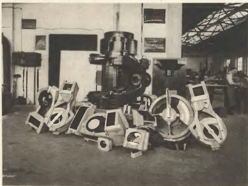
Ryc. 51. Zestawienie kompletu modeli cylindra okrętowej maszyny parowej.
