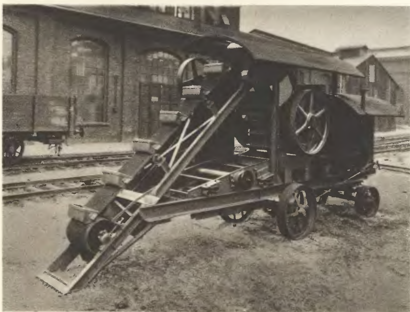
Ryc. 35. Grysownia przewoźna typu normalnego, zatwierdzonego przez Min. Przem. i Handlu. Wykonanie Zakładów Budowy Maszyn »Huta Zgoda«.
