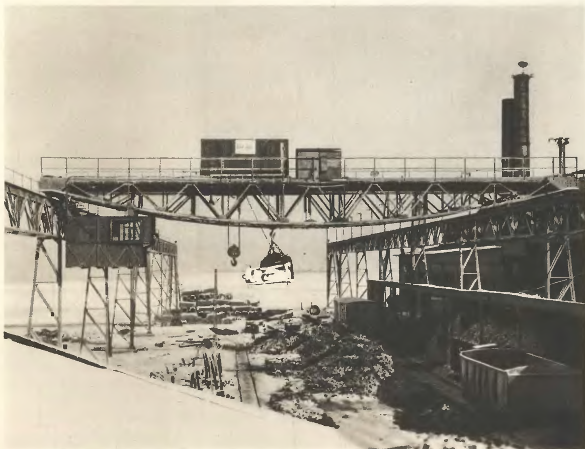
Ryc. 53. Skład surowca obok odlewni. Widoczna suwnica z uchwytem elektromagnetycznym dla transportu złomu i surowki wykonana przez Zakłady Budowy Maszyn »Huta Zgoda«.
