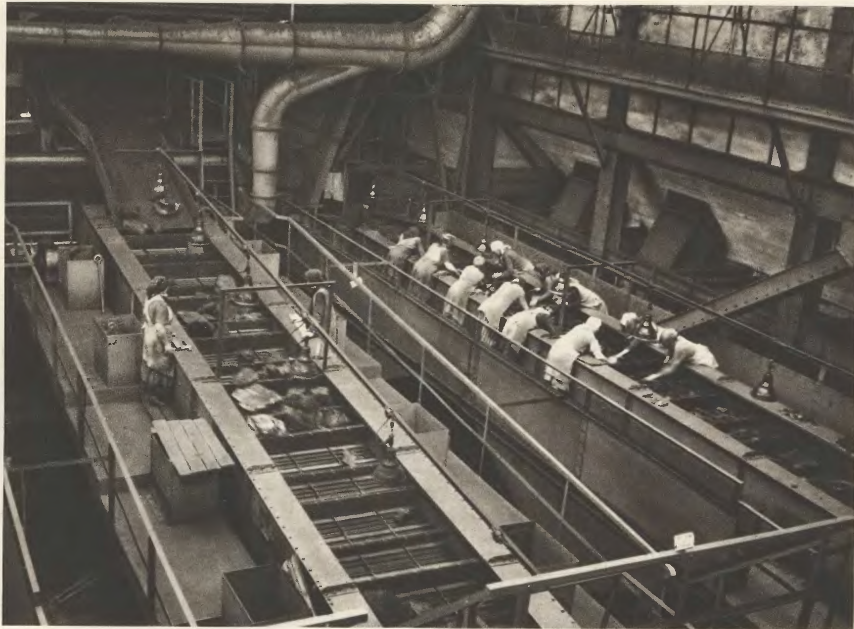
Sortownia węgla na Kopalni »Brzesz- cze« — widok taśm przebiegających dla kostki i węgla gru- bego, wykonana przez Zakłady Bu- dowy Maszyn »Huta Zgoda«.
