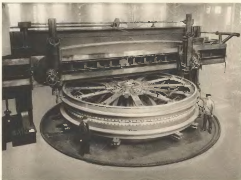
Ryc. 59. Karuzelówka do 10000 mm \varnothing toczenia w hali głównej warsztatu mechanicznego Zakładów Budowy Maszyn »Huta Zgoda«.
