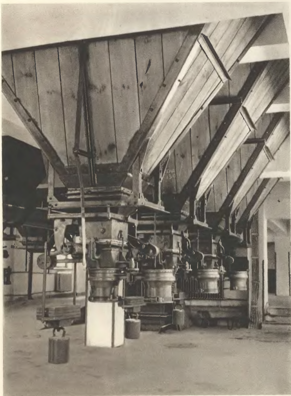
Stacja do automatycznego odważania soli jadalnej i workowania jej w młyńie solnym przy szybie św. Kingi Żupy Solnej w Wieliczce wykonana przez Zakłady Budowy Maszyn »Huta Zgoda«.
