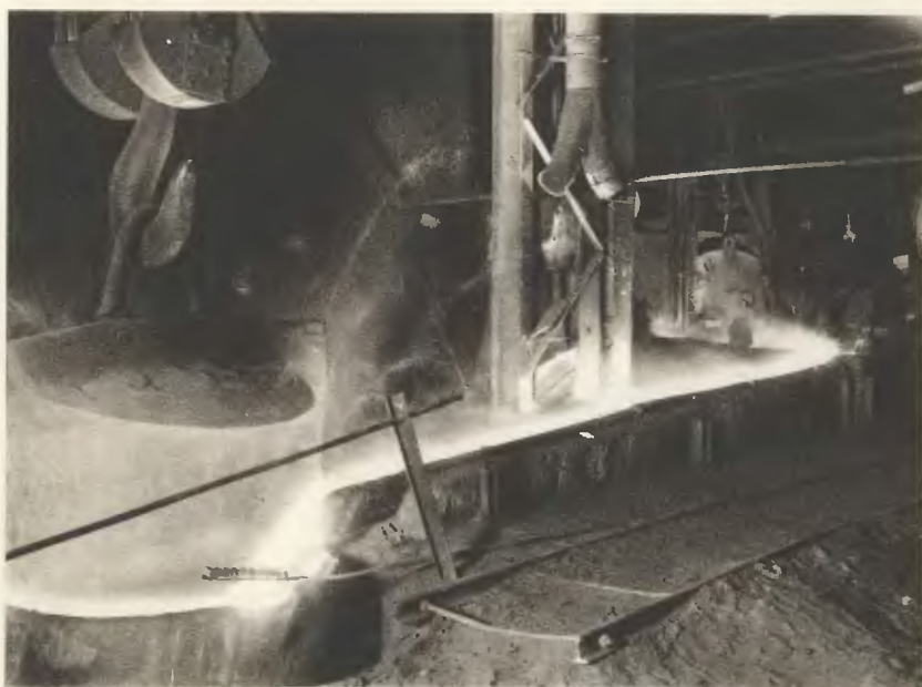
Ryc. 50. Spust 18-tonowego pieca płomiennego w odlewni Zakładów Budowy Maszyn »Huta Zgoda«.
