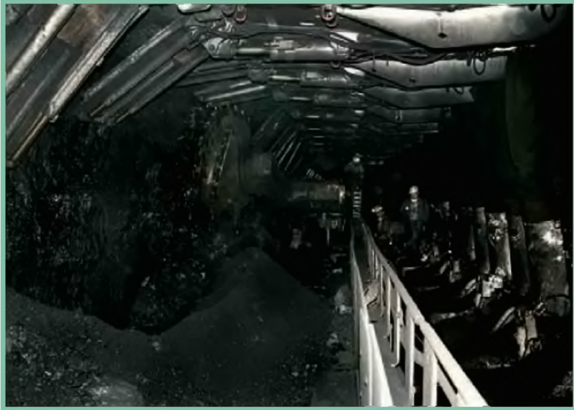
Wydobywanie węgla z wyrobiska ścianowego
