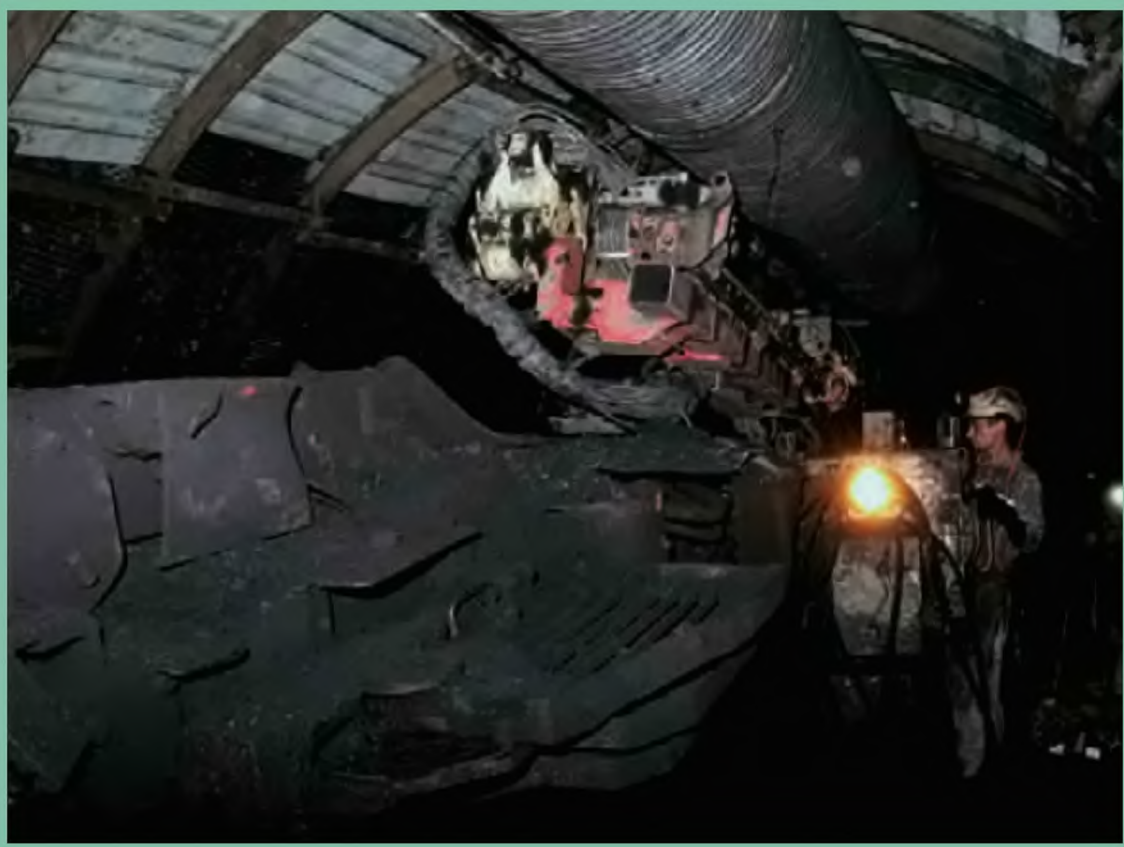
Drążenie wyrobiska korytarzowego kombajnem
