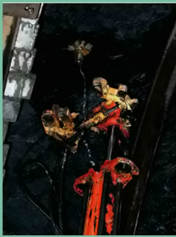
Kotwienie calizny górotworu
