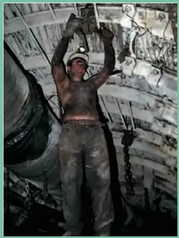
Montaż zawiesi trasy kolejki podwieszanej
