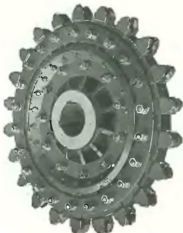
Fig. 396. Ketten-Greiferscheibe von Heckel.
