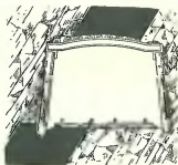
Fig. 73 a. Türstöcke aus Holz und Eisen mit Z-Eisen als Zwischenlagen.
