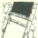
Fig. 13. Schwebestempel mit Sicherung.
