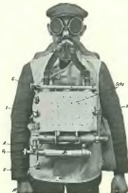
Fig. 560. Atmungsgerät „Pneumatogen“, betriebsfertig angeschnallt.
