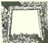
Fig. 21. Deutscher Türstock mit schrägen Beinen.
