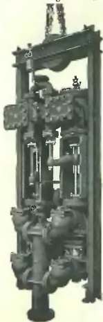
Fig. 524. Duplexpumpe für Abteufzwecke (Leistung 3 cbm minütlich bei 150 m Druckhöhe und 6 Atm. Dampfspannung).
