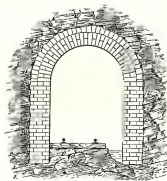
Fig. 96. Scheibenmauern mit Halbkreisgewölbe.
