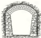
Fig. 98. Geböschte Scheibenmauern aus Bruchsteinen mit Ziegel-Gewölbekappen.
