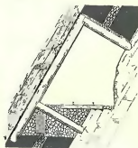
Fig. 56. Schalholzzimmerung mit Bahnstempel.
