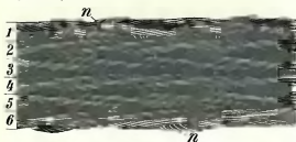
Fig. 453. Sechslitziges Bandseil.
