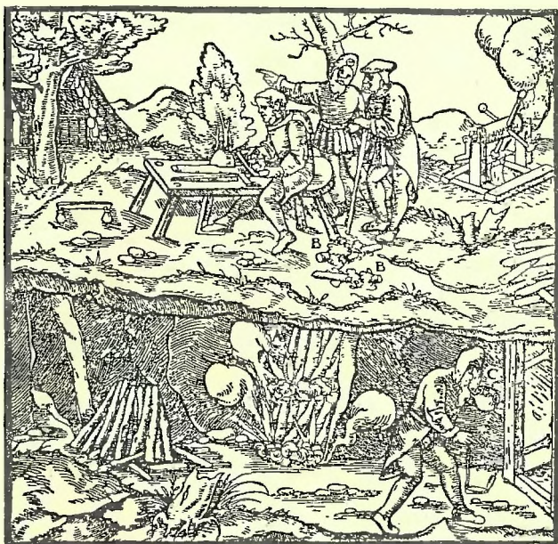
Rozbijanie skał zapomocą kolejnego działania ognia i wody. Robotnik u góry nakłada wiory na każdą wiązkę chróstu. U dołu górnik po zapaleniu ognia ucieka przed dymem. Z książki Agricoli.
