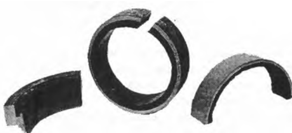
Wycinki stalowej, gumowanej rury podsadzkowej, którą w latach 1974–1986 przetransportowano w kopalni „Barbara-Chorzów” ponad 5 mln m 3 piasku podsadzkowego z niewielkim dodatkiem kamienia
