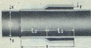
Kielich usztywniający i uodporniający przewód przeciw wszelkiego rodzaju wstrząśnieniom
