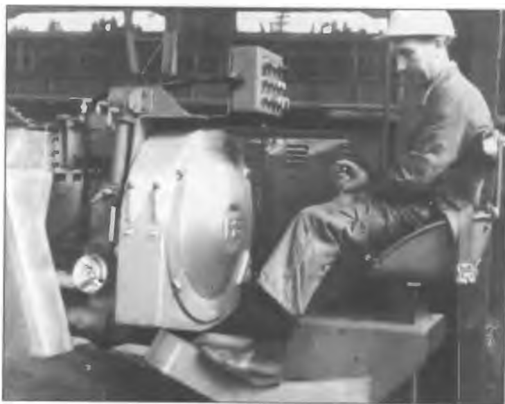
Narzucarka piasku angielskiej firmy Foundy Equipment.
