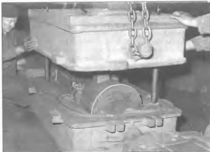
Składanie formy w odlewni żeliwa.
