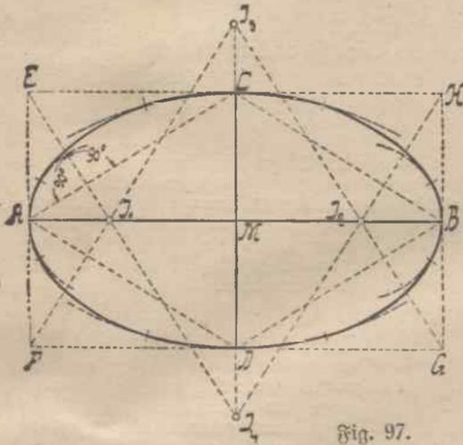
$J_1, J_2, J_3$  und  $J_4$ . Diese vier Punkte sind die Krümmungsmittelpunkte für die Krümmungskreise der Ellipse in den Endpunkten ihrer beiden Axen. Die Krümmungskreise selbst erhält man, indem man um die Punkte  $J_1$  und  $J_2$  mit den Strecken  $J_1A$  bezw.  $J_2B$  und um die Punkte  $J_3$  und  $J_4$  mit  $J_3D$  bezw.  $J_4C$  Kreisbögen schlägt. Diese Kreisbögen geben für eine gewisse
