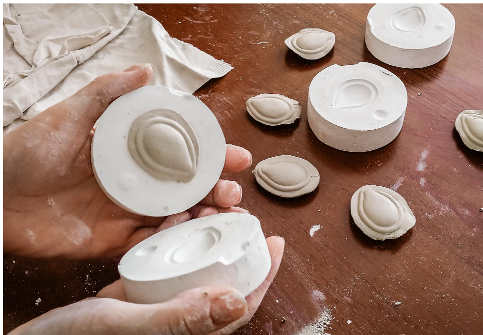
↑ Fot. 9. Proces odciskania glinianych nasion z matrycy gipsowej, źródło własne.
