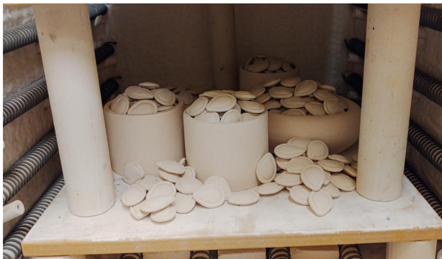
↑ Wypał nasion w piecu elektrycznym na biskwit.
