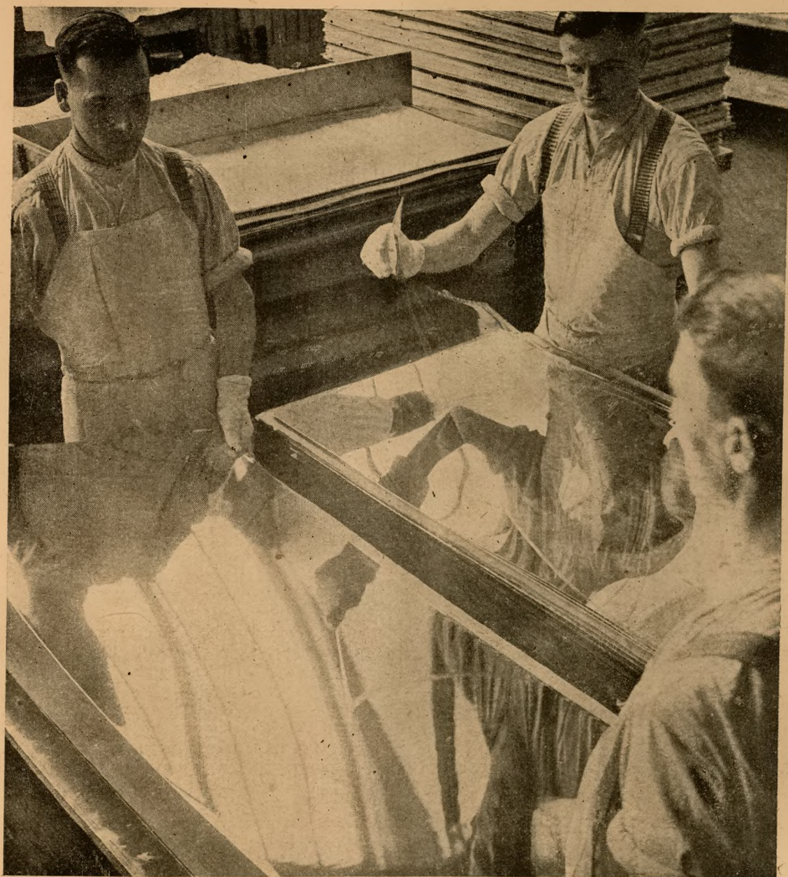
Produkcja ksylonitu, jednego z najbardziej znanych „plastyków”. Ostatnia faza przeróbki: nadawanie połysku przez ogrzewanie i ochładzanie pod wysokim ciśnieniem na lustrzanej tafli metalowej.
