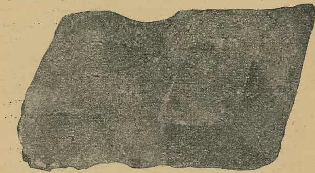
Rys. 14. Romboedr z nowopowstałej skały (większy), romboedr ze skały karbonu (mniejszy). Widoczna zgodność kątów między krawędziami romboedrów. ¼ wielkości naturalnej
