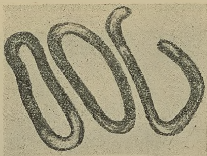
Rys. 2. Zniekształcone i zniszczone ogniwa środkowe łańcucha
