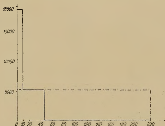
Rys. 12. Porównanie nakładów inwestycyjnych zwałowiska racjonalnego z urządzeniem do zwałowania typu A
