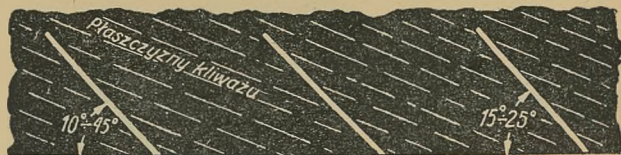
Rys. 2. Korzystny sposób skierowania otworów strzałowych w przypadku małego kąta pod jakim płaszczyzny kłważu przecinają płaszczyznę czoła ściany
