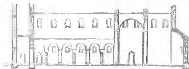
Abb. 72. Längsschnitt einer romanischen Kirche, mit sog. Stützenwechsel.
