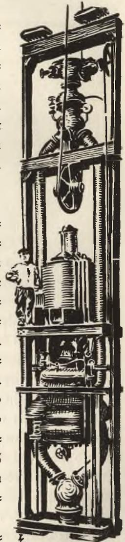
Elektrisch angetriebene Zentrifugal-Abteuspumpe
