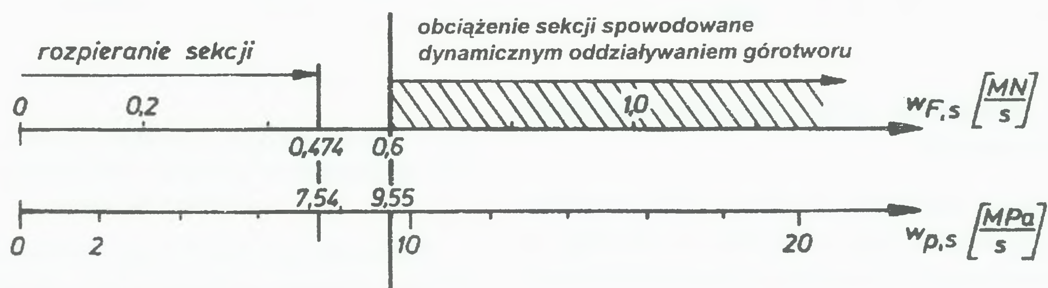
Rys.2. Średnie tempo przyrostu siły w stojakach charakteryzujące rozpieranie sekcji oraz obciążenie spowodowane zjawiskami dynamicznymi w górotworze
