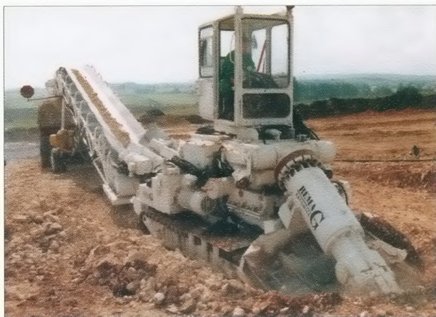
Kombajn produkcji REMAG-u typu RO-100K do pracy w wyrobiskach odkrywkowych REMAC's harvester type RO-100K for open casts
