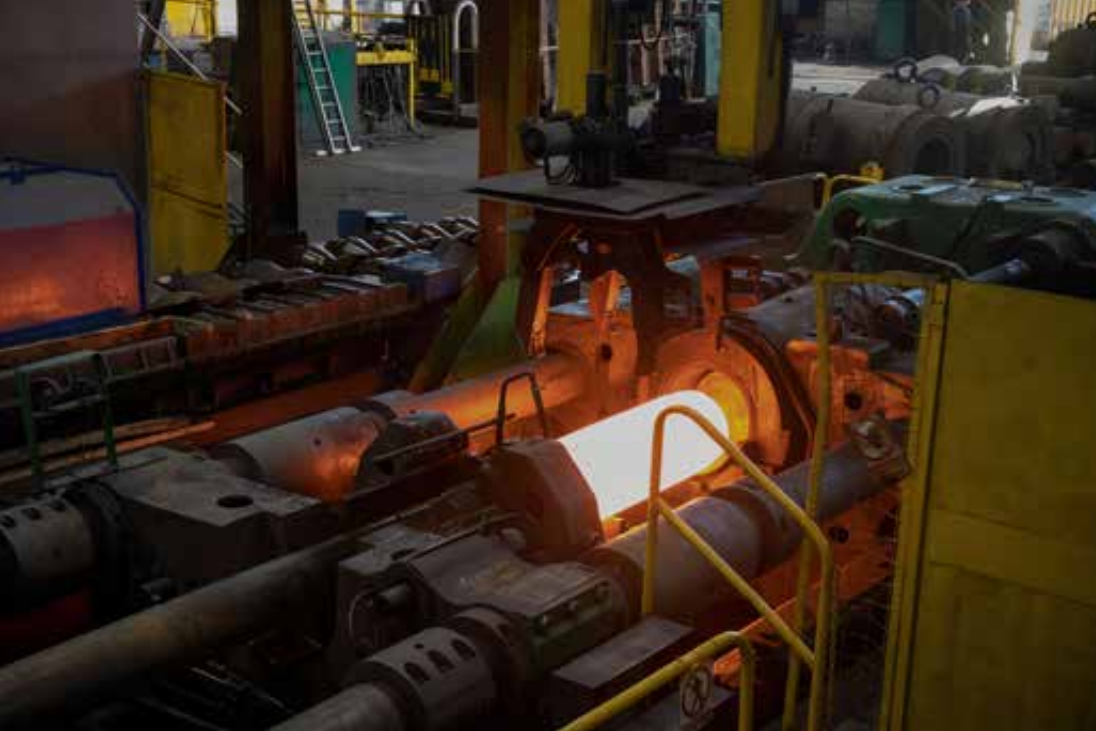
Powyżej: prasa przed przebicciem wlewka, 2023 rok, fot. Bernadeta Maksysz. Poniżej: widok na prasę od strony hali piątej, 2023 rok, fot. Piotr Rygus. Po prawej: manipulator odkładający szklankę na samotok przed prasą, 2023 rok, fot. Aleksandra Rygus.
