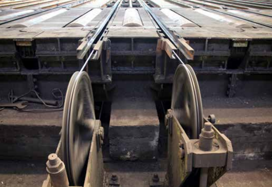
Powyżej: koła napinające liny przesuwacza blach w trakcie ruchu, 2023 rok, fot. Aleksandra Rygus. Poniżej i obok: przesuwacze blach pomiędzy halami, 2023 rok, fot. Piotr Rygus.
