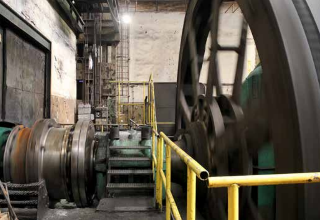
Powyżej: sprzęgło Leonard oraz koło zamachowe napędu walcarki, 2023 rok, fot. Aleksandra Rygus. Poniżej: fragment stycznikowni, 2023 rok, fot. Bernadeta Maksysz.
