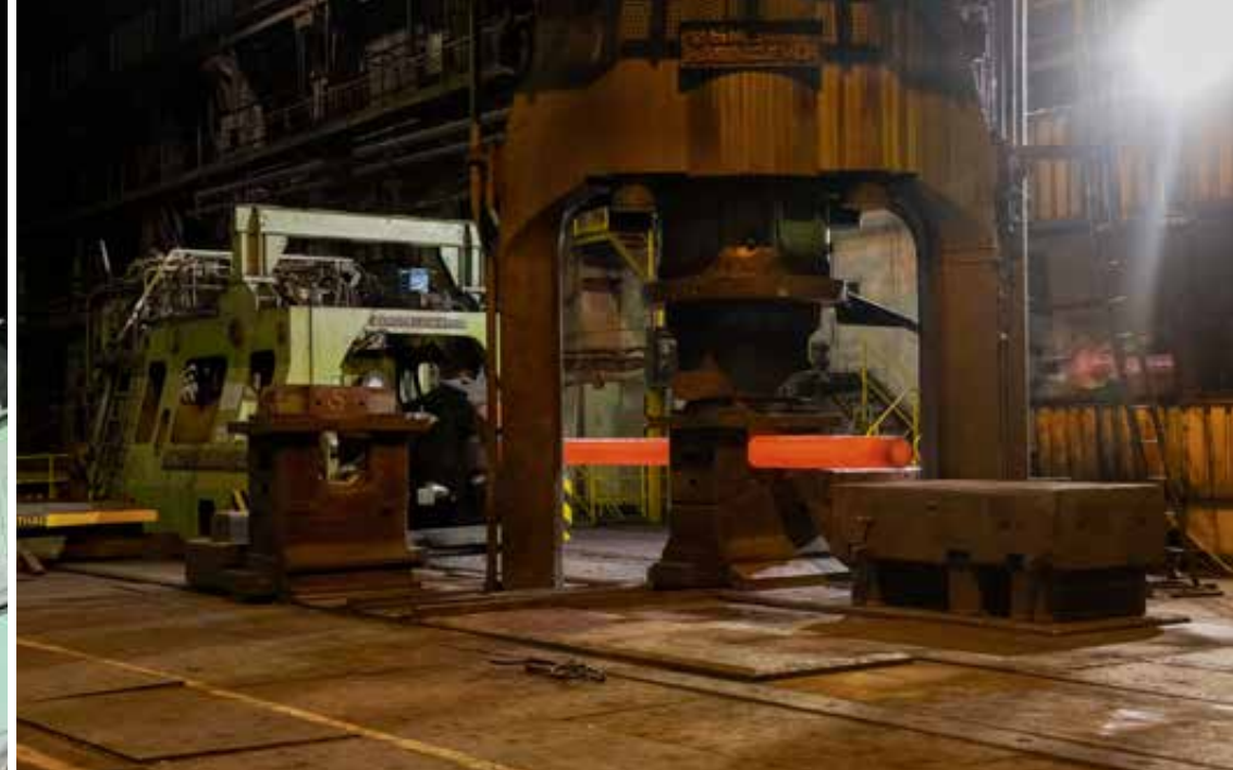
Po lewej: widok na prasę w trakcie kucia od strony kabiny sterowniczej, 2023 rok, fot. Piotr Rygus. Powyżej: kucie przy użyciu prasy 2000 t, 2023 rok, fot. Bernadeta Maksysz. Na dole: zakończenie kucia i przygotowanie gotowej odkuwki do transportu, fot. 2023 rok, fot. Bernadeta Maksysz.
