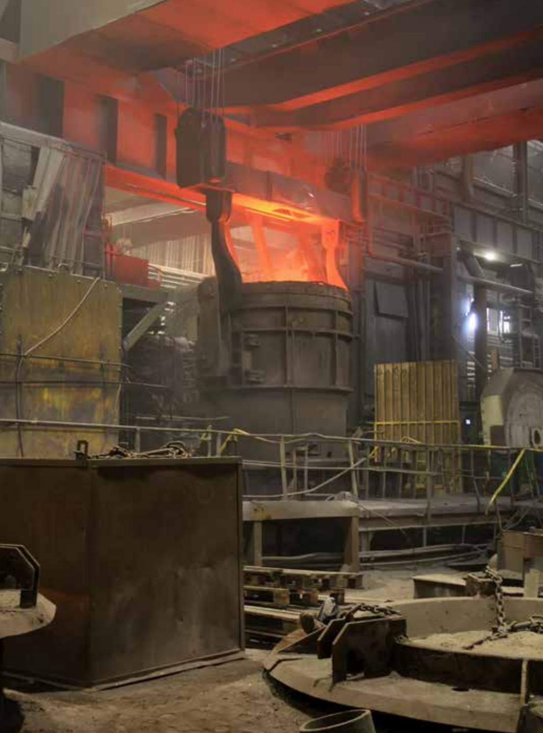
Transport kadzi odlewniczej przy użyciu suwnicy w obrębie hali lejniczej, 2023 rok, fot. Aleksandra Rygus.
