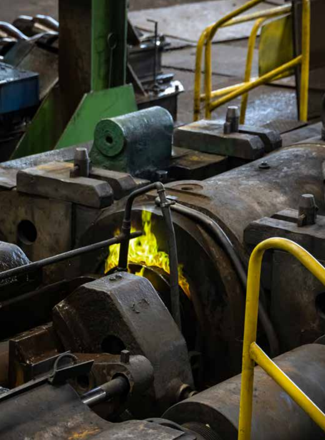
Powyżej: tłoczenie szklanki w prasie, 2023 rok, fot. Bernadeta Maksysz. Po prawej: walcowanie tulei w walcarce skośnej, 2023 rok, fot. Aleksandra Rygus.
