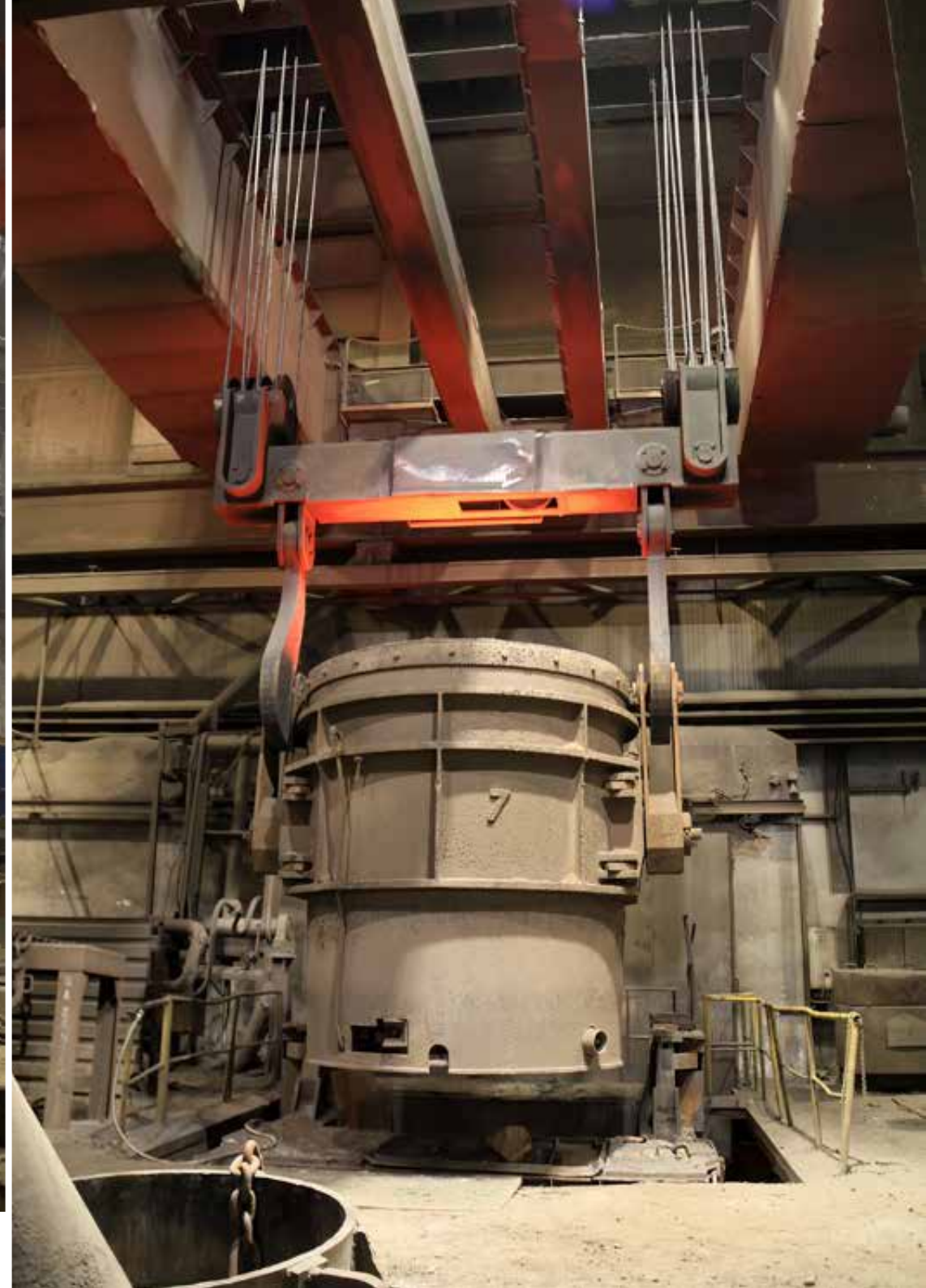
Transport kadzi odlewniczej przy użyciu suwnicy w obrębie hali lejniczej, 2023 rok, fot. Aleksandra Rygus.
