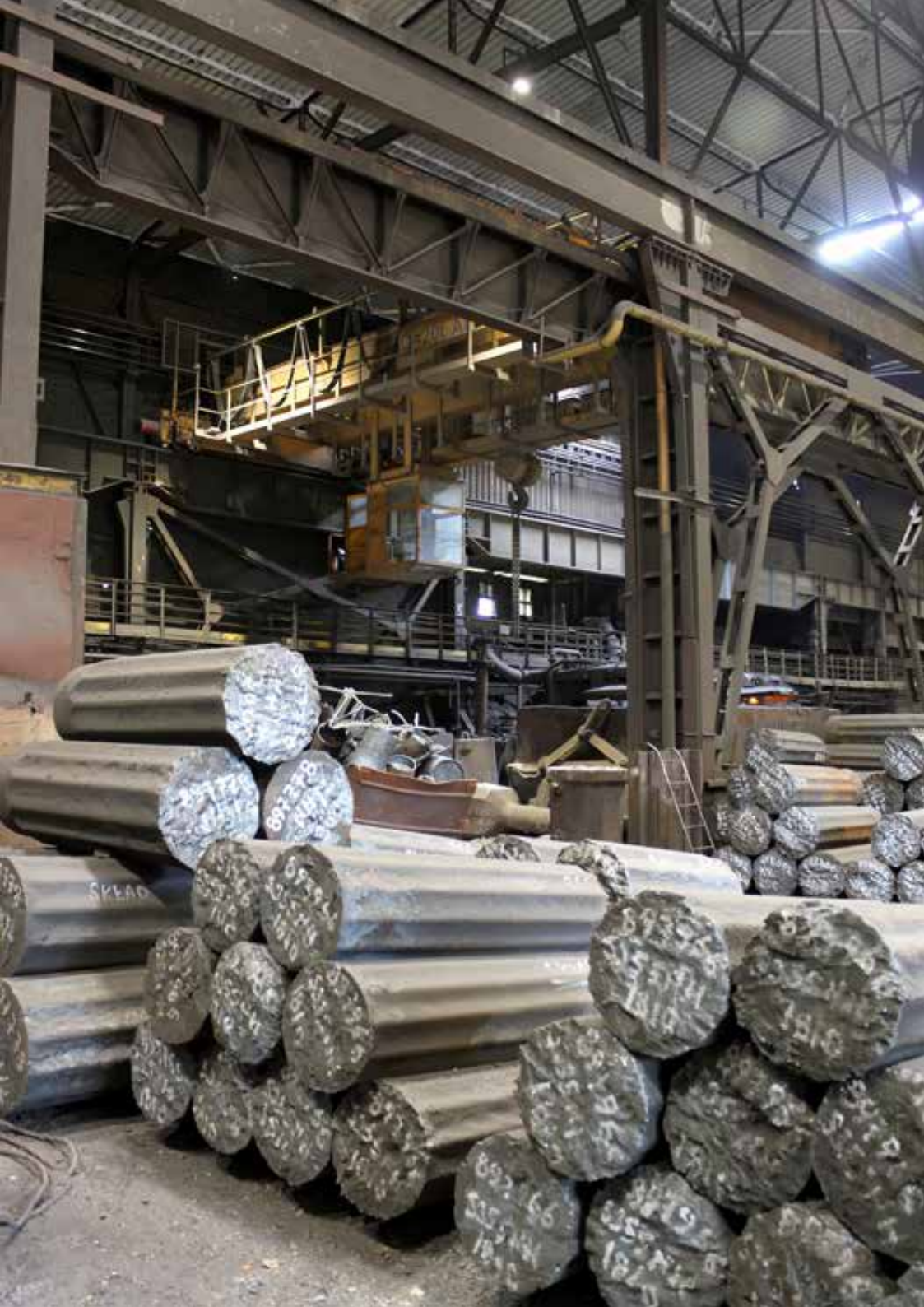
Po lewej: składowisko gotowych wlewków wykorzystywanych do walcownia rur bez szwu, 2023 rok, fot. Piotr Rygus.
