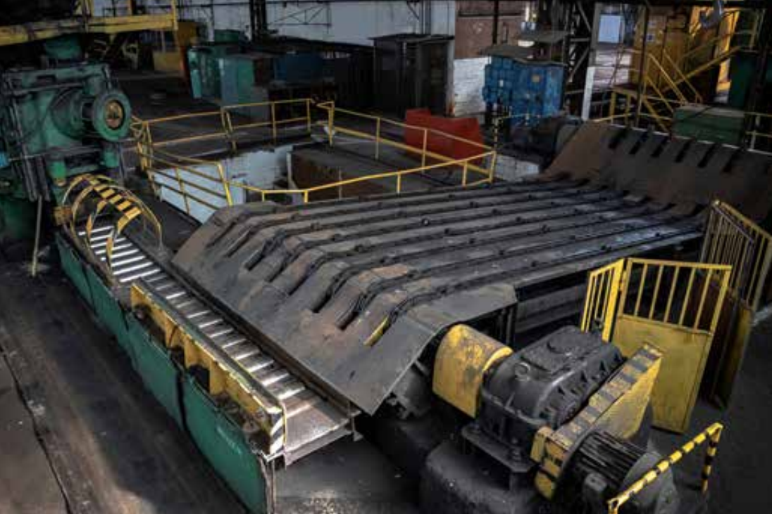
Powyżej: stół, po którym przesuwane są odcięte na gilotynach kawałki blach do nożycy złomowej, 2023 rok, fot. Bernadeta Maksysz. Poniżej: nożyca złomowa widziana od strony stołu podawczego, 2023 rok, fot. Piotr Rygus.
