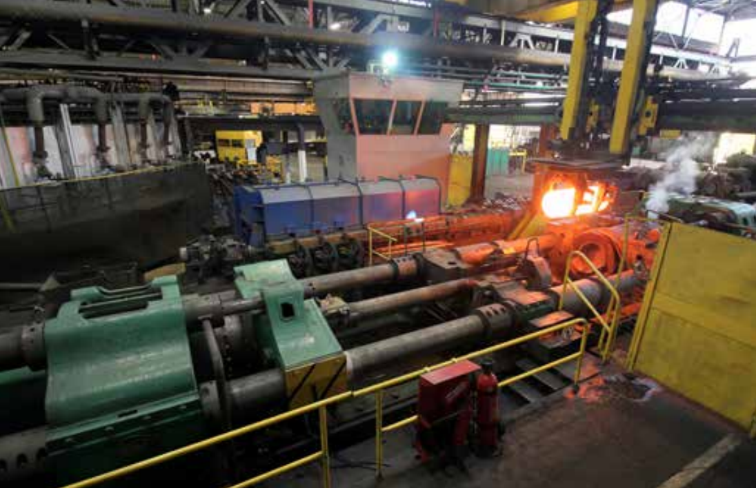
Na stronie nr 205: walcarka skośna w walcowni rur, 2023 rok, fot. Aleksandra Rygus. Powyżej: widok ogólny na prasę w walcowni rur podczas transportu wlewka przy użyciu manipulatora, 2023 rok, fot. Aleksandra Rygus. Poniżej: studzenie osprzętu prasy po przebicie kolejnej szklanki, 2023 rok, fot. Bernadeta Makszysz. Po prawej: moment po umieszczeniu przez manipulator wlewka w prasie, 2023 rok, fot. Aleksandra Rygus.
