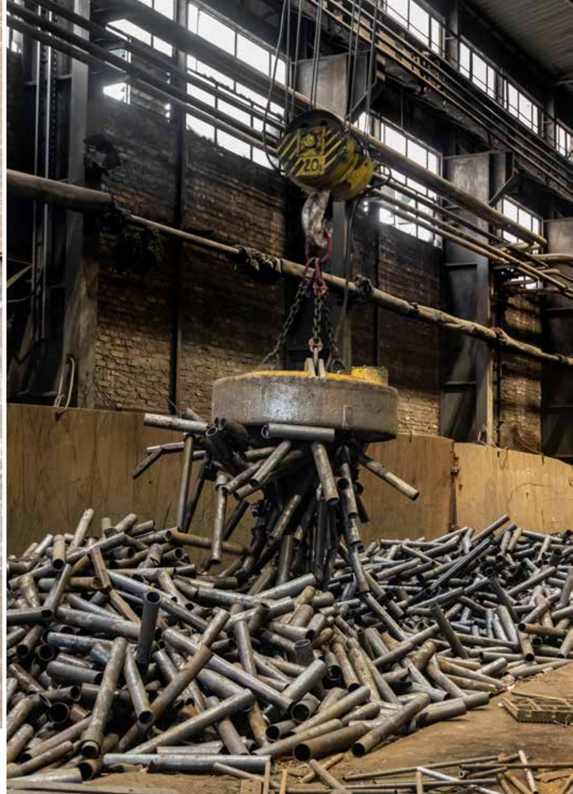
Powyżej: widok na halę pieca elektrycznego nr 5 od strony hali przygotowania złomu, 2023 rok, fot. Piotr Rygus; Po prawej: transport złomu przy użyciu elektromagnesu, 2023 rok, fot. Bernadeta Maksysz.
