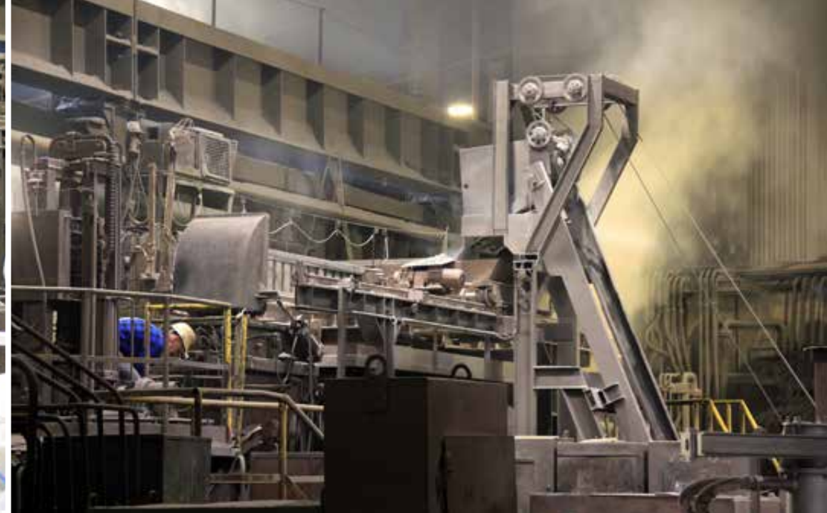
Powyżej: przenośnik kubełkowy z ciągiem transportowym dodatków stopowych do urządzeń obróbki pozapiecowej stali, 2023 rok, fot. Aleksandra Rygus. Poniżej: jedno ze składowisk wlewków gotowych, 2023 rok, fot. Bernadeta Maksysz.
