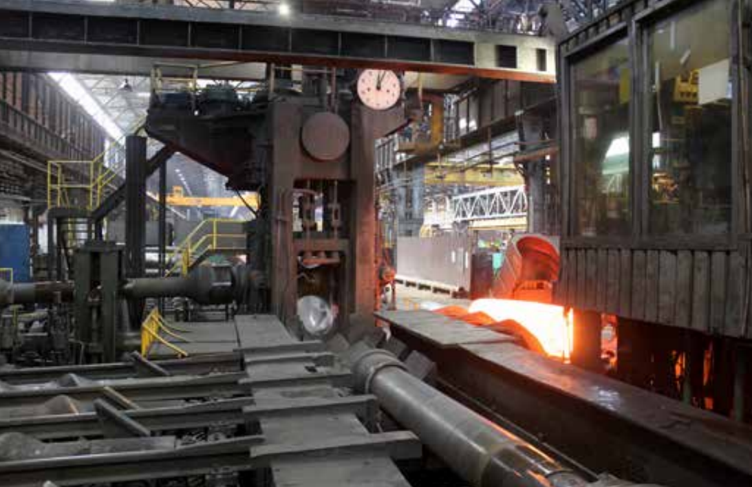
Powyżej: widok na stojak walcarki pielgrzymowej od strony obiegu trzpieni. Moment przed podaniem tulei do walcowania, 2023 rok, fot. Piotr Rygus. Poniżej: widok na stojak walcarki pielgrzymowej od strony piły, 2023 rok, fot. Aleksandra Rygus. Po prawej: widok na walcarkę pielgrzymową w trakcie walcowania od strony przekładni głównej, 2023 rok, fot. Piotr Rygus.
