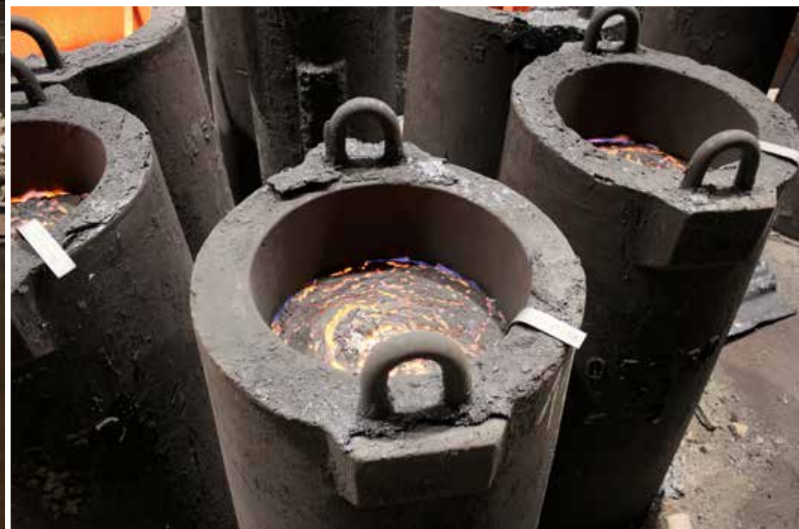
Po lewej: suwnica z kadzią wypełnioną płynną stalą w rejonie dołów lejniczych, 2023 rok, fot. Bernadeta Maksysz. Powyżej: wlewnice wypełnione stalą, 2023 rok, fot. Bernadeta Maksysz. Na dole: stygnąca stal we wlewnicach, 2023 rok, fot. Piotr Rygus.
