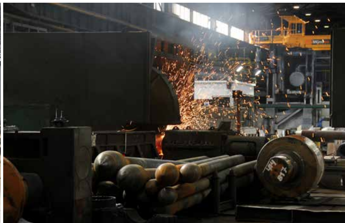
Poniżej: piła saniowa do cięcia rur na gorąco, 2023 rok, fot. Aleksandra Rygus.
