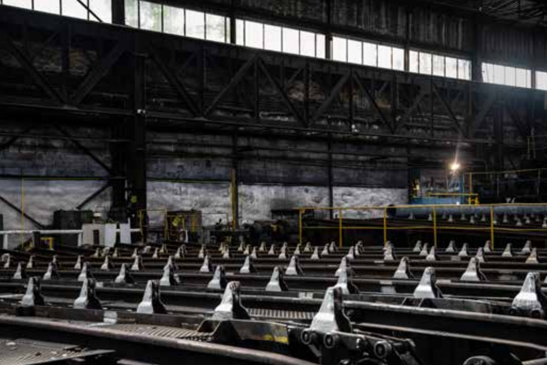
Powyżej: chłodnie służące do wystudzania rur po kalibrowaniu, 2023 rok, fot. Bernadeta Maksysz. Poniżej: składowisko walców. Na pierwszym planie widoczne są dmuchawy do studzenia wnętrza wygaszonego pieca, 2023 rok, fot. Aleksandra Rygus.
