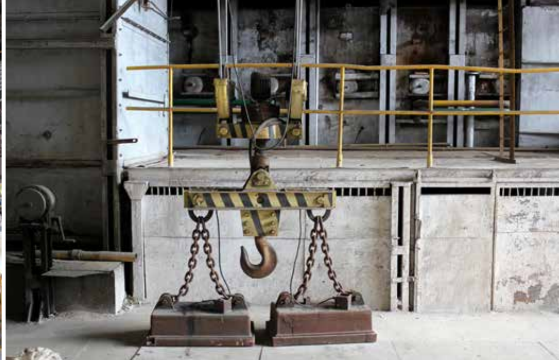
Powyżej: chwytnik elektromagnesowy wykorzystywany do transportu wlewków, 2023 rok, fot. Piotr Rygus. Poniżej: boczna ściana pieca przepychowego, 2023 rok, fot. Aleksandra Rygus.
