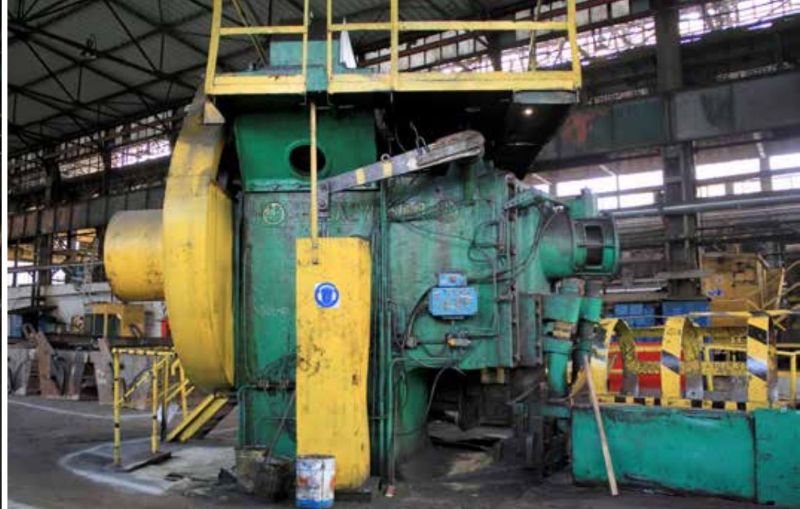
Powyżej: widok nożycy złomowej służącej do cięcia odpadowych krawędzi blach na mniejsze kawałki, 2023 rok, fot. Aleksandra Rygus. Poniżej: fragment hali z dwoma nożycami złomowymi. Na zdjęciu widoczna jedna z nich, 2023 rok, fot. Piotr Rygus.
