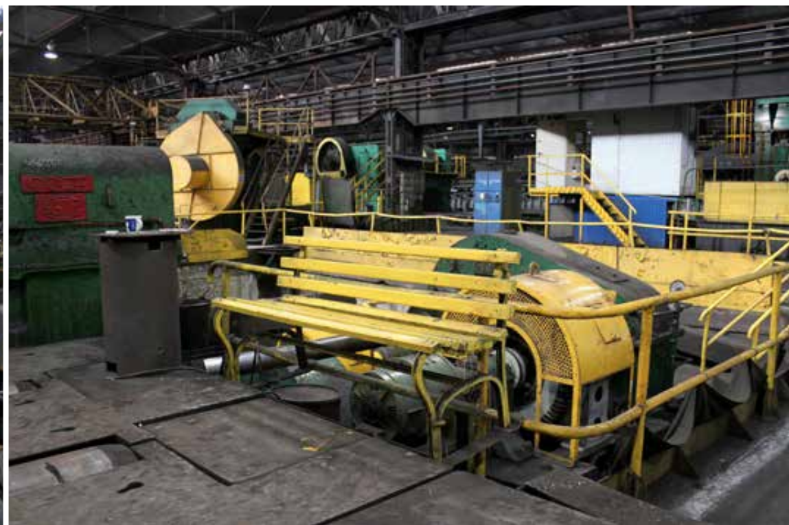
Nożyca krążkowa do obcinania bocznych krawędzi blach, 2023 rok. Powyżej: fot. Aleksandra Rygus, poniżej: fot. Piotr Rygus.
