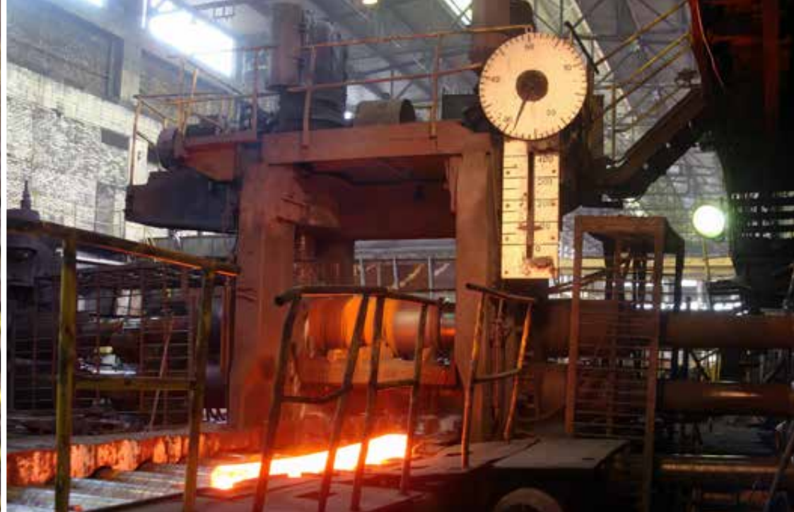
Powyżej: walcarka wstępna w walcowni \varnothing 650 wydziału walcowni bruzdowej, 2008 rok, fot. Piotr Rygus. Poniżej: jedna z kłatek walcowniczych w walcowni \varnothing 650 wydziału walcowni bruzdowej, 2008 rok, fot. Piotr Rygus. Po lewej: samotak łączący piec obrotowy z linią walcowniczą w walcowni \varnothing 650 wydziału walcowni bruzdowej, 2008 rok, fot. Piotr Rygus.
