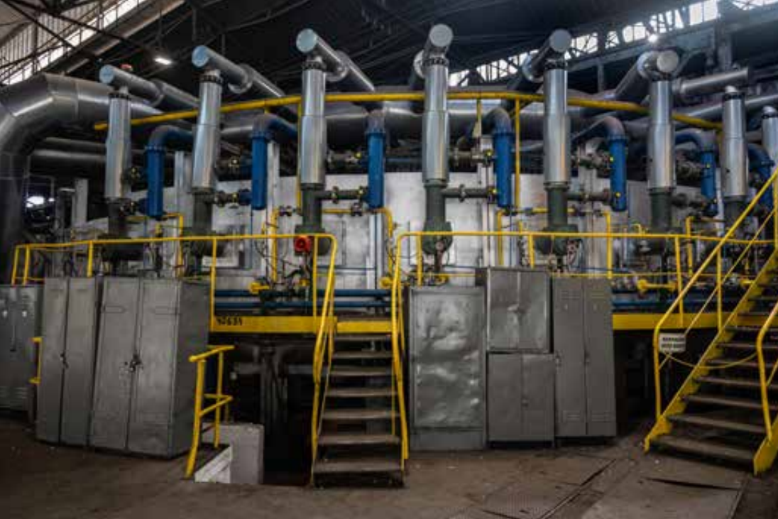
Powyżej: fragment pieca obrotowego w walcowni rur, 2023 rok, fot. Bernadeta Maksysz. Poniżej: moment wyjmowania gorącego wlewka z pieca obrotowego, 2023 rok, fot. Piotr Rygus.
