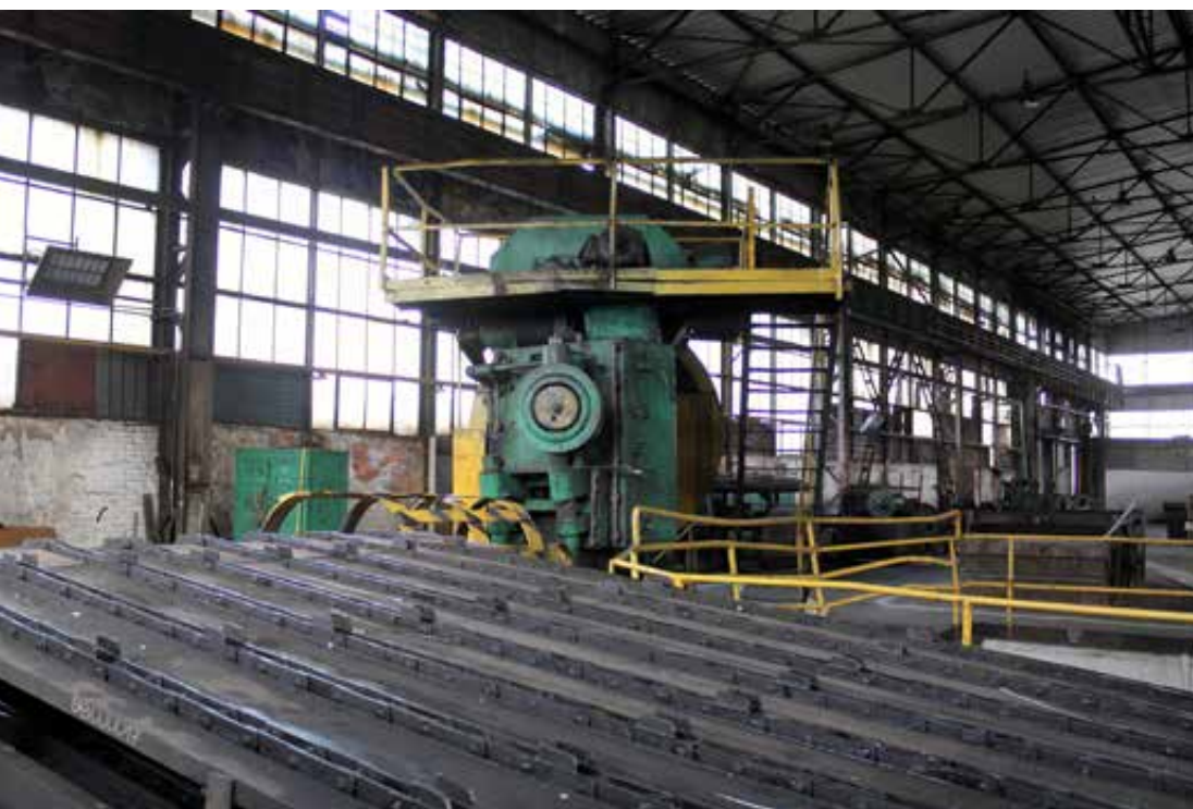
Powyżej: stół, po którym przesuwane są odcięte na gilotynach kawałki blach do nożycy złomowej, 2023 rok, fot. Bernadeta Maksysz. Poniżej: nożyca złomowa widziana od strony stołu podawczego, 2023 rok, fot. Piotr Rygus.
