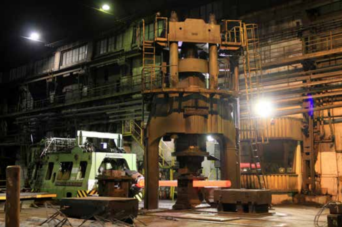
Powyżej: widok ogólny na prasę 2000 t wraz z manipulatorem podczas kucia, 2023 rok, fot. Aleksandra Rygus; Poniżej: początek kucia, 2023 rok, fot. Aleksandra Rygus. Po prawej: widok na prasę od strony bramy wjazdowej do hali, 2023 rok, fot. Piotr Rygus.
