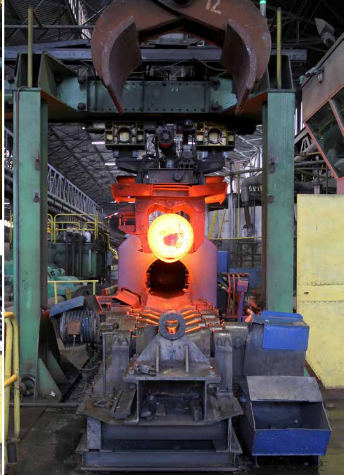
Powyżej: prasa przed przebicciem wlewka, 2023 rok, fot. Bernadeta Maksysz. Poniżej: widok na prasę od strony hali piątej, 2023 rok, fot. Piotr Rygus. Po prawej: manipulator odkładający szklankę na samotok przed prasą, 2023 rok, fot. Aleksandra Rygus.
