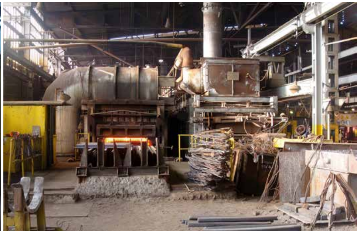
Powyżej: jedna z linii walcowniczych walcowni średnio-drobnej, 2008 rok, fot. Piotr Rygus. Poniżej: piec pokroczny do podgrzewania wlewków przed walcowaniem. Widok od okna załadunkowego, 2008 rok, fot. Piotr Rygus.
