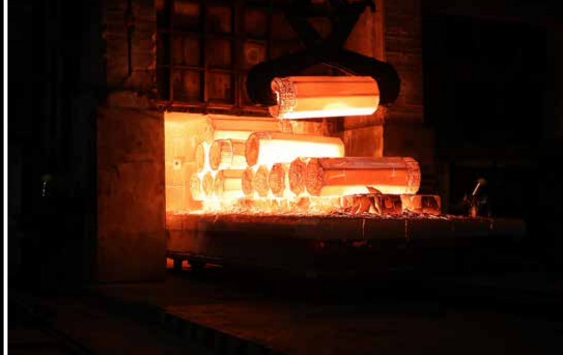
Wyjmowanie wlewka z pieca o wysuwным trzonie, 2023 rok. Powyżej fot. Bernadeta Maksysz, poniżej fot. Aleksandra Rygus.
