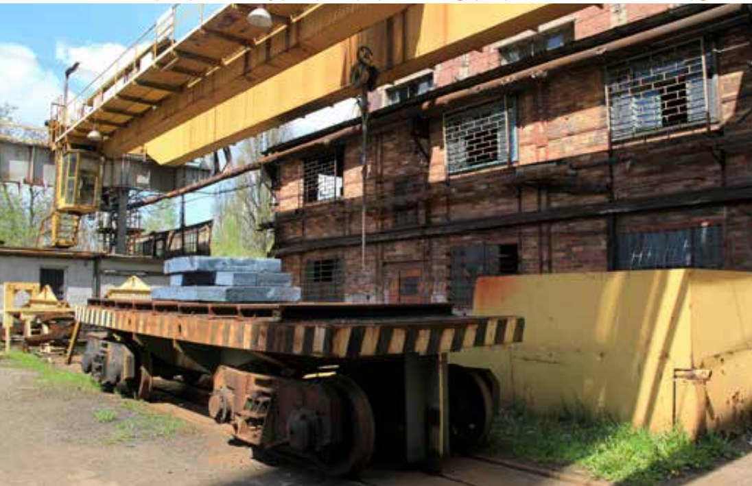
Powyżej: fragment składowiska wsadu walcowni blach grubych. W tle widoczna ściana szczytowa dawnego warsztatu Utrzymania Ruchu Suwnic, 2023 rok, fot. Piotr Rygus. Poniżej: suwnica i przerzutka służąca do transportu wlewków na placu wsadowym, 2023 rok, fot. Aleksandra Rygus. Po prawej: fragment składowiska wsadu. Na pierwszym planie wlewki do walcowania lane w osobnych wlewnicach tzw. bramach. Na ostatnim planie widoczne kominy odprowadzające spaliny z pieców węglanych, 2023 rok, fot. Piotr Rygus.
