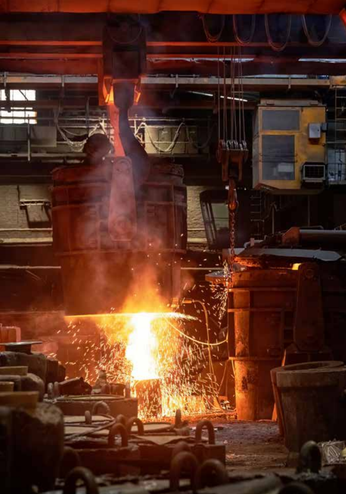
Spust stali z kadzi do wlewnic, 2023 rok. Po lewej: fot. Bernadeta Maksysz. Powyżej i poniżej: fot. Aleksandra Rygus.
