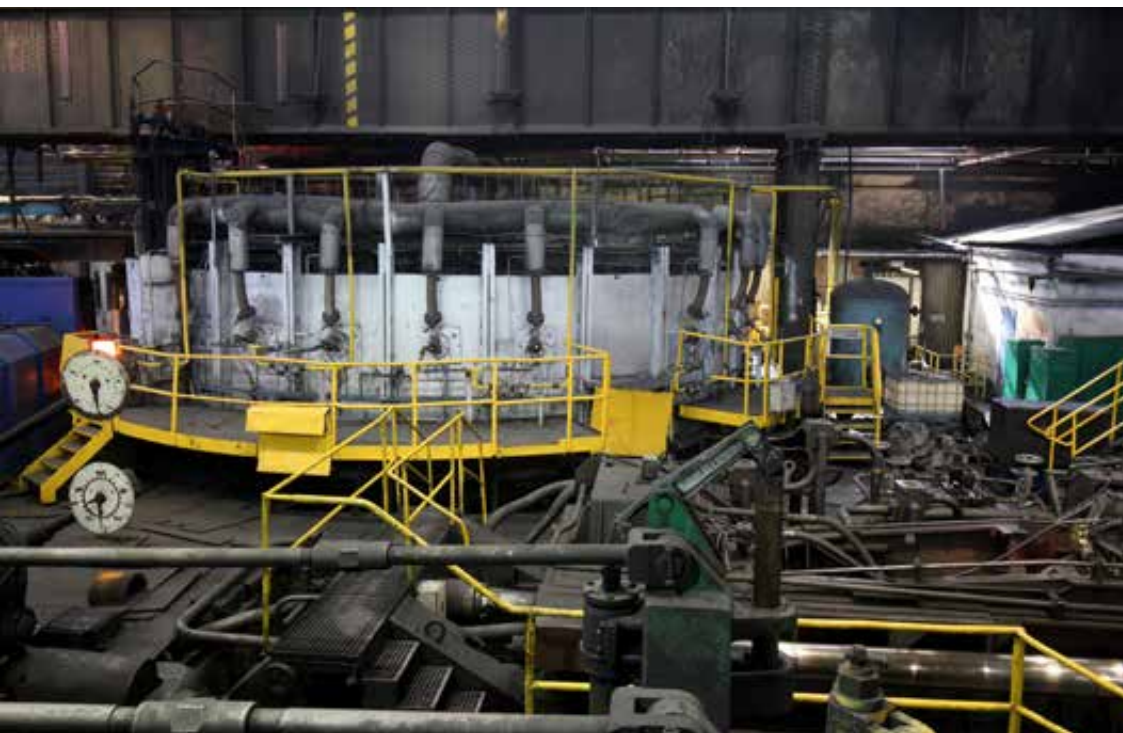
Powyżej: moment wyjmowania wlewka z pieca obrotowego, 2023 rok, fot. Aleksandra Rygus. Poniżej: widok ogólny pieca talerzowego w walcowni rur, 2023 rok, fot. Aleksandra Rygus.
