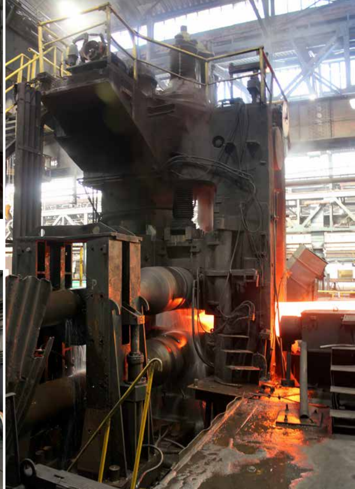
Powyżej: widok na stojak walcarki pielgrzymowej od strony obiegu trzpieni. Moment przed podaniem tulei do walcowania, 2023 rok, fot. Piotr Rygus. Poniżej: widok na stojak walcarki pielgrzymowej od strony piły, 2023 rok, fot. Aleksandra Rygus. Po prawej: widok na walcarkę pielgrzymową w trakcie walcowania od strony przekładni głównej, 2023 rok, fot. Piotr Rygus.
