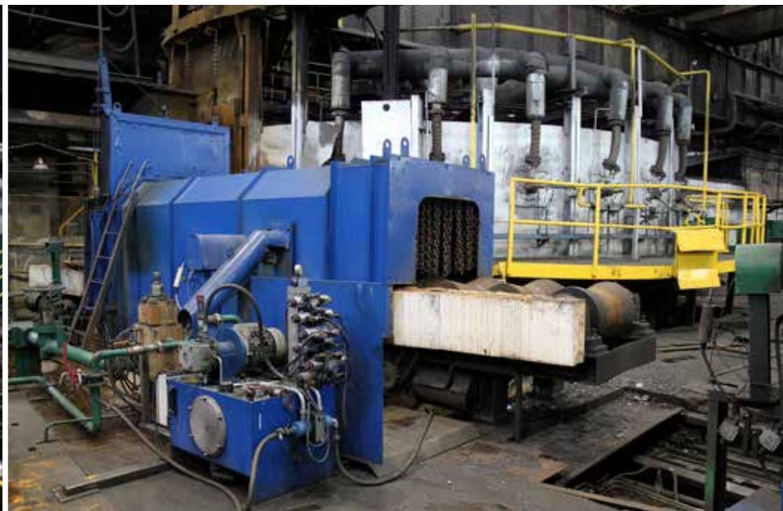
Powyżej: okno wsadowo-wysadowe pieca talerzowego, 2023 rok, fot. Aleksandra Rygus. Poniżej: jeden z odzendorowaczy przy piecu talerzowym w walcowni rur, 2023 rok, fot. Aleksandra Rygus.
