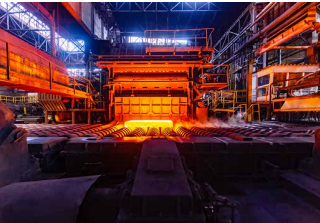
Transport rozgrzanego wlewka samotokiem w kierunku walcarki quarto, 2023 rok, fot. Paweł Suder.
