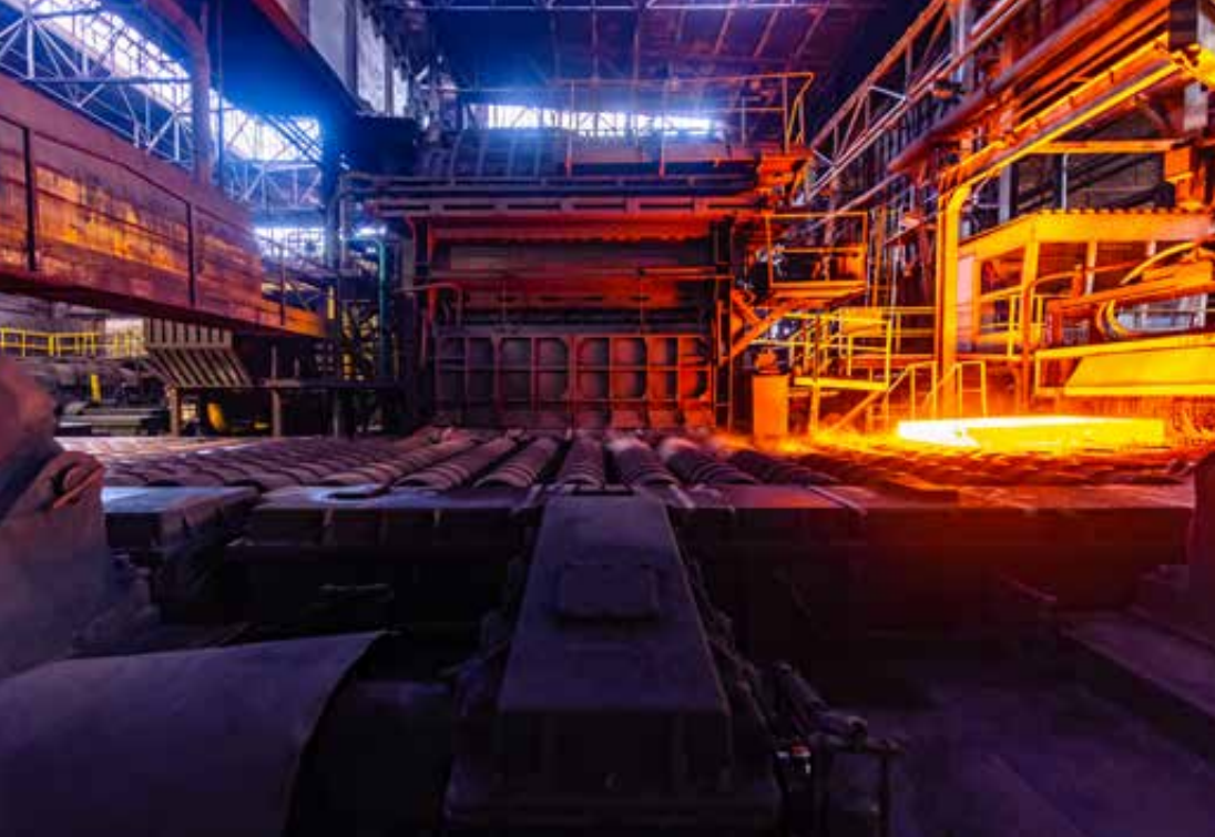
Transport rozgrzanego wlewka samotokiem w kierunku walcarki quarto, 2023 rok, fot. Paweł Suder.
