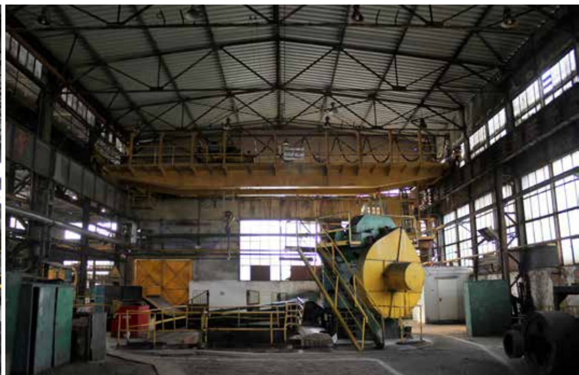
Powyżej: widok nożycy złomowej służącej do cięcia odpadowych krawędzi blach na mniejsze kawałki, 2023 rok, fot. Aleksandra Rygus. Poniżej: fragment hali z dwoma nożycami złomowymi. Na zdjęciu widoczna jedna z nich, 2023 rok, fot. Piotr Rygus.
