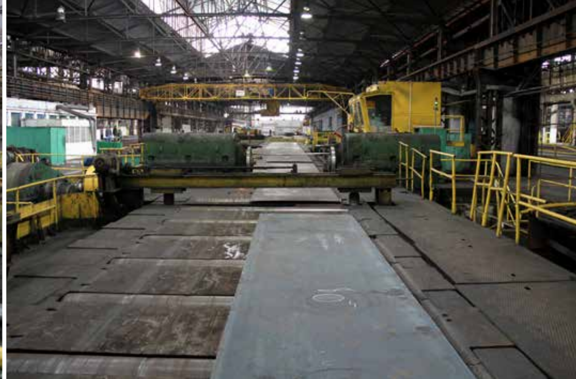
Nożyca krążkowa do obcinania bocznych krawędzi blach, 2023 rok. Powyżej: fot. Aleksandra Rygus, poniżej: fot. Piotr Rygus.
