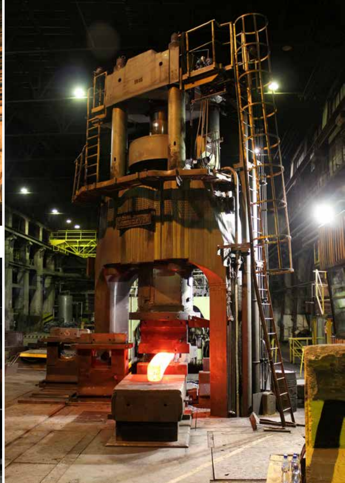
Powyżej: widok ogólny na prasę 2000 t wraz z manipulatorem podczas kucia, 2023 rok, fot. Aleksandra Rygus; Poniżej: początek kucia, 2023 rok, fot. Aleksandra Rygus. Po prawej: widok na prasę od strony bramy wjazdowej do hali, 2023 rok, fot. Piotr Rygus.
