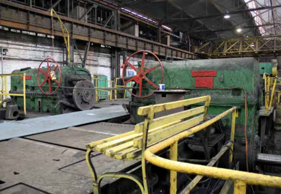
Nożyca krążkowa do obcinania bocznych krawędzi blach, 2023 rok. Powyżej: fot. Aleksandra Rygus, poniżej: fot. Piotr Rygus.
