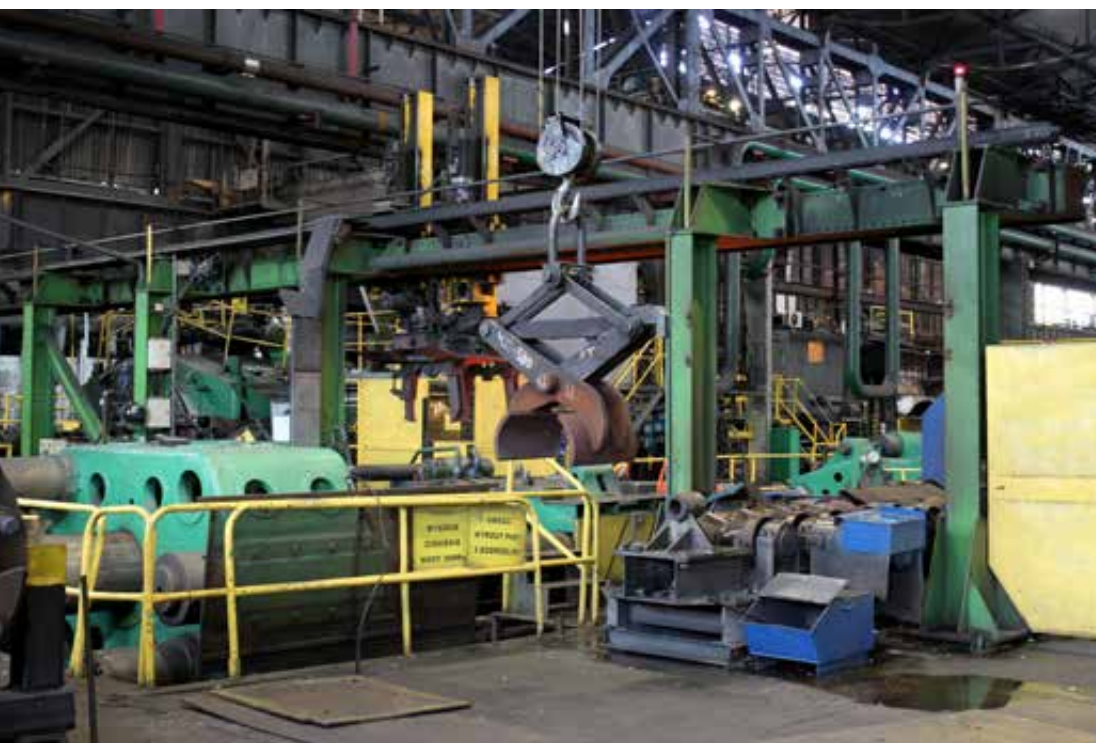
Powyżej: prasa przed przebicciem wlewka, 2023 rok, fot. Bernadeta Maksysz. Poniżej: widok na prasę od strony hali piątej, 2023 rok, fot. Piotr Rygus. Po prawej: manipulator odkładający szklankę na samotok przed prasą, 2023 rok, fot. Aleksandra Rygus.
