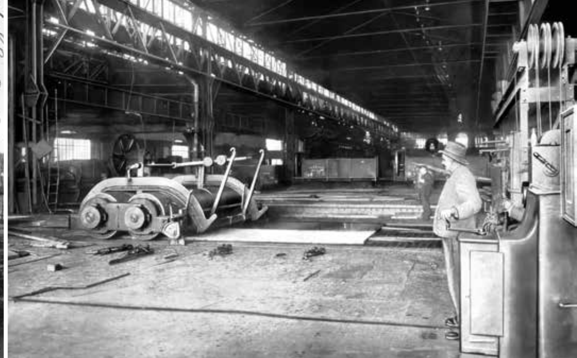
Powyżej: piec wstępny w walcowni blach grubych, lata 20. XX wieku, Śląska Biblioteka Cy- frowa. Poniżej: fragment jednej z hal kuźni. Po prawej widoczna prasa, a po lewej w tle młot kuźniczy, lata 20. XX wieku, Śląska Biblioteka Cyfrowa.
