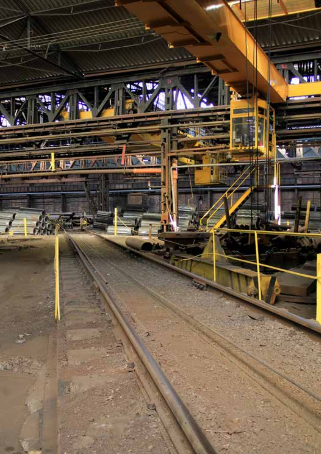
Powyżej: hala wsadu walcowni rur, 2023 rok, fot. Aleksandra Rygus. Poniżej: fragment hali czwartej walcowni rur. Na pierwszym planie widoczny stół z wlewkami przed załadunkiem do pieca obrotowego. Na dalszym planie: suwnica łańcuchowa służąca do transportu gotowych rur, 2023 rok, fot. Bernadeta Maksysz. Po lewej: tory przerzutki służącej do transportu wlewków z hali wsadu w rejon pieca obrotowego, 2023 rok, fot. Aleksandra Rygus.
