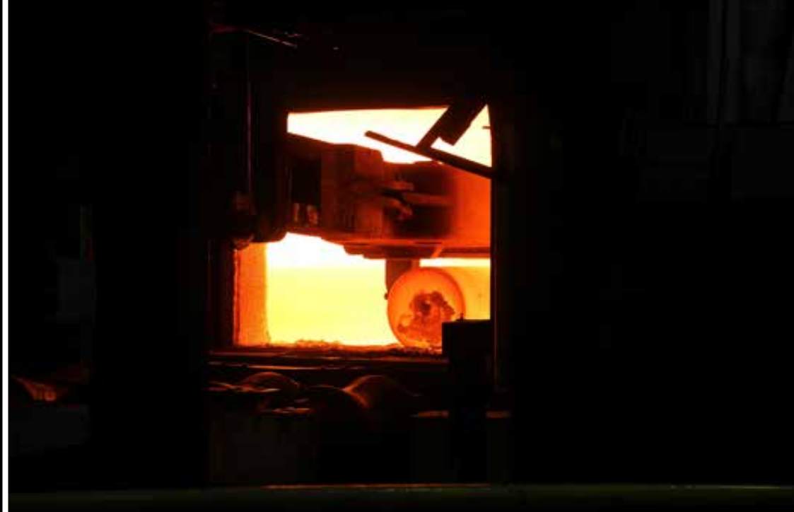
Powyżej: okno wsadowo-wysadowe pieca talerzowego, 2023 rok, fot. Aleksandra Rygus. Poniżej: jeden z odzendorowaczy przy piecu talerzowym w walcowni rur, 2023 rok, fot. Aleksandra Rygus.
