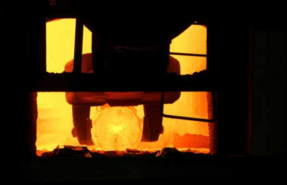
Powyżej: moment wyjmowania wlewka z pieca obrotowego, 2023 rok, fot. Aleksandra Rygus. Poniżej: widok ogólny pieca talerzowego w walcowni rur, 2023 rok, fot. Aleksandra Rygus.
