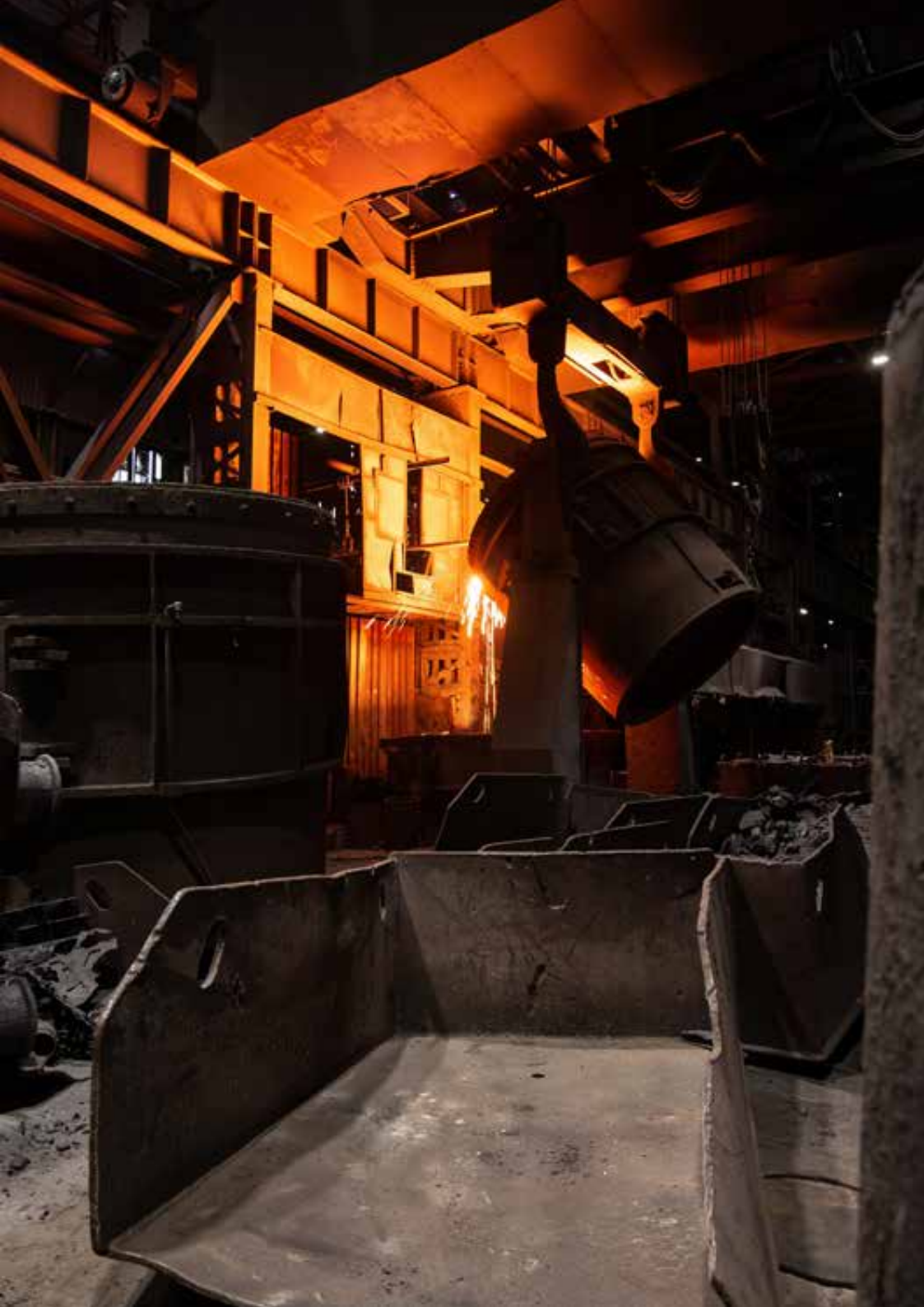
Po lewej: usuwanie żużla z kadzi odlewniczej, 2023 rok, fot. Bernadeta Maksysz. Po- wyżej: fragment tzw. hali wentylacyjnej biegnącej wzdłuż hali lejniczej, 2023 rok, fot. Aleksandra Rygus.
