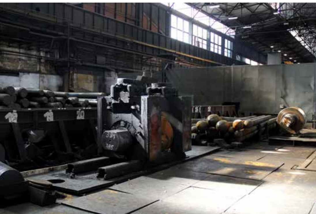
Powyżej: piła saniowa do cięcia rur na gorąco, 2023 rok, fot. Piotr Rygus. Poniżej: fragment hali szóstej w rejonie piły. Na zdjęciu widoczna m.in. górna wbudówka walcarki pielgrzymowej oraz osprzęt dla walcarek pielgrzymowej i skośnej, 2023 rok. Fot. Aleksandra Rygus.
