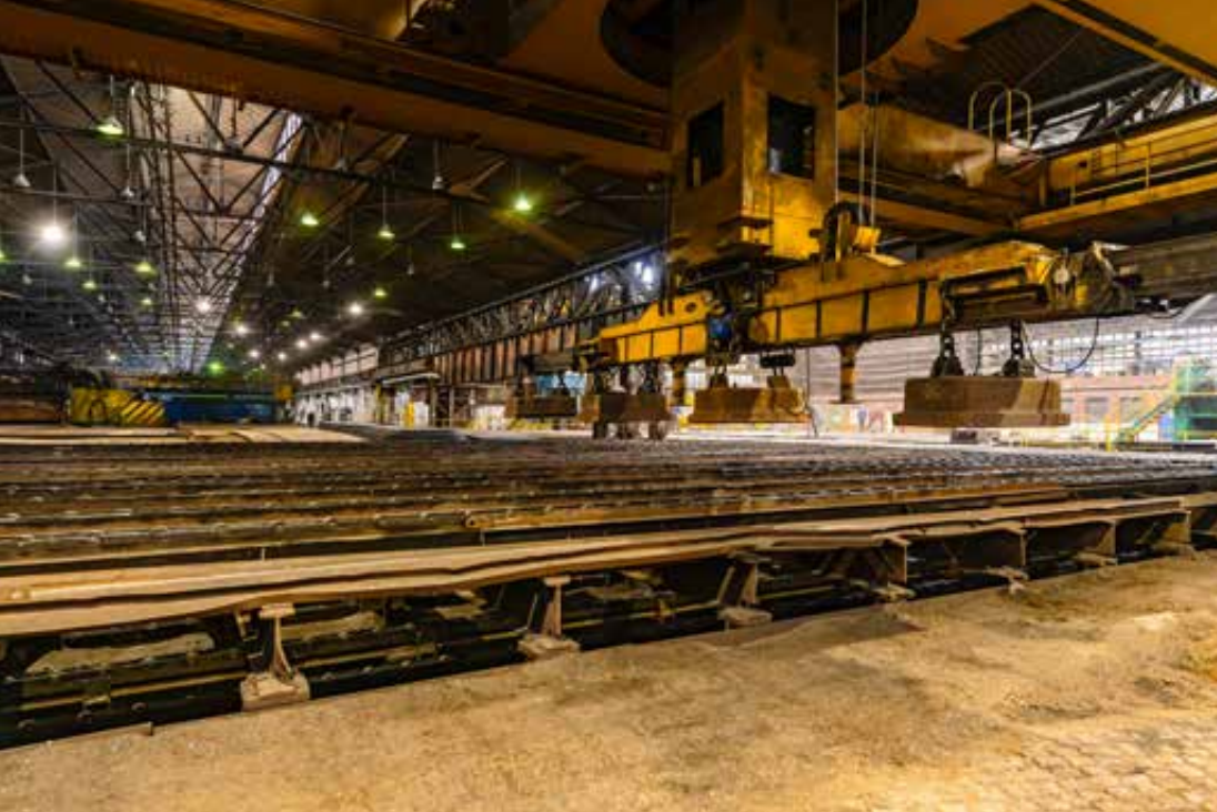
Powyżej: suwnica magnesowa nad chłodnią do blach, 2023 rok, fot. Paweł Suder Poniżej: suwnica magnesowa podczas pracy przy transporcie blach, 2023 rok, fot. Piotr Rygus.
