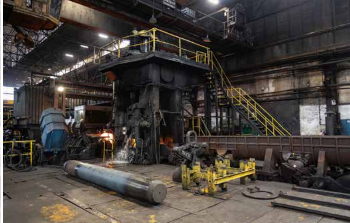
Powyżej: walcarka pielgrzymowa w walcowni rur, 2023 rok, fot. Bernadeta Maksysz. Poniżej: odznedrowacz przy walcarce pielgrzymowej wypływający wnętrze tulei przed walcowaniem, 2023 rok, fot. Bernadeta Maksysz. Po lewej: widok na stojak walcarki pielgrzymowej od strony odznedrowacza, 2023 rok, fot. Aleksandra Rygus.
