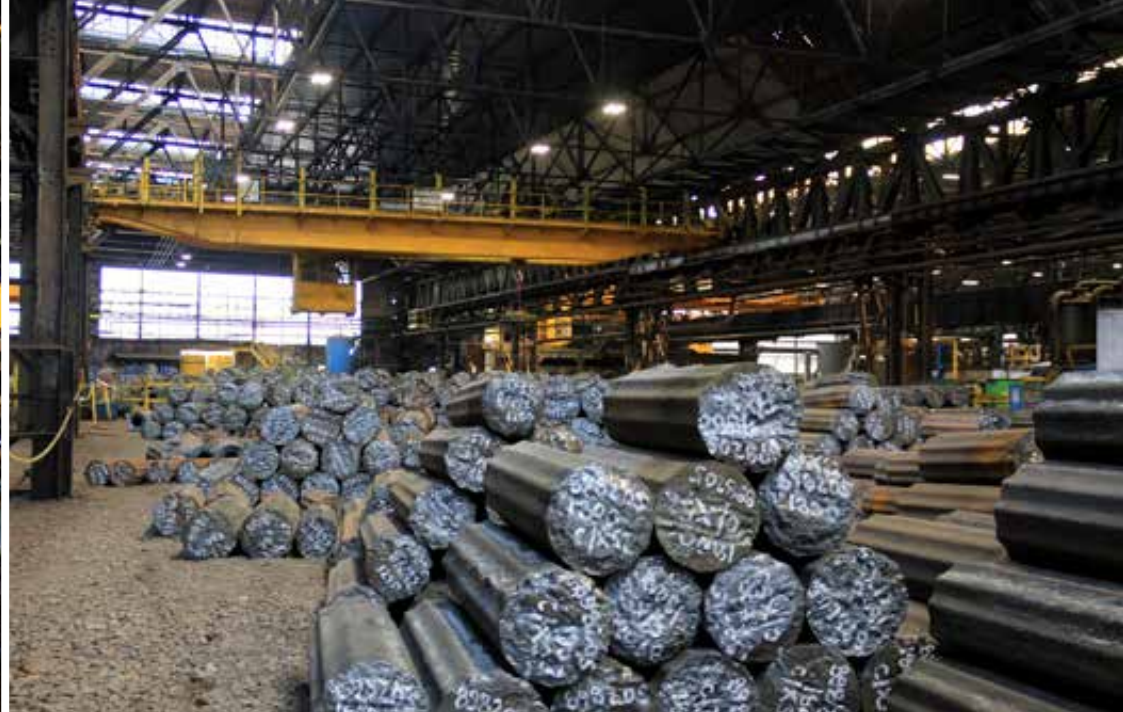
Powyżej: hala wsadu walcowni rur, 2023 rok, fot. Aleksandra Rygus. Poniżej: fragment hali czwartej walcowni rur. Na pierwszym planie widoczny stół z wlewkami przed załadunkiem do pieca obrotowego. Na dalszym planie: suwnica łańcuchowa służąca do transportu gotowych rur, 2023 rok, fot. Bernadeta Maksysz. Po lewej: tory przerzutki służącej do transportu wlewków z hali wsadu w rejon pieca obrotowego, 2023 rok, fot. Aleksandra Rygus.
