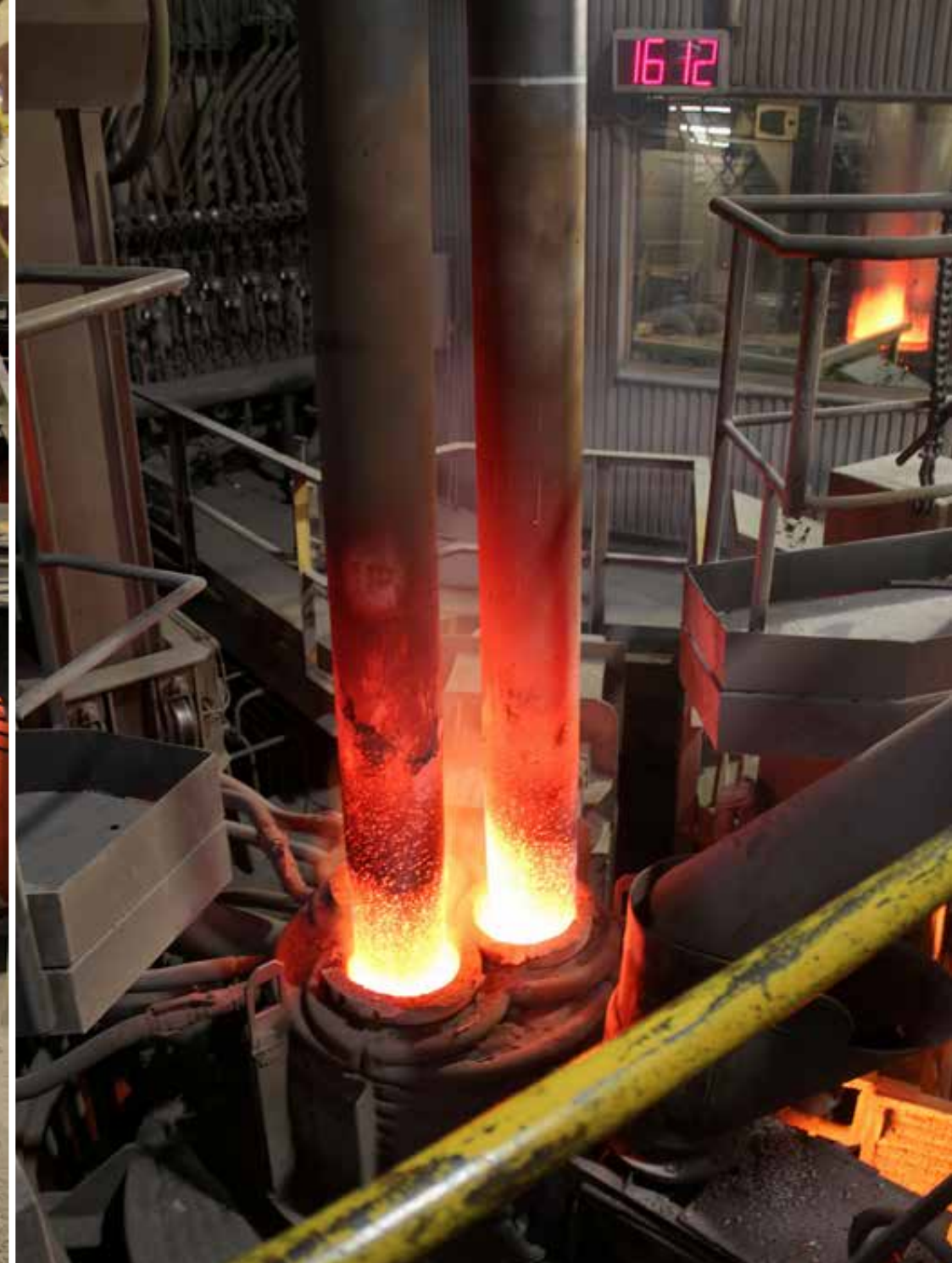
Po lewej: fragment instalacji do pozapiecowej obróbki stali, 2023 rok, fot. Aleksandra Rygus. Powyżej: elektrody podgrzewające płynną stal, 2023 rok, fot. Piotr Rygus.
