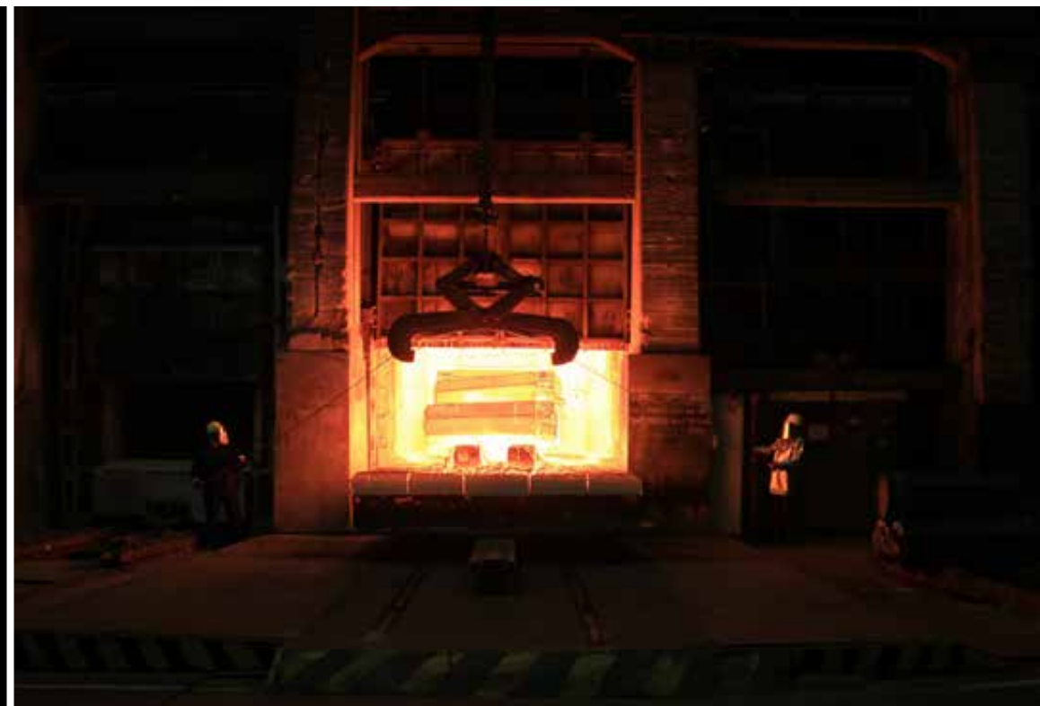
Wyjmowanie wlewka z pieca o wysuwным trzonie, 2023 rok. Powyżej fot. Bernadeta Maksysz, poniżej fot. Aleksandra Rygus.
