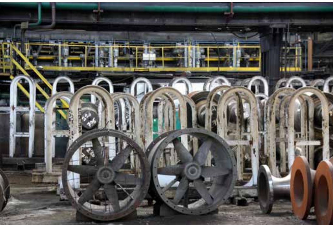
Powyżej: chłodnie służące do wystudzania rur po kalibrowaniu, 2023 rok, fot. Bernadeta Maksysz. Poniżej: składowisko walców. Na pierwszym planie widoczne są dmuchawy do studzenia wnętrza wygaszonego pieca, 2023 rok, fot. Aleksandra Rygus.
