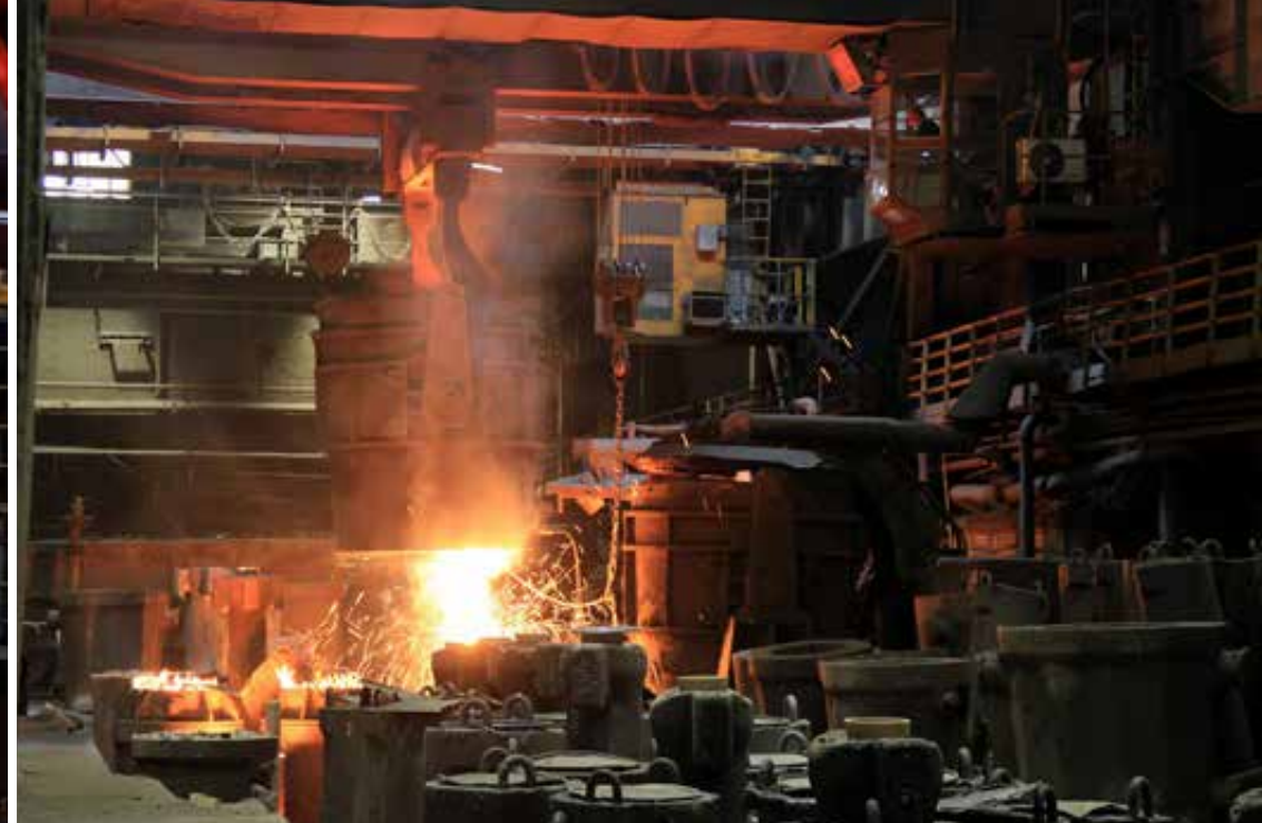
Spust stali z kadzi do wlewnic, 2023 rok. Po lewej: fot. Bernadeta Maksysz. Powyżej i poniżej: fot. Aleksandra Rygus.
