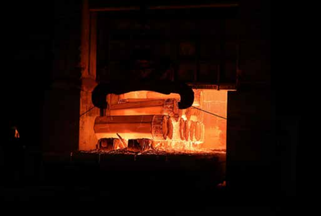
Wyjmowanie wlewka z pieca o wysuwным trzonie, 2023 rok. Powyżej fot. Bernadeta Maksysz, poniżej fot. Aleksandra Rygus.
