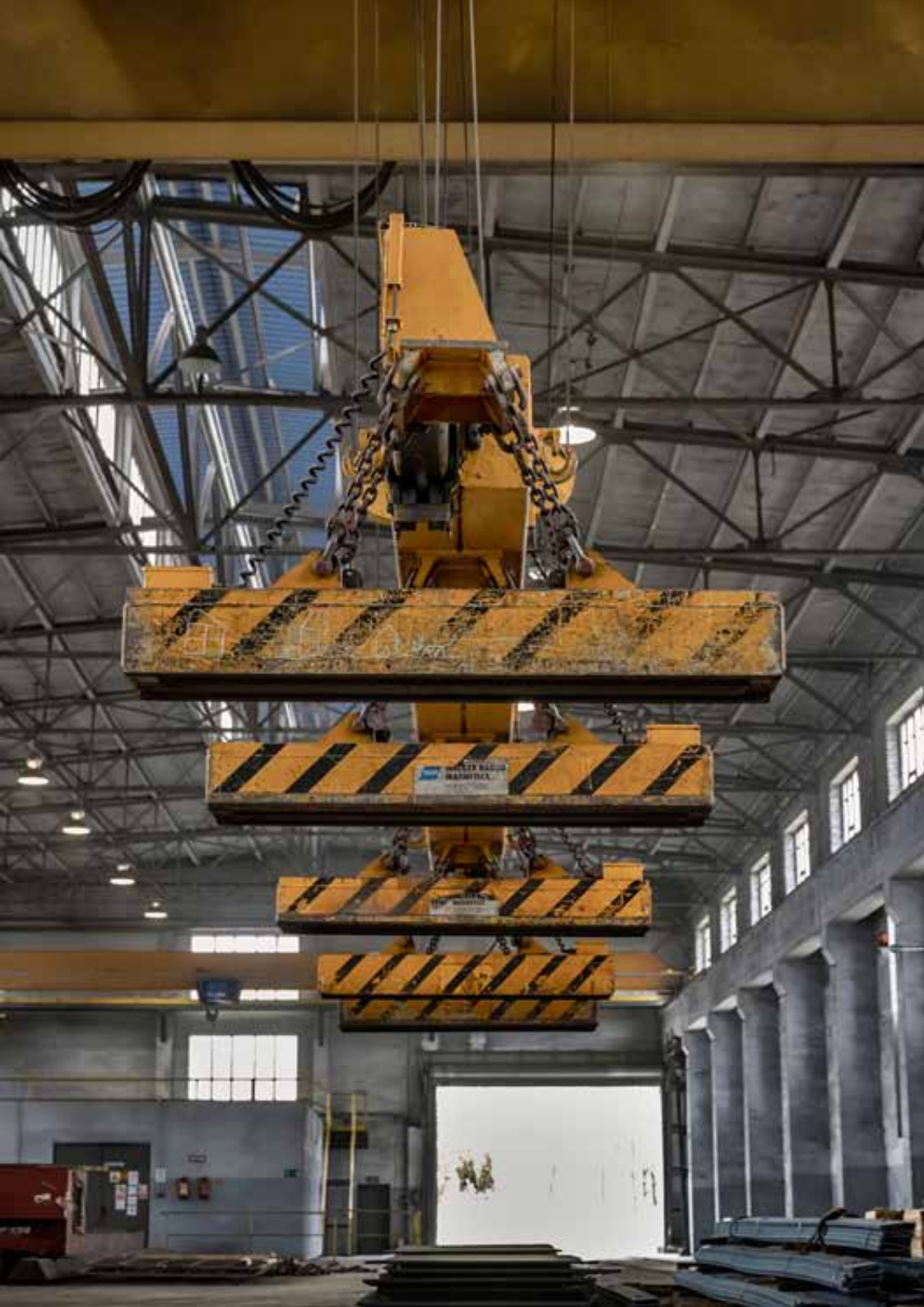
Powyżej: elewacja tzw. hali ósmej, należącej dawniej do wydziału stalowni, w której usuwano wady wlewków. Obecnie hala wykorzystywana jest przez spółkę Walcownia Blach Batory do obróbki wykańczającej blach, 2023 rok, fot. Piotr Rygus. Poniżej: wnętrze tzw. hali ósmej, 2023 rok, fot. Piotr Rygus. Po lewej: chwytaki elektromagnesowe do transportu blach zawieszane na jednej z suwnic w tzw. hali ósmej, 2023 rok, fot. Bernadeta Maksysz.
