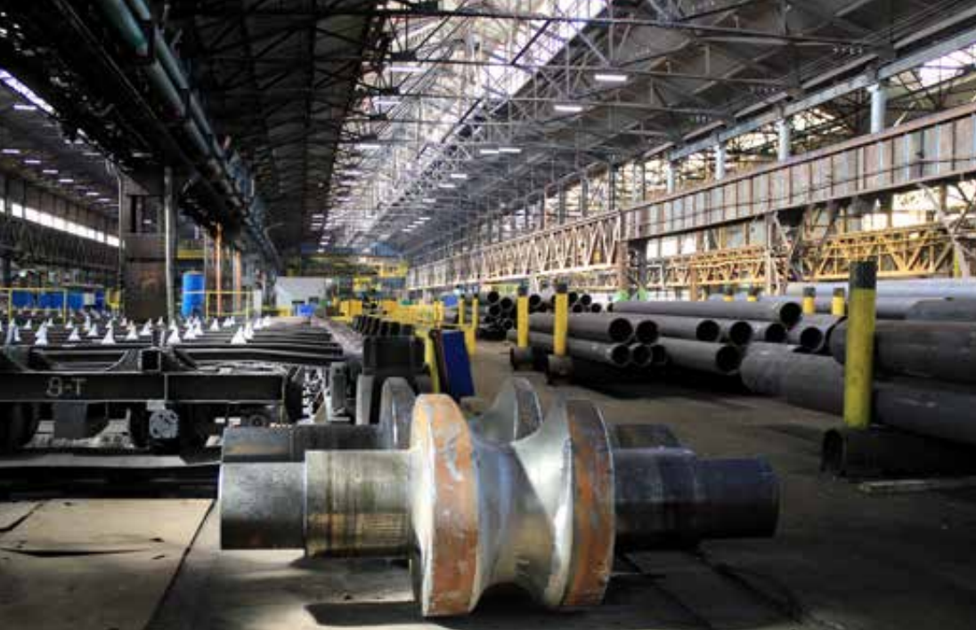
Powyżej: hala piąta na wysokości chłodni łańcuchowych. Na pierwszym planie widoczna para walców z walcarki pielgrzymowej, 2023 rok, fot. Aleksandra Rygus. Poniżej: widok na stojaki z gotowymi rurami oraz urządzenia wykańczalni znajdujące się w hali czwartej, 2023 rok, fot. Aleksandra Rygus. Po prawej: suwnica łańcuchowa oraz stojak z gotowymi rurami w hali czwartej, 2023 rok, fot. Aleksandra Rygus.
