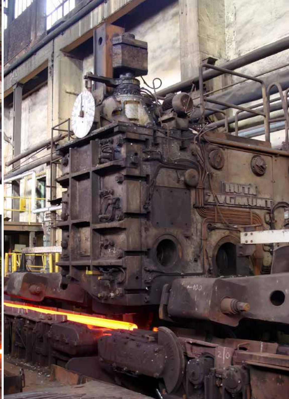
Powyżej i poniżej: produkcja w walcowni \varnothing 650 wydziału walcowni brzdowej, 2008 rok, fot. Piotr Rygus. Po prawej: nożyca do cięcia odwalcowanych kęsisk w walcowni \varnothing 650 wydziału walcowni brzdowej, 2008 rok, fot. Piotr Rygus.
