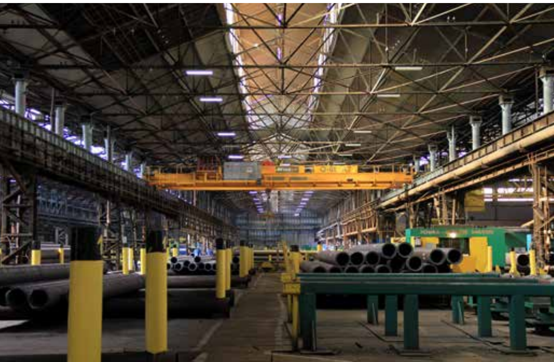
Powyżej: hala piąta na wysokości chłodni łańcuchowych. Na pierwszym planie widoczna para walców z walcarki pielgrzymowej, 2023 rok, fot. Aleksandra Rygus. Poniżej: widok na stojaki z gotowymi rurami oraz urządzenia wykańczalni znajdujące się w hali czwartej, 2023 rok, fot. Aleksandra Rygus. Po prawej: suwnica łańcuchowa oraz stojak z gotowymi rurami w hali czwartej, 2023 rok, fot. Aleksandra Rygus.
