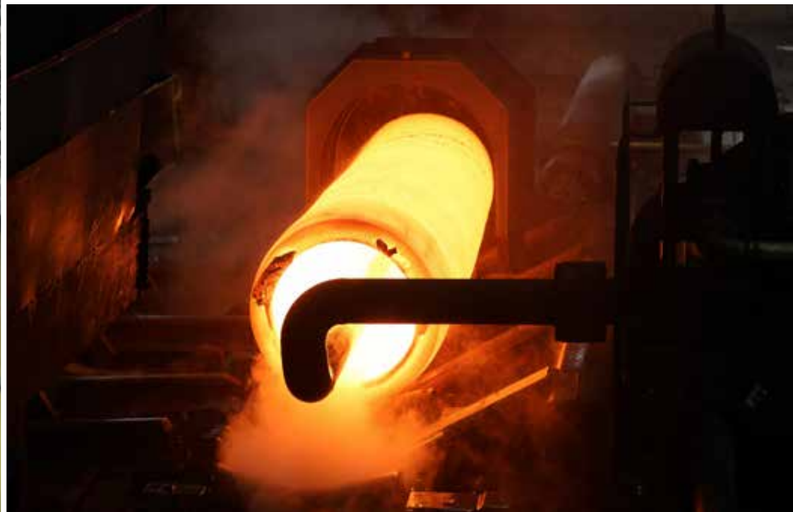
Powyżej: walcarka pielgrzymowa w walcowni rur, 2023 rok, fot. Bernadeta Maksysz. Poniżej: odznedrowacz przy walcarce pielgrzymowej wypływający wnętrze tulei przed walcowaniem, 2023 rok, fot. Bernadeta Maksysz. Po lewej: widok na stojak walcarki pielgrzymowej od strony odznedrowacza, 2023 rok, fot. Aleksandra Rygus.
