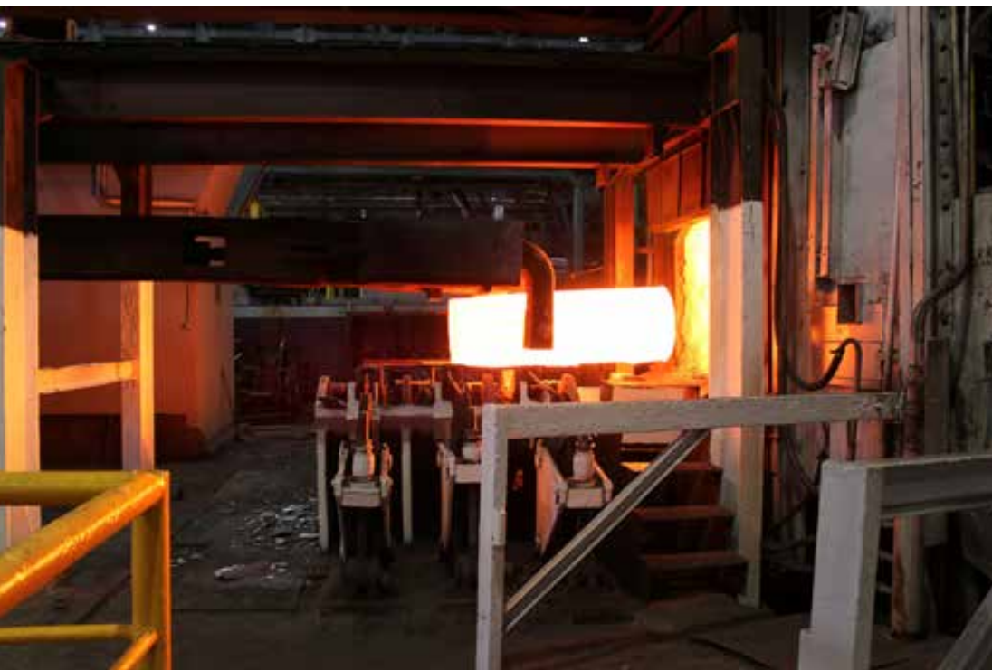
Powyżej: fragment pieca obrotowego w walcowni rur, 2023 rok, fot. Bernadeta Maksysz. Poniżej: moment wyjmowania gorącego wlewka z pieca obrotowego, 2023 rok, fot. Piotr Rygus.
