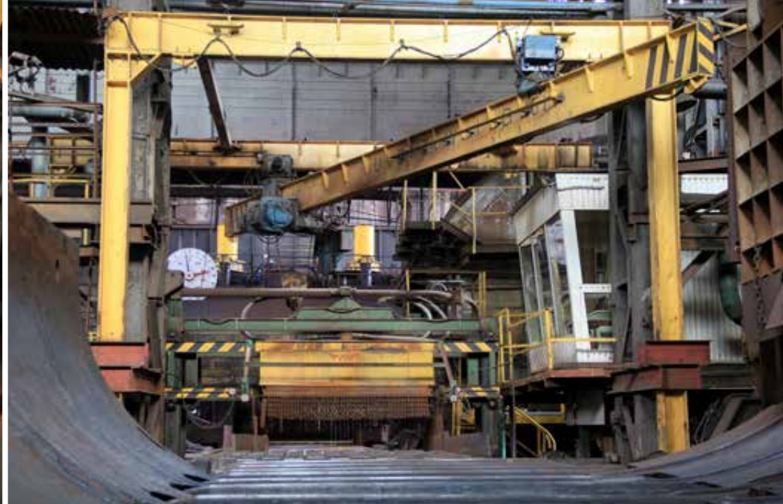
Powyżej: samotok doprowadzający wlewki do walcarki widziany od strony okna wysadowego pieca przepychowego, 2023 rok, fot. Aleksandra Rygus. Poniżej: wlewk trafiający w rejon odzędrowacza widziany od strony walcarki, 2023 rok, fot. Piotr Rygus.
