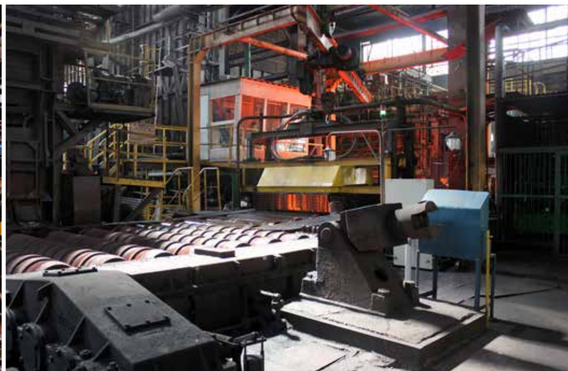
Powyżej: samotok doprowadzający wlewki do walcarki widziany od strony okna wysadowego pieca przepychowego, 2023 rok, fot. Aleksandra Rygus. Poniżej: wlewk trafiający w rejon odzędrowacza widziany od strony walcarki, 2023 rok, fot. Piotr Rygus.
