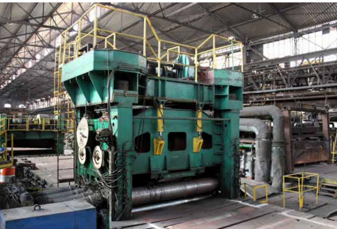
Powyżej: wykańczalnia blach – fragment chłodni oraz jedna z prostownic, 2023 rok, fot. Paweł Suder. Poniżej: prostownice do blach, 2023 rok, fot. Piotr Rygus.
