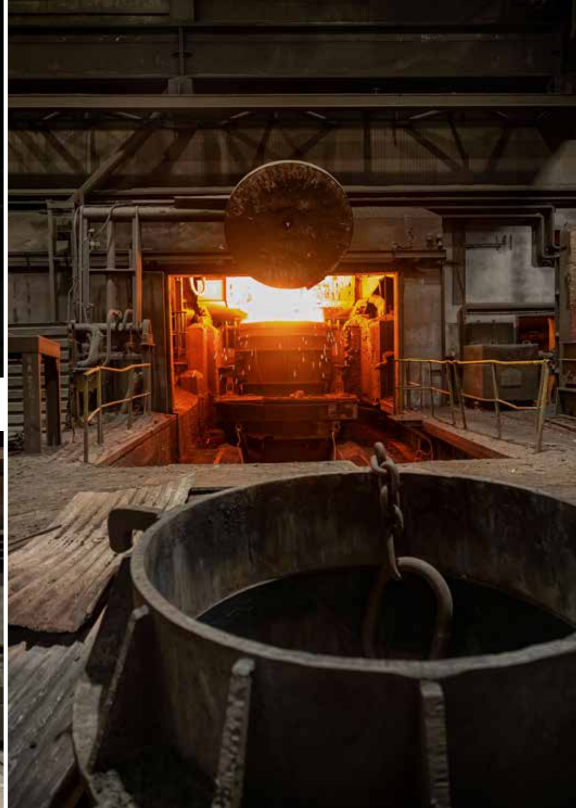
Powyżej: spust stali, 2023 rok, fot. Aleksandra Rygus; Poniżej: kadź z płynną stalą oczekująca na przyjazd suwnicy, 2023 rok, fot. Aleksandra Rygus; Po prawej: spust stali, 2023 rok, fot. Bernadeta Maksysz.
