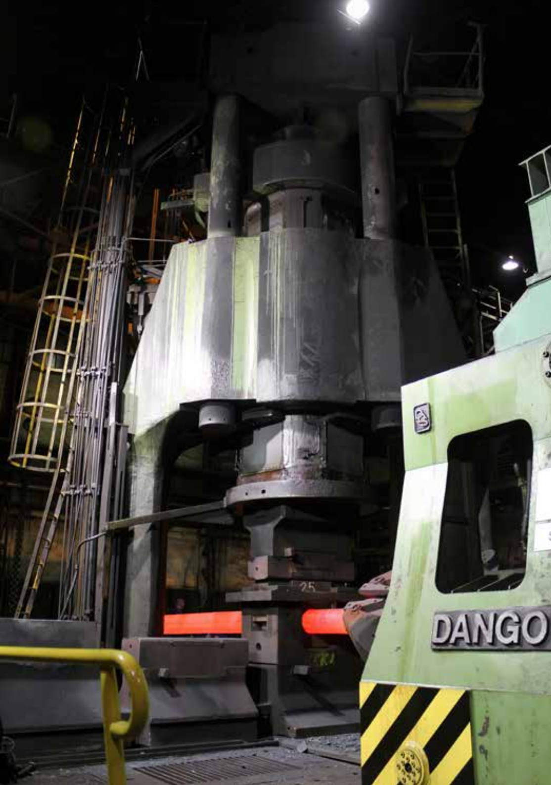
Po lewej: widok na prasę w trakcie kucia od strony kabiny sterowniczej, 2023 rok, fot. Piotr Rygus. Powyżej: kucie przy użyciu prasy 2000 t, 2023 rok, fot. Bernadeta Maksysz. Na dole: zakończenie kucia i przygotowanie gotowej odkuwki do transportu, fot. 2023 rok, fot. Bernadeta Maksysz.
