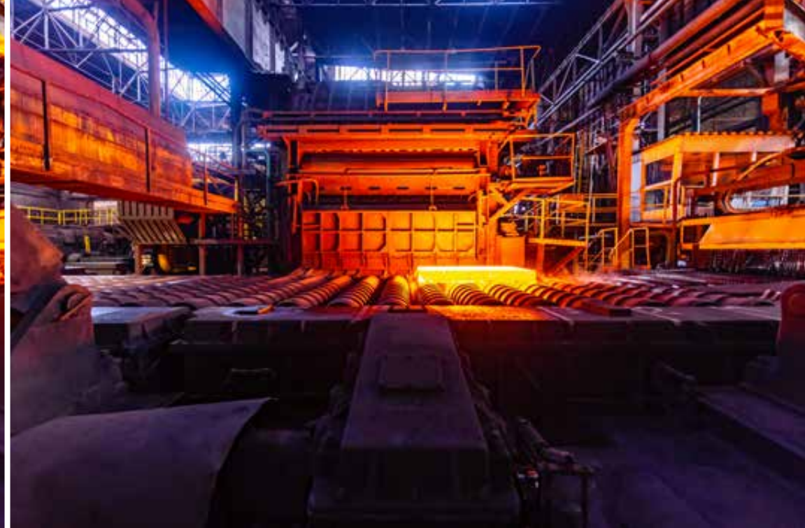
Transport rozgrzanego wlewka samotokiem w kierunku walcarki quarto, 2023 rok, fot. Paweł Suder.
