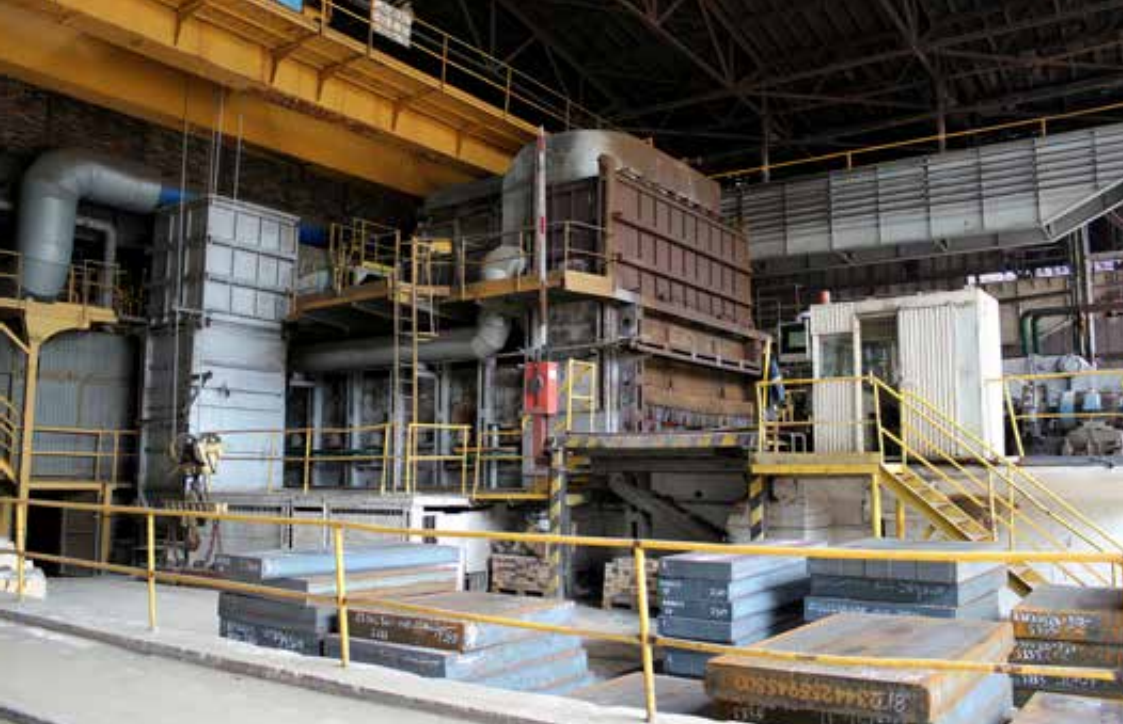
Powyżej: widok ogólny na piec przepychowy do nagrzewania wsadu w walcowni blach grubych. 2023 rok, fot. Piotr Rygus. Poniżej: kłapa wsadowa pieca przepychowego, 2023 rok, fot. Aleksandra Rygus.
