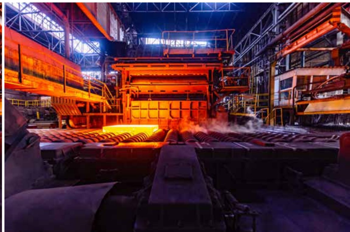
Transport rozgrzanego wlewka samotokiem w kierunku walcarki quarto, 2023 rok, fot. Paweł Suder.
