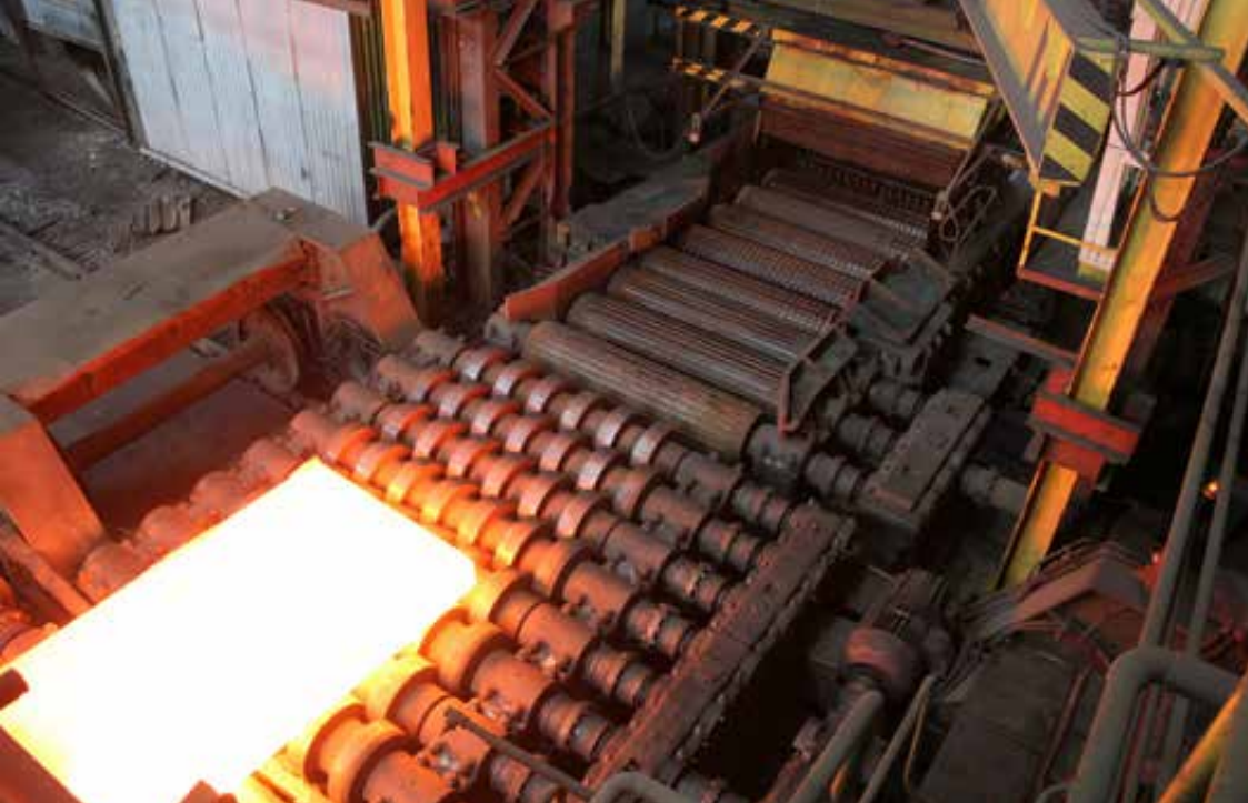
Powyżej: widok z góry pieca przepychowego na wlewk kierujący się samotkiem w kierunku walcarki, 2023 rok, fot. Aleksandra Rygus. Poniżej: widok na samotok w kierunku hali pieców od strony odzędrowacza, 2023 rok, fot. Paweł Suder.
