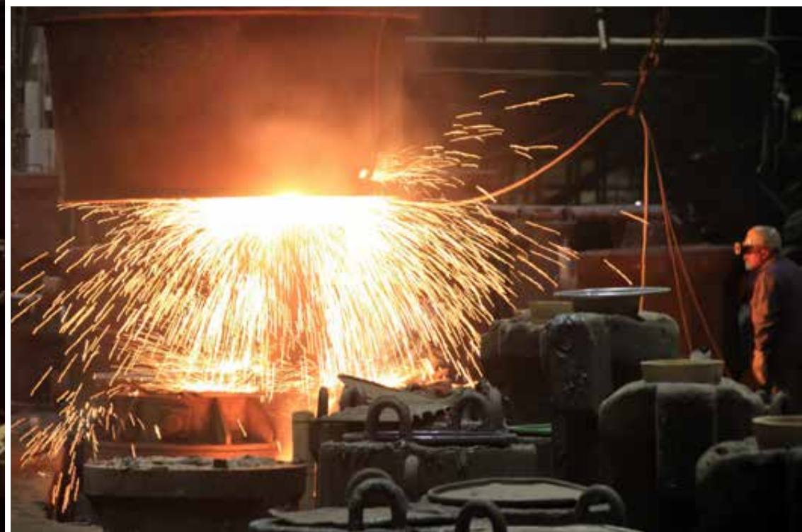
Spust stali z kadzi do wlewnic, 2023 rok. Po lewej: fot. Bernadeta Maksysz. Powyżej i poniżej: fot. Aleksandra Rygus.
