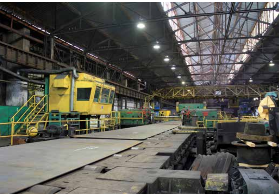
Nożyca krążkowa do obcinania bocznych krawędzi blach, 2023 rok. Powyżej: fot. Aleksandra Rygus, poniżej: fot. Piotr Rygus.
