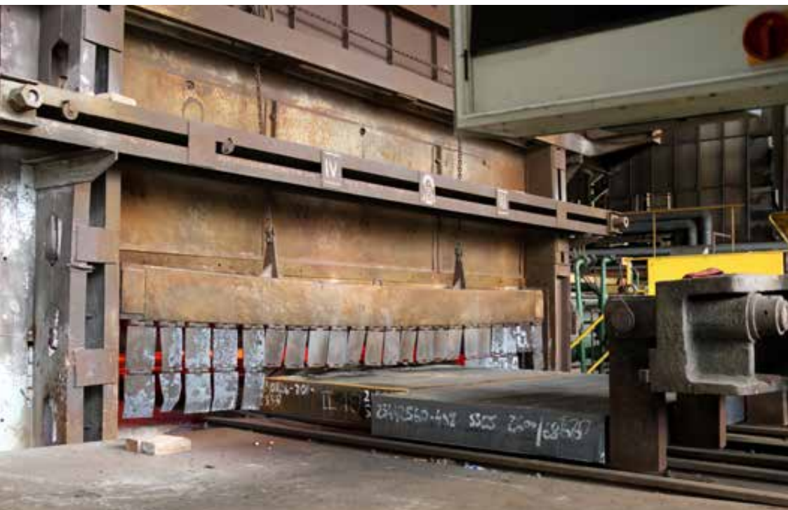
Powyżej: widok ogólny na piec przepychowy do nagrzewania wsadu w walcowni blach grubych. 2023 rok, fot. Piotr Rygus. Poniżej: kłapa wsadowa pieca przepychowego, 2023 rok, fot. Aleksandra Rygus.
