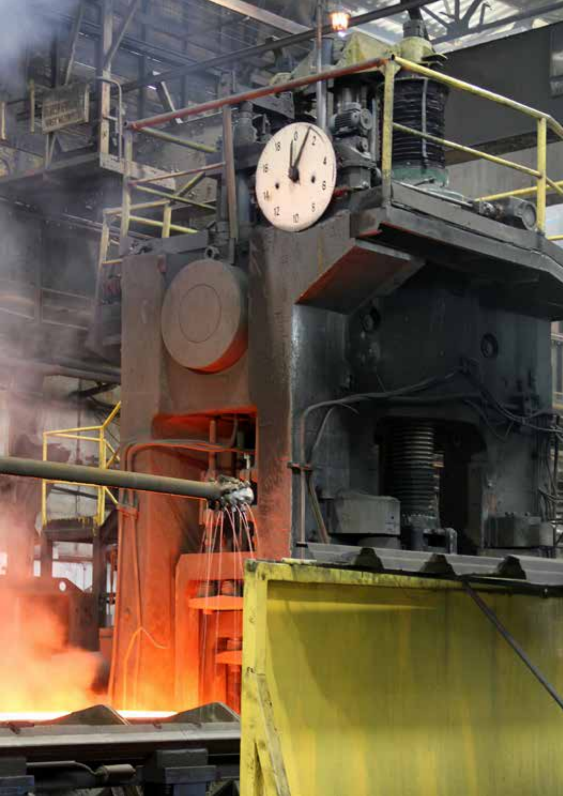
Powyżej: walcarka pielgrzymowa w walcowni rur, 2023 rok, fot. Bernadeta Maksysz. Poniżej: odznedrowacz przy walcarce pielgrzymowej wypływający wnętrze tulei przed walcowaniem, 2023 rok, fot. Bernadeta Maksysz. Po lewej: widok na stojak walcarki pielgrzymowej od strony odznedrowacza, 2023 rok, fot. Aleksandra Rygus.
