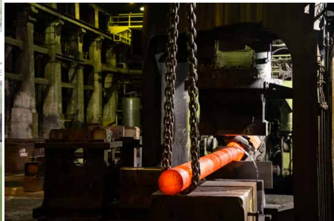
Po lewej: widok na prasę w trakcie kucia od strony kabiny sterowniczej, 2023 rok, fot. Piotr Rygus. Powyżej: kucie przy użyciu prasy 2000 t, 2023 rok, fot. Bernadeta Maksysz. Na dole: zakończenie kucia i przygotowanie gotowej odkuwki do transportu, fot. 2023 rok, fot. Bernadeta Maksysz.
