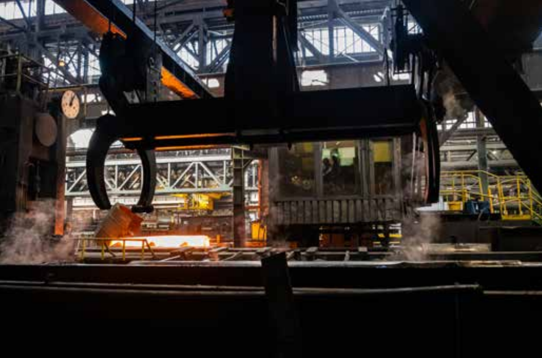
Powyżej: widok na obieg trzpieni od strony wanny grafitowej, 2023 rok, fot. Bernadeta Maksysz. Poniżej: dźwig z trzpieniem przygotowanym do walcowania, 2023 rok, fot. Bernadeta Maksysz. Po prawej: przygotowywanie trzpienia do walcowania, 2023 rok, fot. Aleksandra Rygus.
