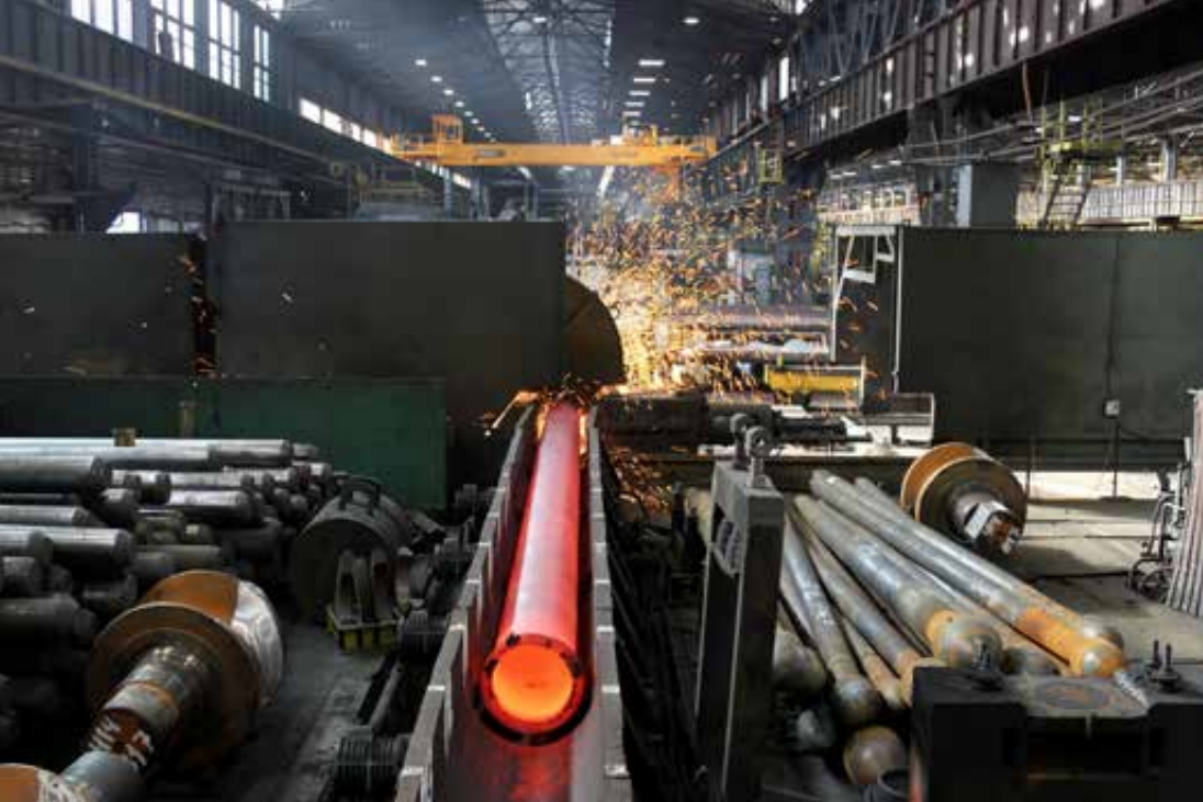
Powyżej: piła saniowa do cięcia rur na gorąco, 2023 rok, fot. Piotr Rygus. Poniżej: fragment hali szóstej w rejonie piły. Na zdjęciu widoczna m.in. górna wbudówka walcarki pielgrzymowej oraz osprzęt dla walcarek pielgrzymowej i skośnej, 2023 rok. Fot. Aleksandra Rygus.
