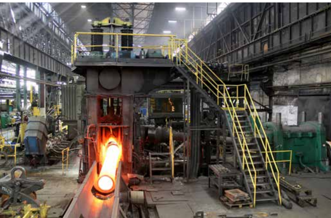
Powyżej: widok na stojak walcarki pielgrzymowej od strony obiegu trzpieni. Moment przed podaniem tulei do walcowania, 2023 rok, fot. Piotr Rygus. Poniżej: widok na stojak walcarki pielgrzymowej od strony piły, 2023 rok, fot. Aleksandra Rygus. Po prawej: widok na walcarkę pielgrzymową w trakcie walcowania od strony przekładni głównej, 2023 rok, fot. Piotr Rygus.
